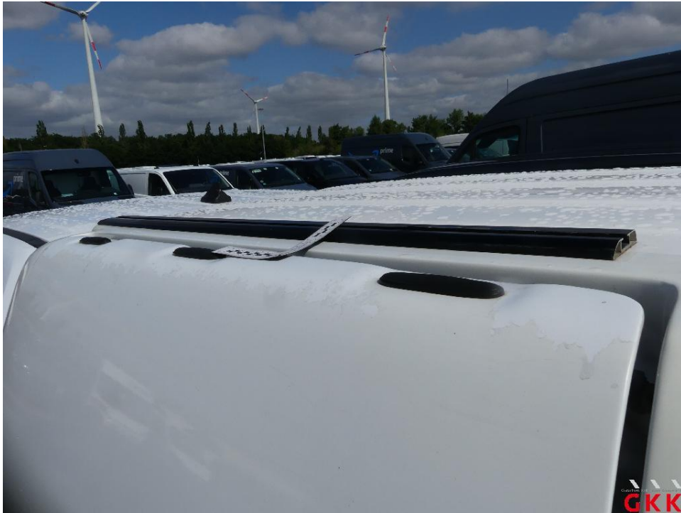
Bild 23. Seitenwand rechts, Lackierung abgeplatzt, lackieren
