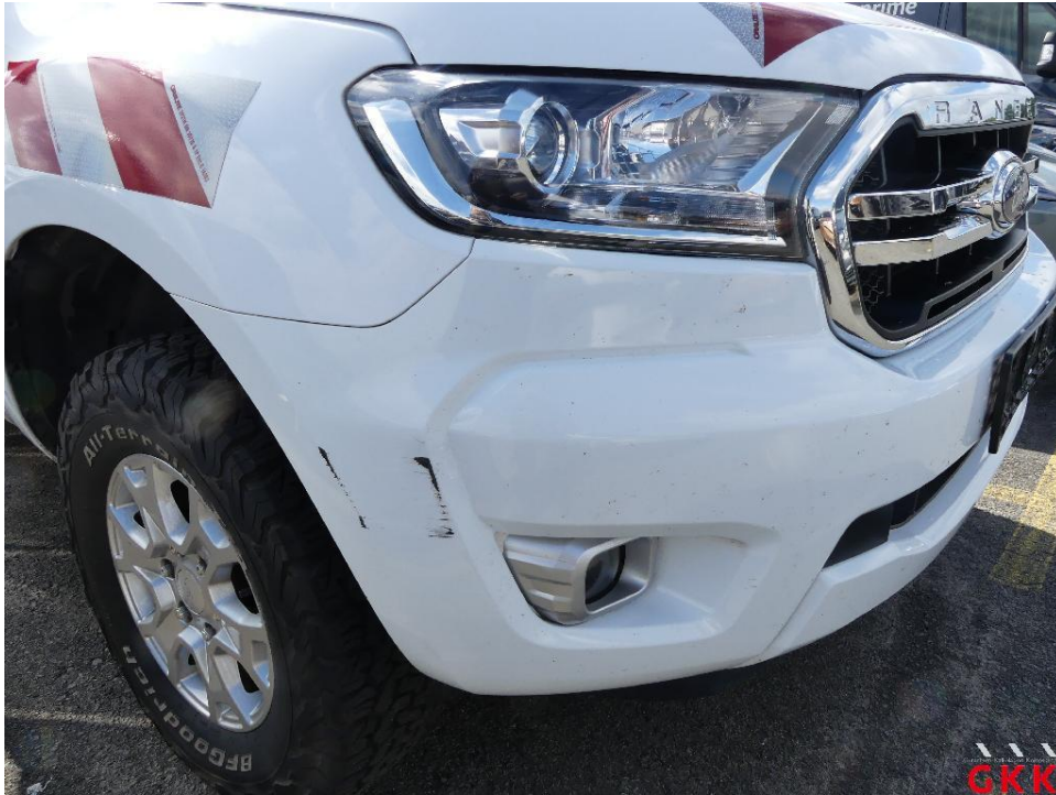
Bild 17. Stoßfänger vorne, Verkleidung -lackiert-, verkratzt, lackieren
