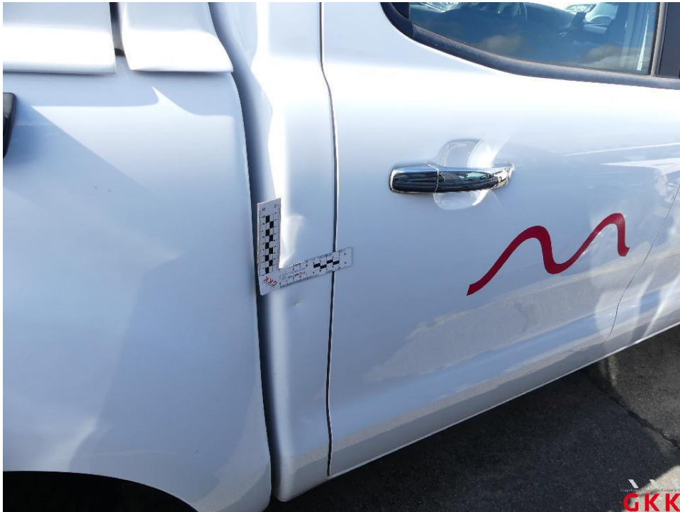
Bild 20. B- Säule rechts, beschädigt, instand setzen - lackieren
