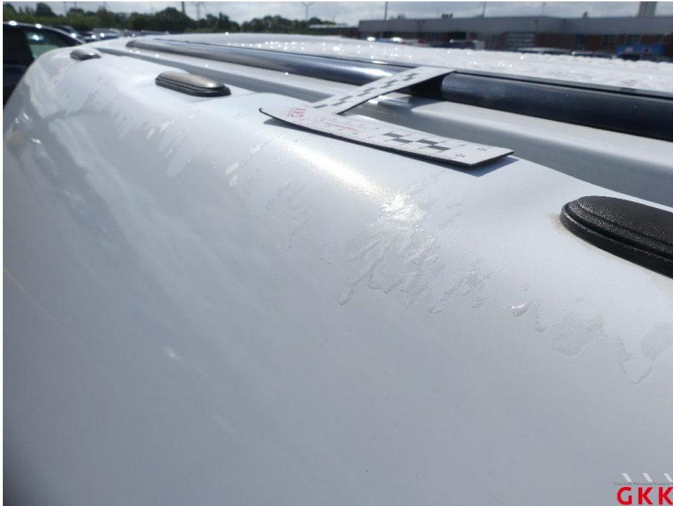
Bild 27. Seitenwand links, Lackierung abgeplatzt, lackieren
