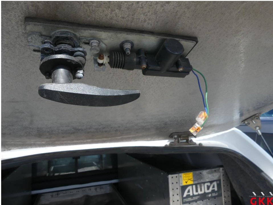
Bild 36. Heckklappe - elektrischer Öffner - Kabel abgeklemmt, funktionsuntüchtig, prüfen
