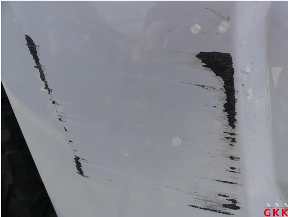
Bild 19. Stoßfänger vorne, Verkleidung -lackiert-, verkratzt, lackieren
