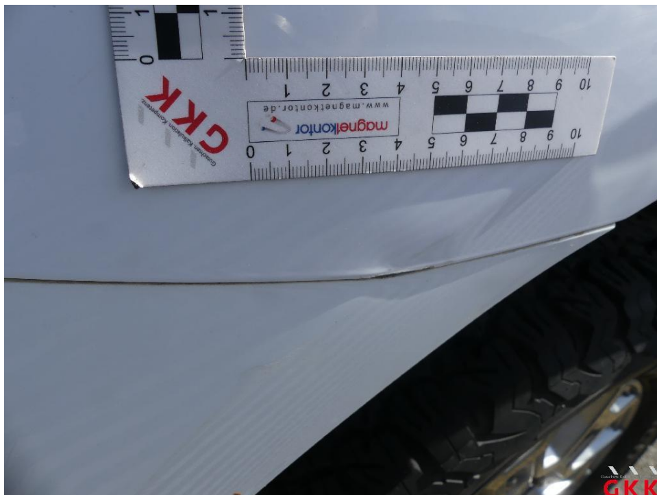
Bild 15. Kotflügel vorne links, beschädigt, instand setzen - lackieren
