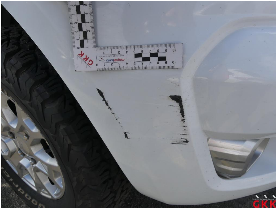
Bild 18. Stoßfänger vorne, Verkleidung -lackiert-, verkratzt, lackieren
