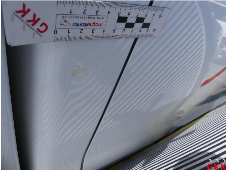
Bild 21. B- Säule rechts, beschädigt, instand setzen - lackieren
