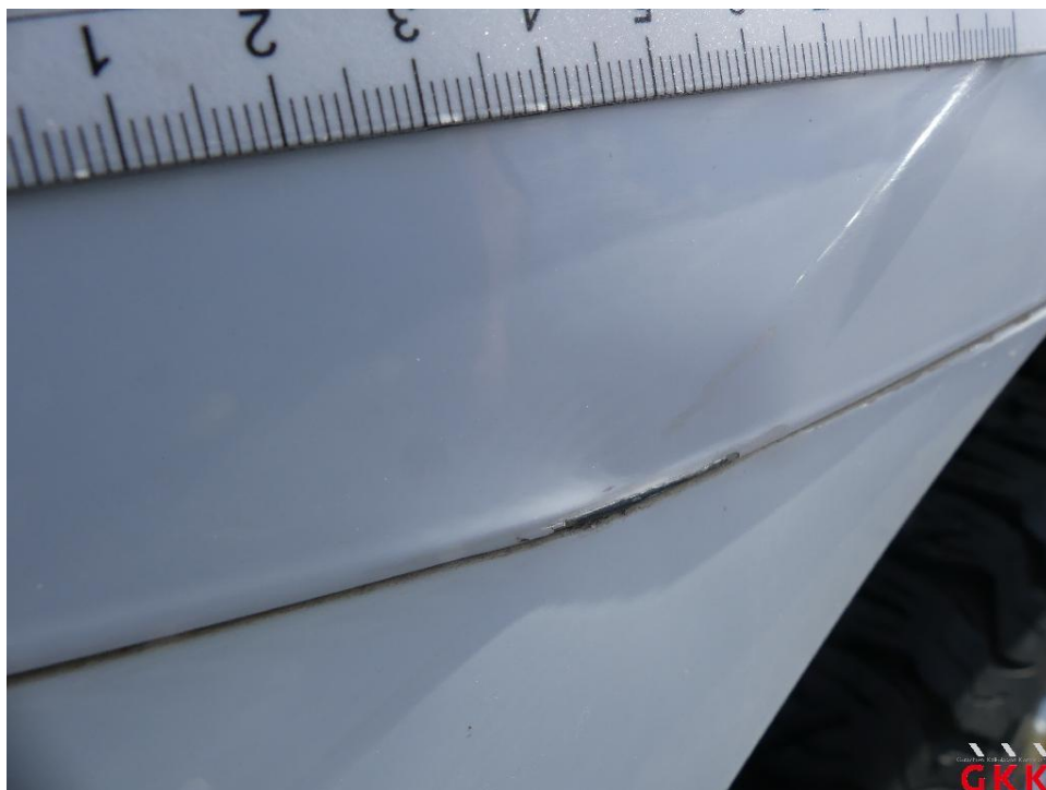
Bild 16. Kotflügel vorne links, beschädigt, instand setzen - lackieren
