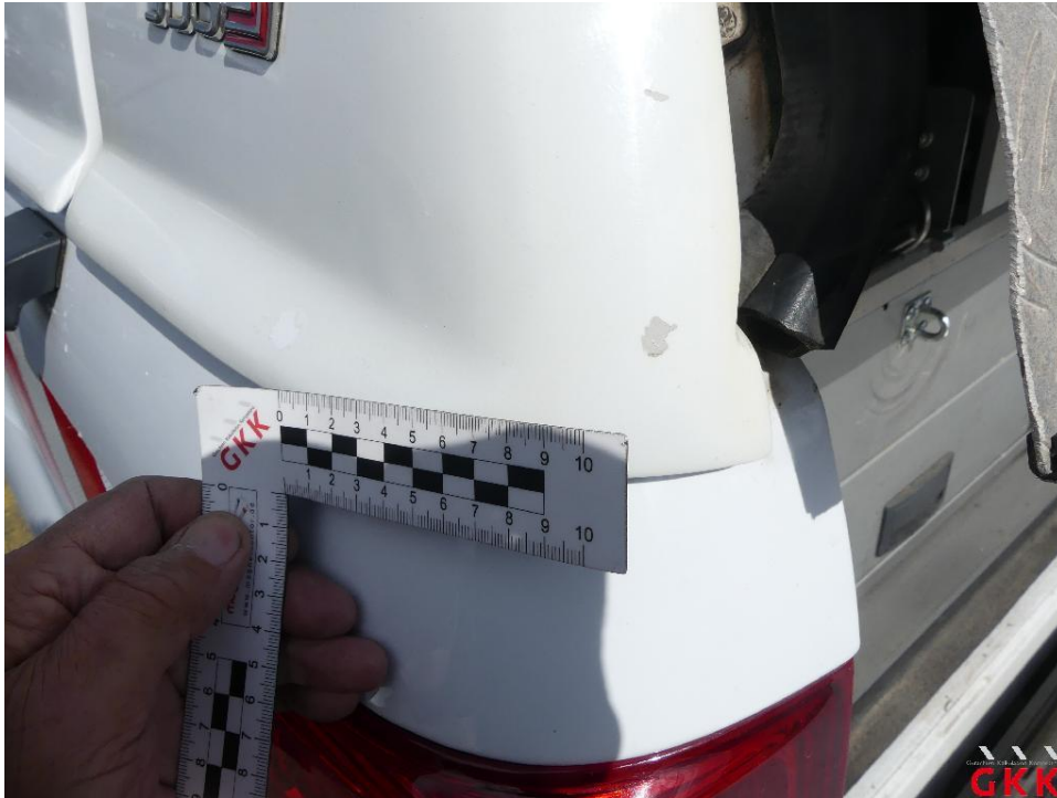
Bild 33. Dach, hinten, verkratzt, lackieren
