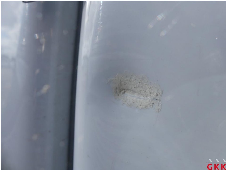
Bild 22. B- Säule rechts, beschädigt, instand setzen - lackieren
