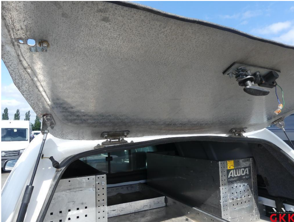
Bild 34. Heckklappe - elektrischer Öffner - Kabel abgeklemmt, funktionsuntüchtig, prüfen
