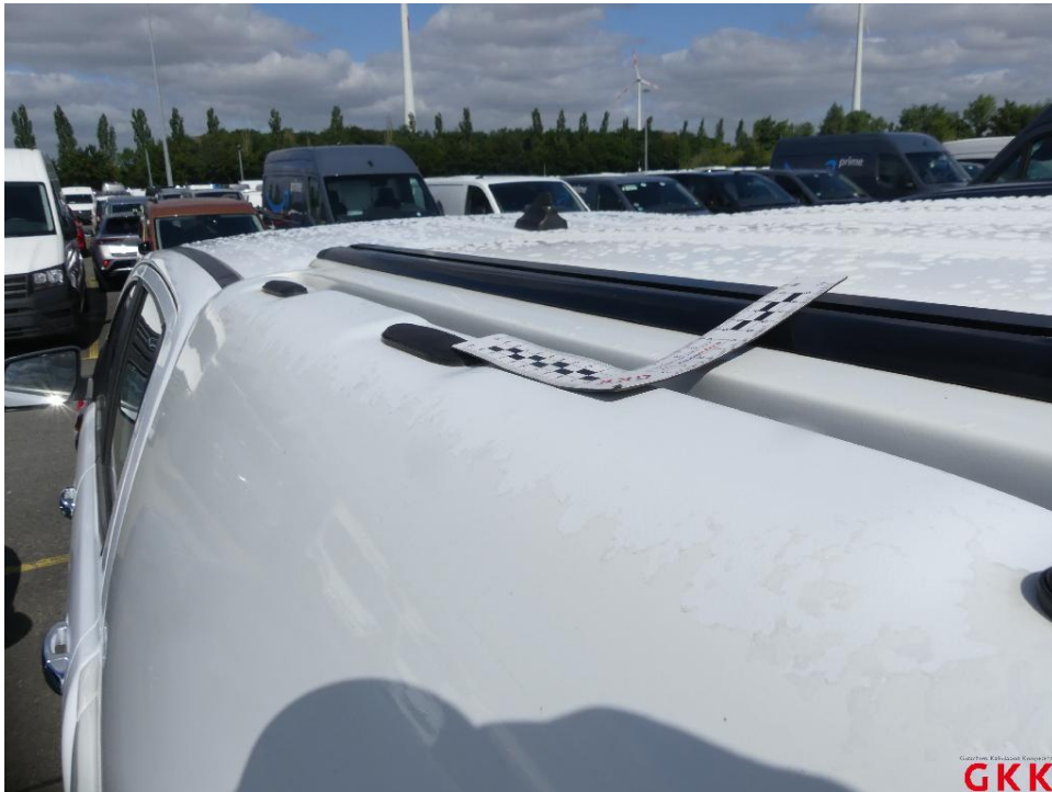
Bild 24. Seitenwand rechts, Lackierung abgeplatzt, lackieren
