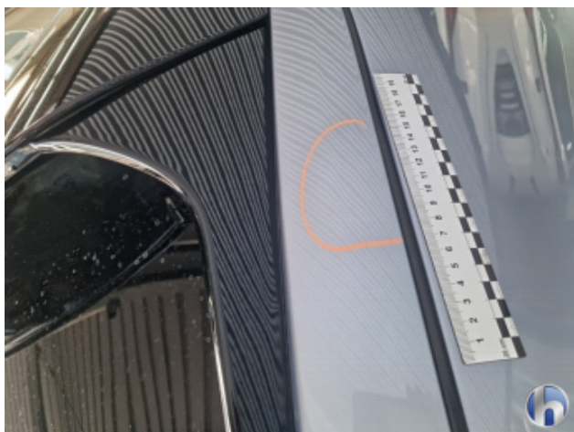
2. Heckklappe Delle - Sanft Instandsetzen
