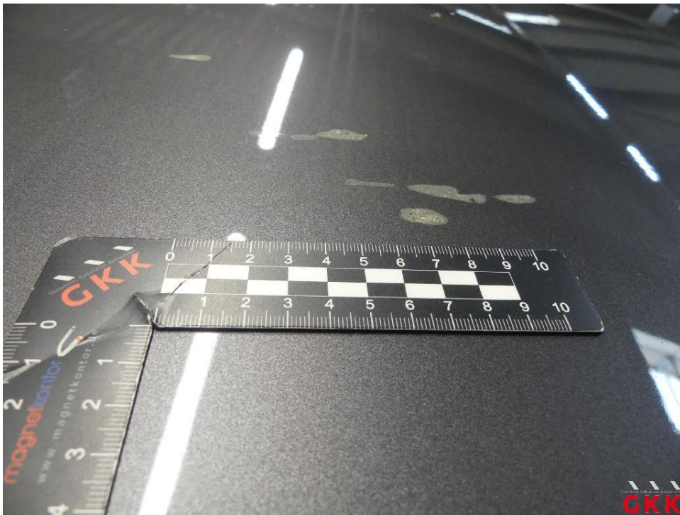
Bild 20 Dach, Harzhaftungen/-rückstände, reinigen
