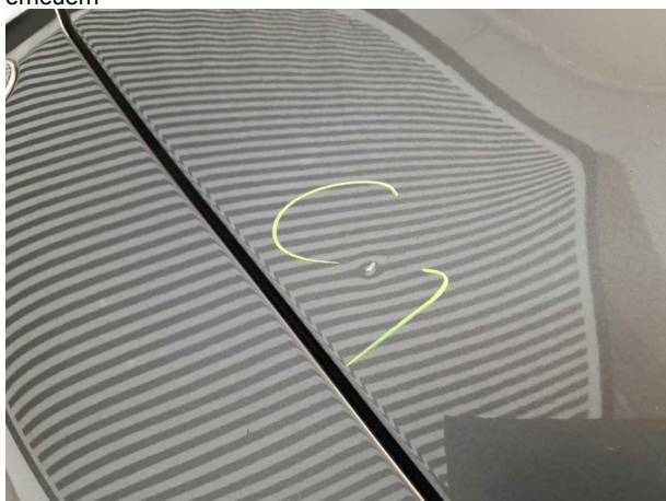
Beschädigung #5: Motorhaube: Motorhaube - Delle / Lackschad... - instandsetzen und lackieren
