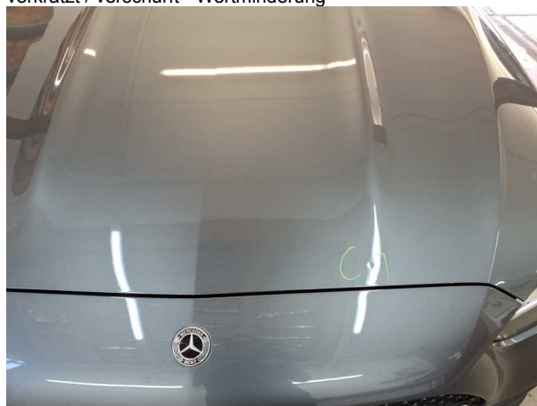
Beschädigung #5: Motorhaube: Motorhaube - Delle / Lackschaden - instandsetzen und lackieren
