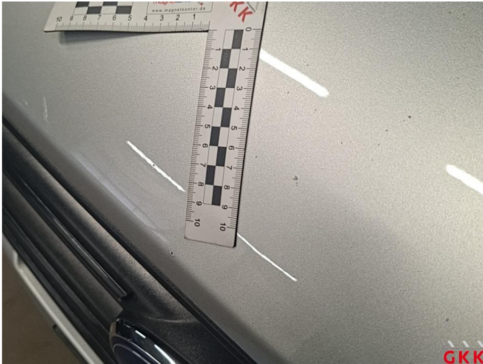
Bild 21 Motorhaube, Steinschlag, lackieren
