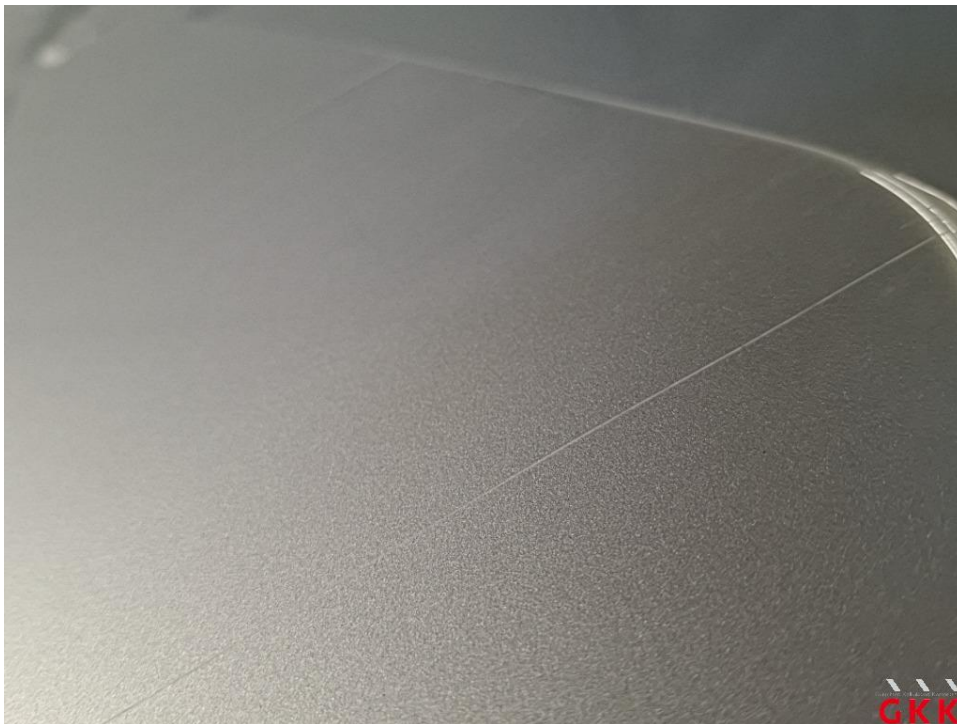
Bild 42 Dach, beschädigt, instand setzen - lackieren
