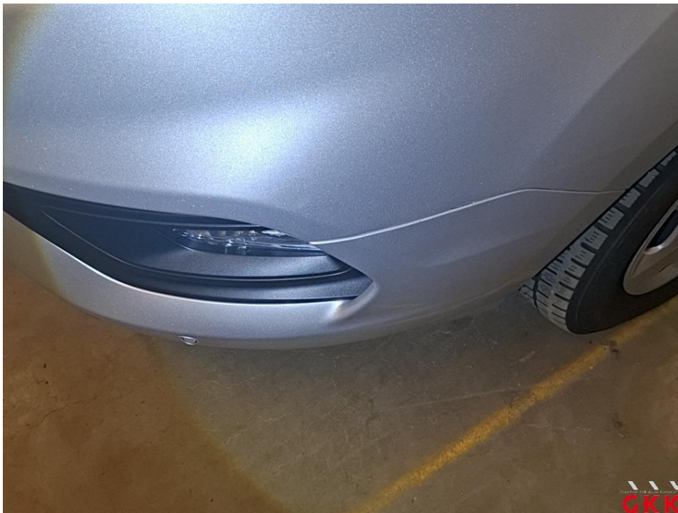
Bild 24 Stoßfänger vorne, Verkleidung oberhalb -lackiert-, verkratzt, lackieren
