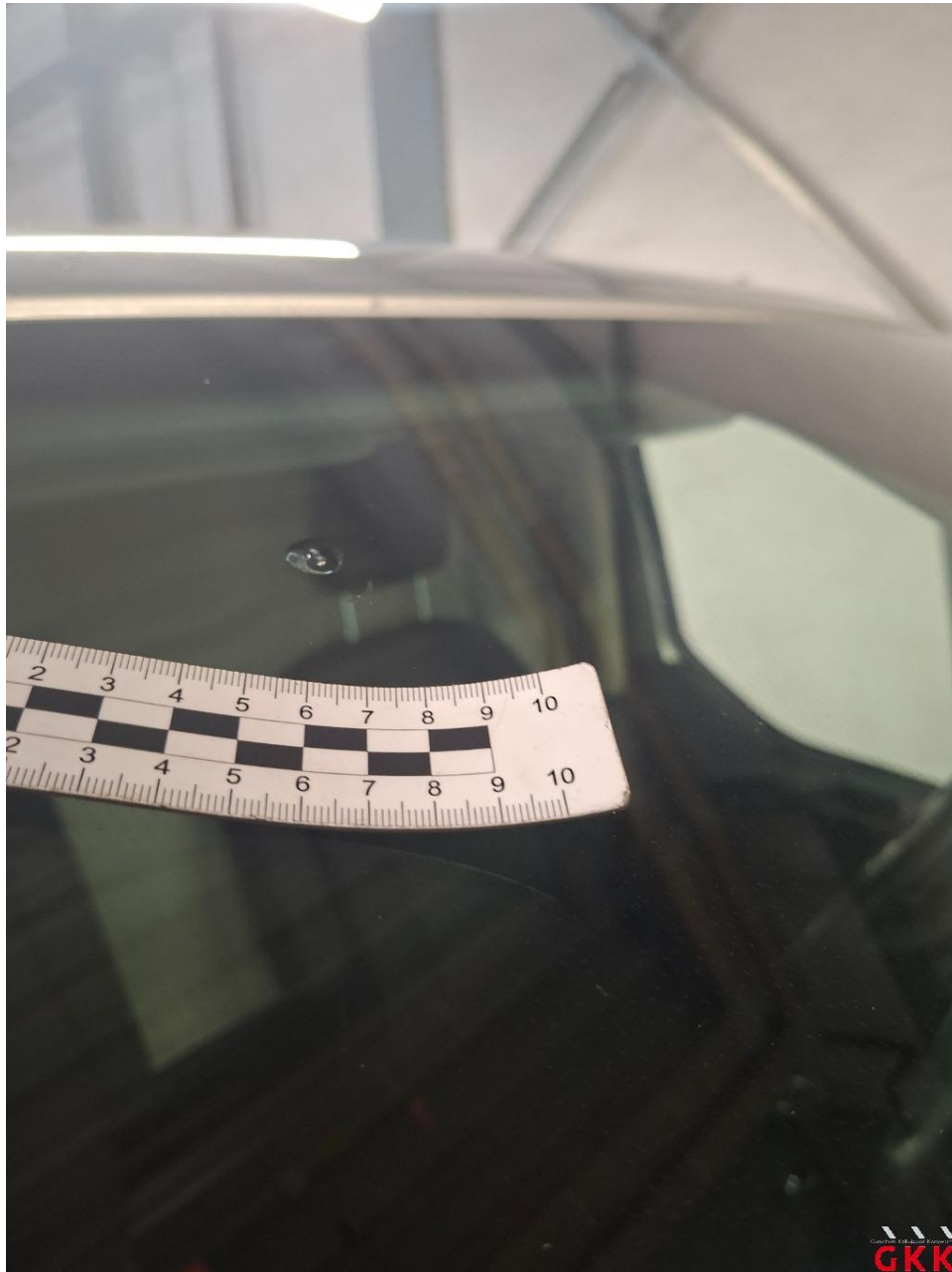
Bild 18 Frontscheibe, beheizt mit Regensensor und Frontkamera, Steinschlag mit Rissbildung, ersetzen
