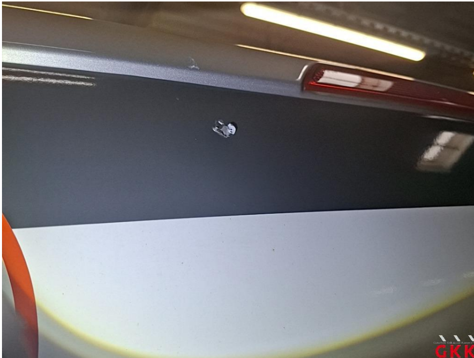
Bild 35 Heckklappe, beschädigt, instand setzen - lackieren
