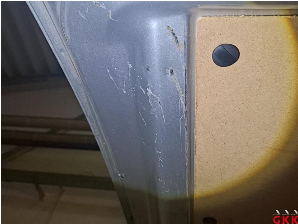
Bild 29 Heckklappe, innen, beschädigt, Smartrepair
