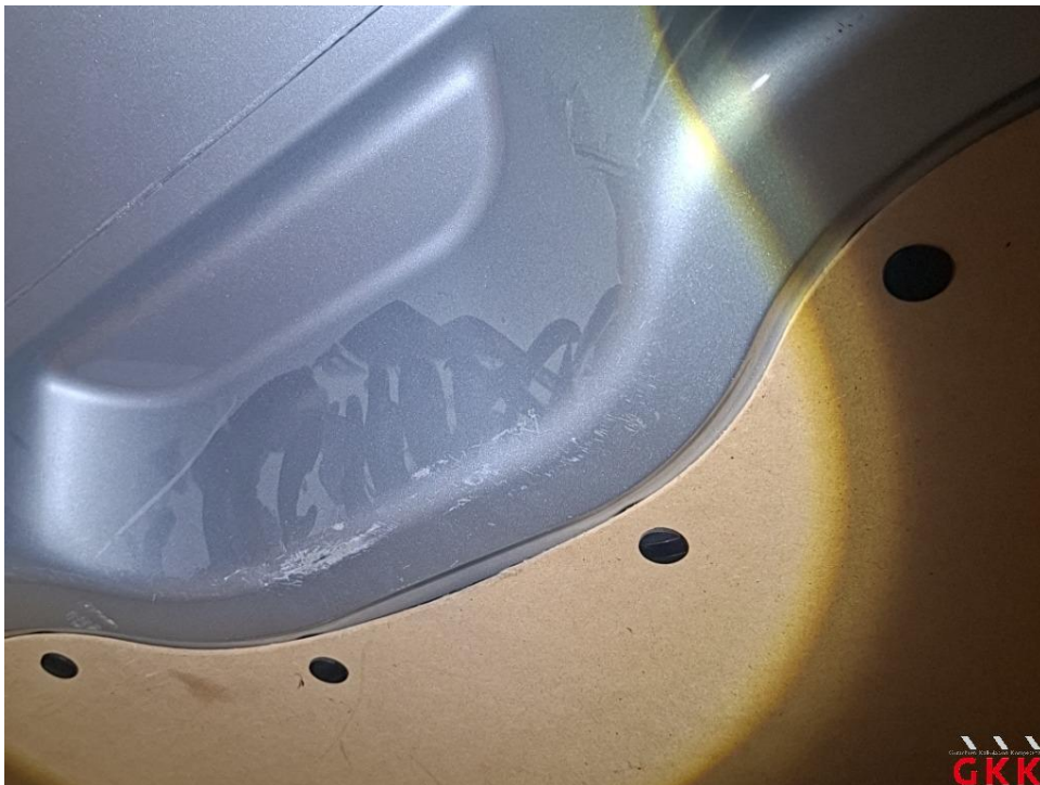
Bild 30 Heckklappe, innen, beschädigt, Smartrepair
