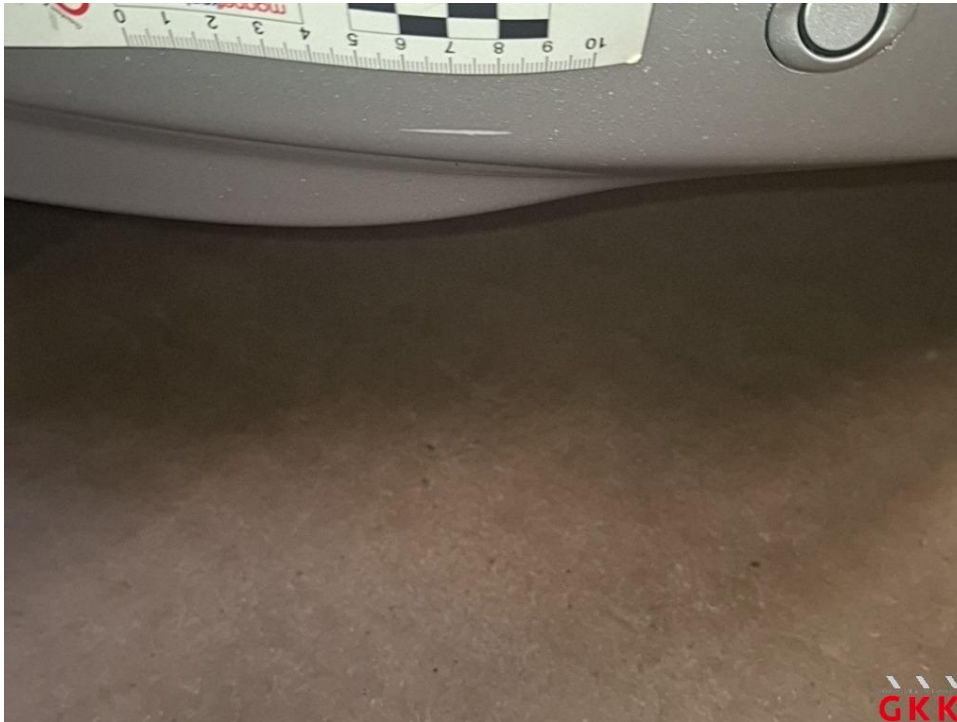
Bild 43 Stoßfänger vorne, Verkleidung unterhalb -lackiert-, verkratzt, lackieren
