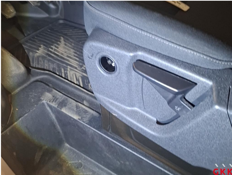
Bild 27 Sitz vorne links, Sitzverstellung, fehlt, ersetzen
