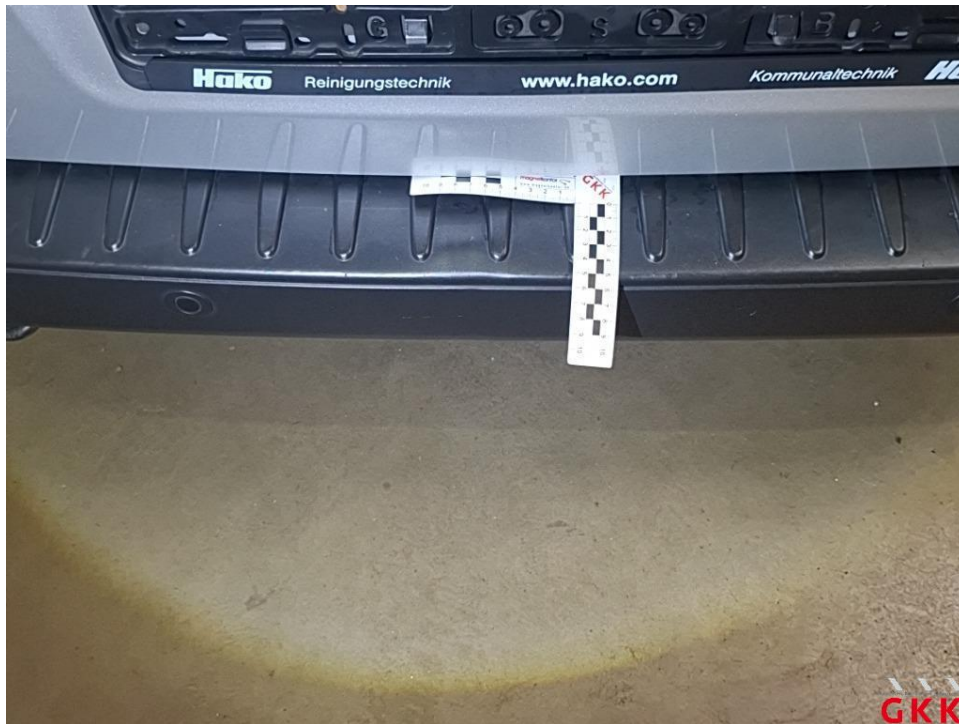
Bild 37 Stoßfänger hinten, Verkleidung -unlackiert-, beschädigt, ersetzen
