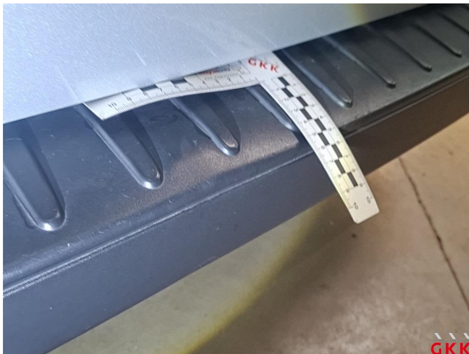
Bild 38 Stoßfänger hinten, Verkleidung -unlackiert-, beschädigt, ersetzen
