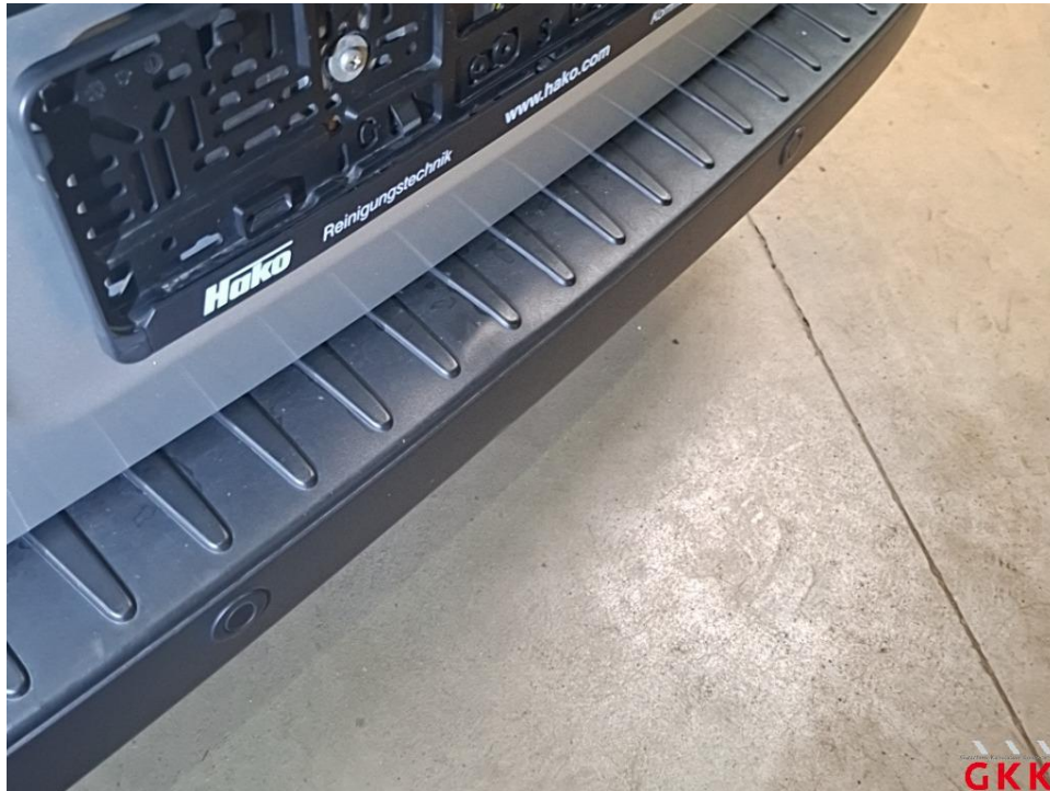
Bild 39 Stoßfänger hinten, Verkleidung -unlackiert-, beschädigt, ersetzen
