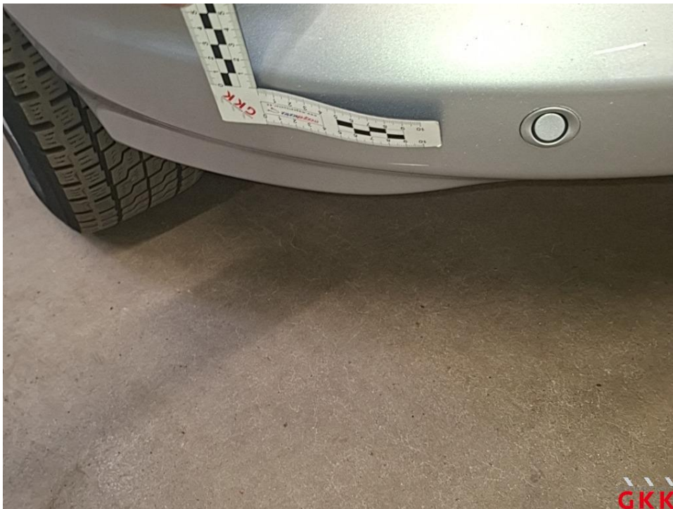
Bild 44 Stoßfänger vorne, Verkleidung unterhalb -lackiert-, verkratzt, lackieren
