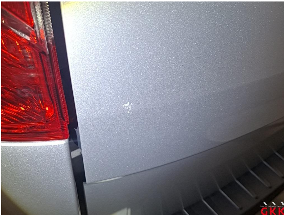
Bild 36 Heckklappe, beschädigt, instand setzen - lackieren
