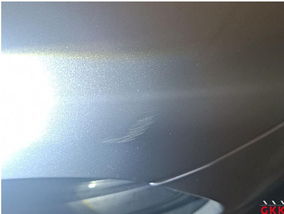
Bild 26 Stoßfänger vorne, Verkleidung oberhalb -lackiert-, verkratzt, lackieren
