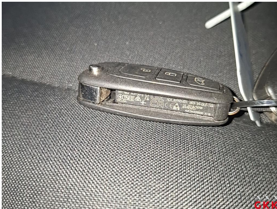
Bild 14 Hauptschlüssel, mit Fernbedienung, beschädigt, ersetzen
