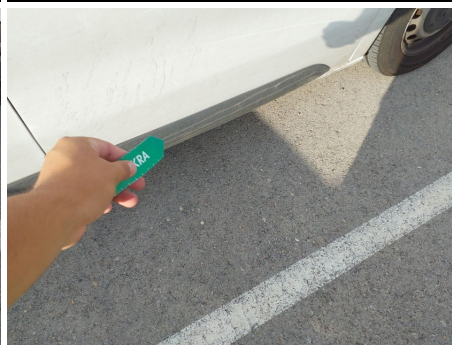
Moldura de puerta / Delantero Derecho / Roto
