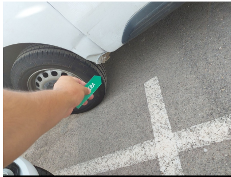
Estribo / Derecha / Abolladura
