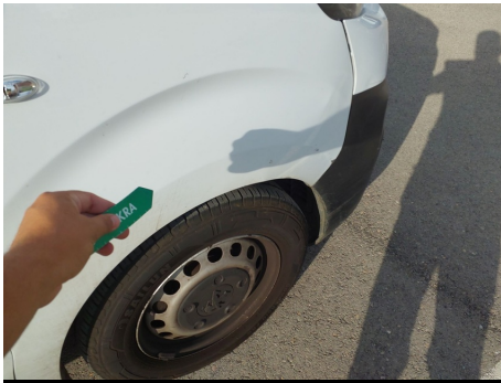
Aleta / Delantero Derecho / Abolladura
