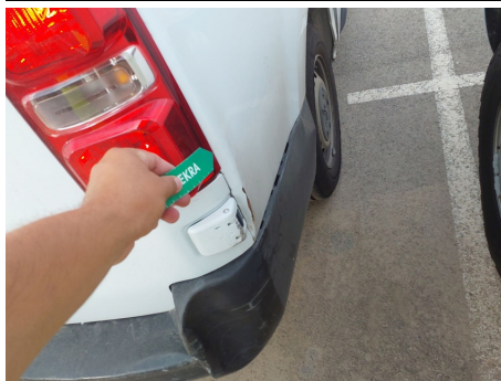
Aleta / Trasero Derecho / Abolladura
