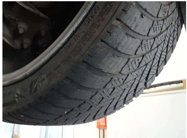
Beschädigung #4: Rad/Reifen: Reifen vorn (Einseitig) - verschlissen - erneuern
