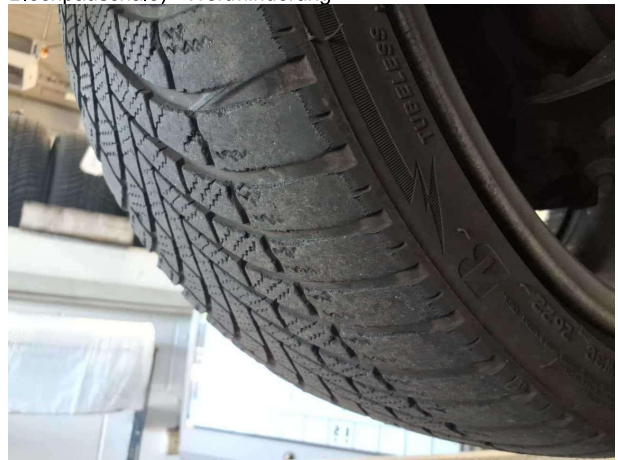
Beschädigung #4: Rad/Reifen: Reifen vorn (Einseitig) - verschlissen - erneuern
