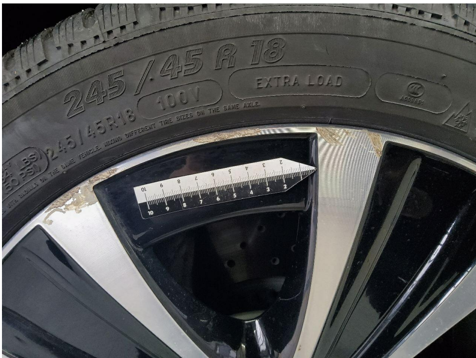
Bild 8 : Glanzgedrehte Winterfelge vorne rechts, zerkratzt mit Materialabtrag
