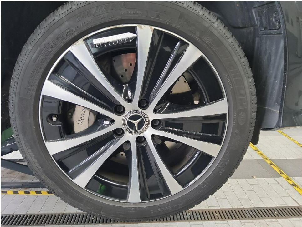
Bild 7 : Glanzgedrehte Winterfelge vorne rechts, zerkratzt mit Materialabtrag
