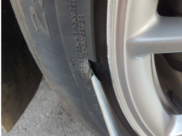
Beschädigung #1: Rad/Reifen: Reifen vorn rechts - beschädigt - erneuern
