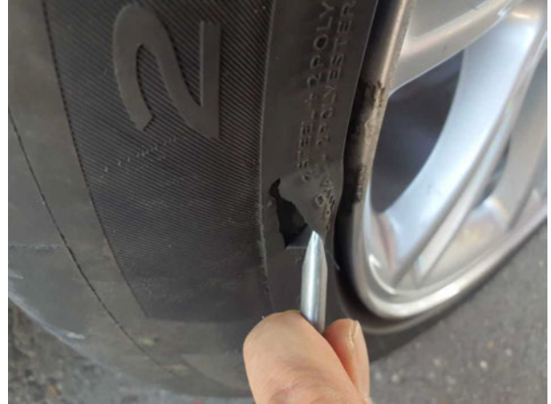
Beschädigung #1: Rad/Reifen: Reifen vorn rechts - beschädigt - erneuern
