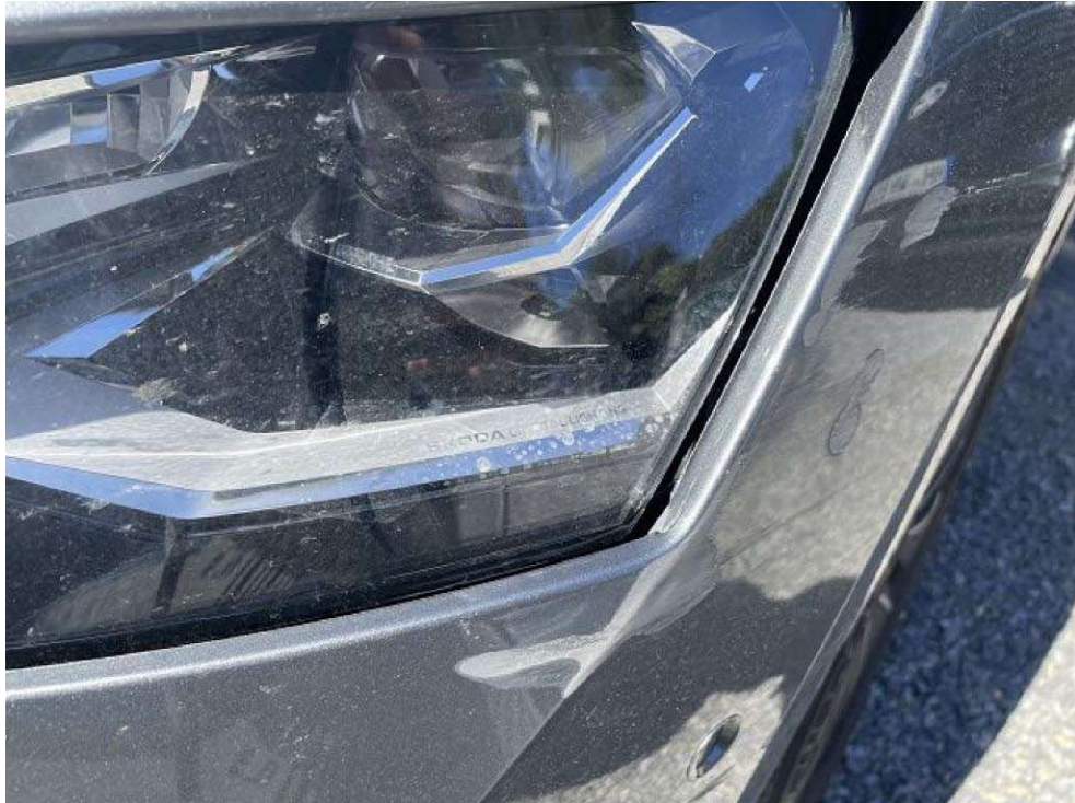
Bild 8 Scheinwerfer links beschädigt
