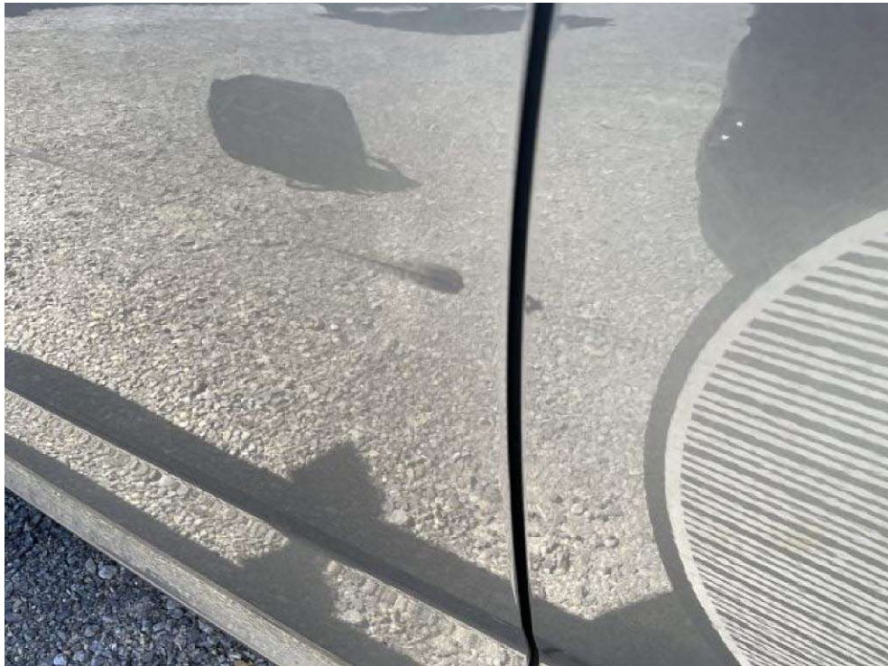
Bild 17 Tür hinten links verformt
