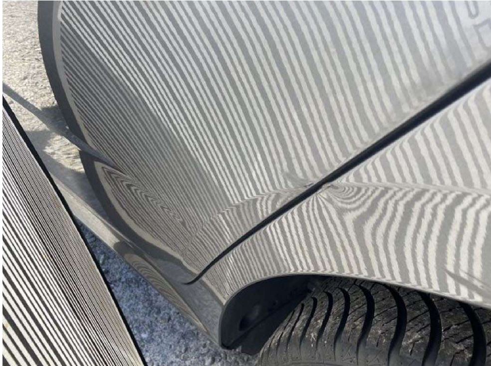
Bild 16 Tür hinten links verformt
