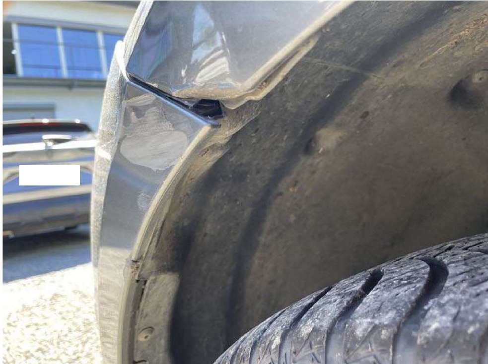
Bild 12 Radhausschale vorne links beschädigt
