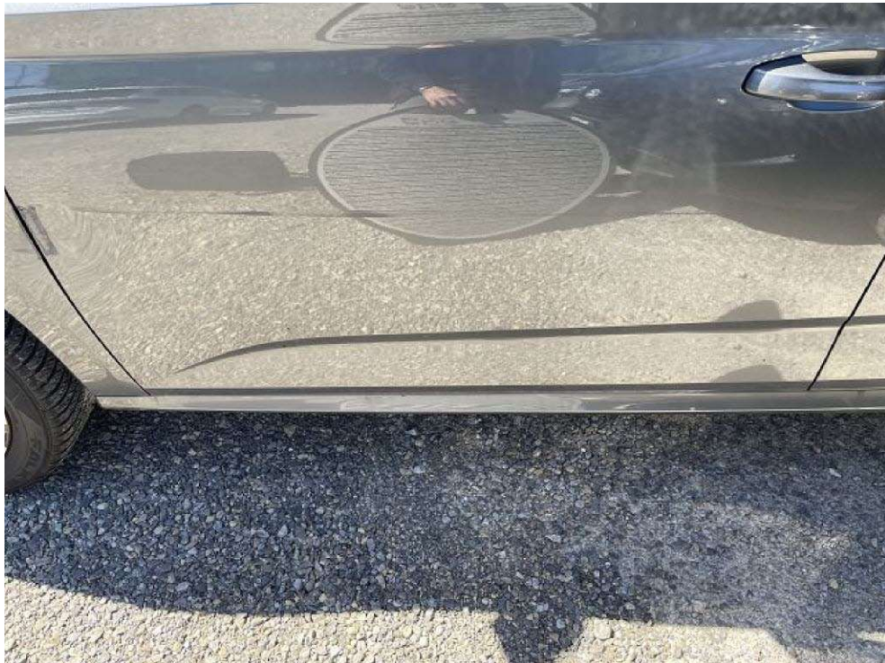
Bild 15 Tür vorne links verformt
