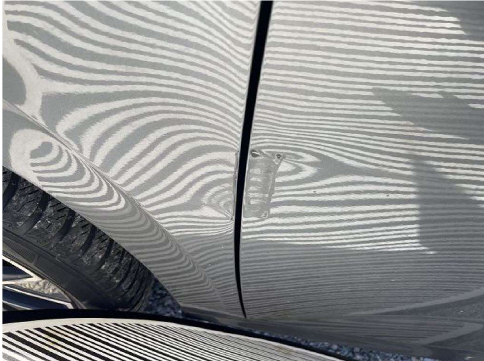
Bild 14 Tür vorne links verformt
