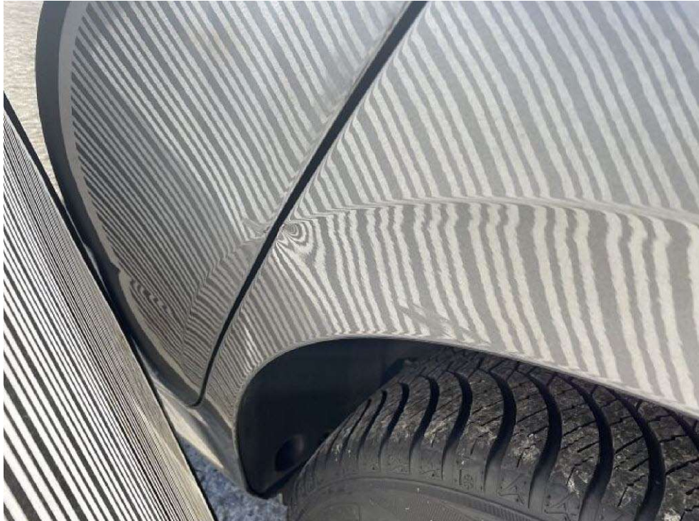
Bild 18 Seitenwand links verformt
