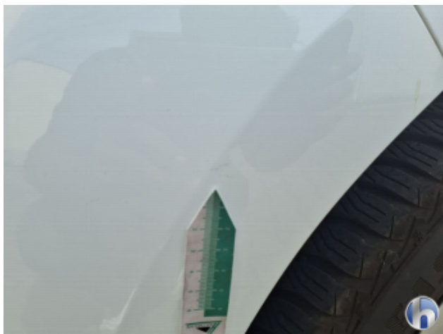
2. Stoßfänger Vorne Kratzer - Lackieren
