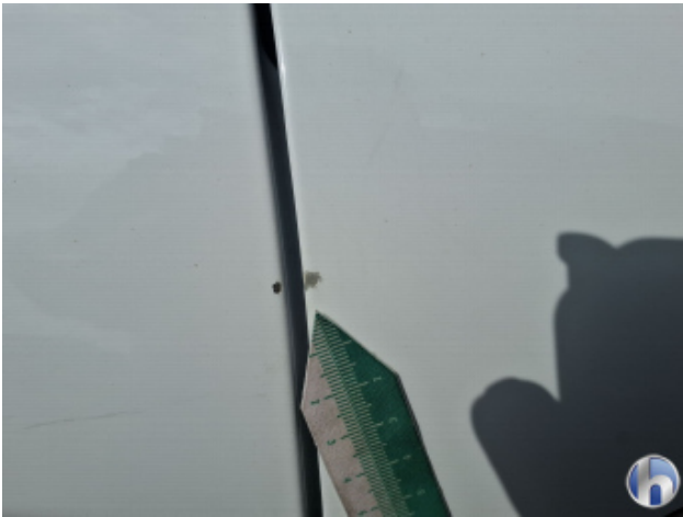
3. Tür Vorne - Rechts Kratzer - Smart Repair
