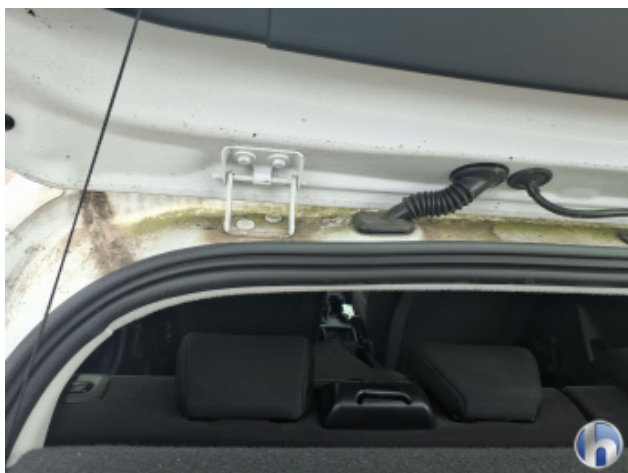
7. Verkleidung Verschmutzt - Reinigen
