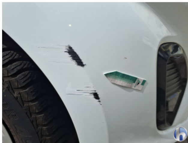
2. Stoßfänger Vorne Kratzer - Lackieren
