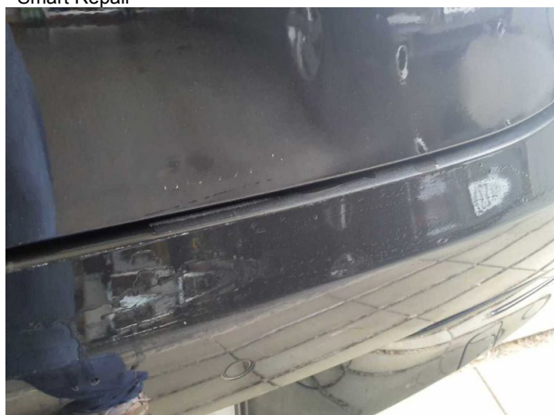
Beschädigung 2: Heckklappe/-tür: Heckklappe - Kratzer - Smart Repair
