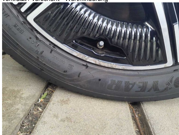
Beschädigung 3: Rad/Reifen: Leichtmetallfelge hinten recht... verkratzt / verschürft - Wertminderung
