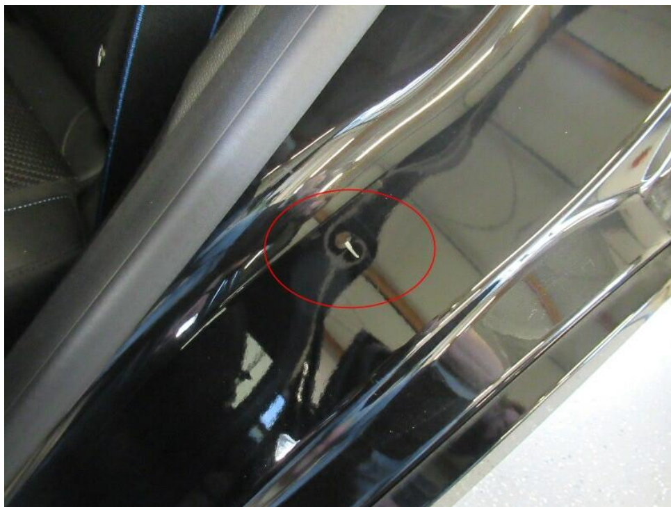
Bild 11 : Tür hinten links Einstieg, eingedellt, instandsetzen und lackieren mit Lackaufbau
