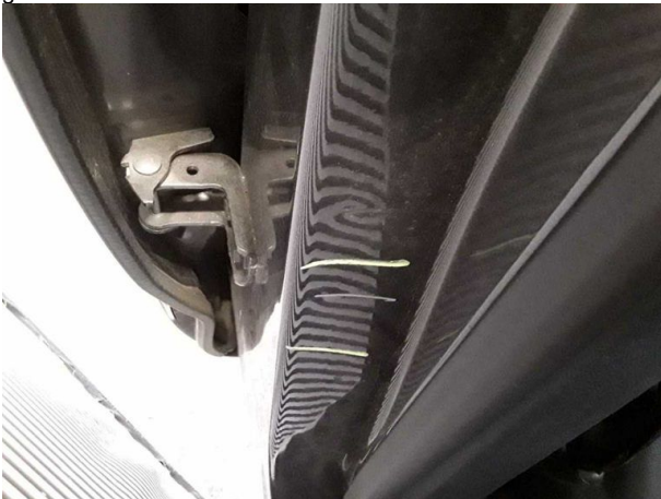
Beschädigung #5: Schweller rechts: Einstieg - verkratzt / verschürft - instandsetzen und lackieren
