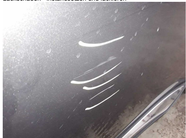
Beschädigung #11: Tür vorn rechts: Tür - verkratzt / verschürft - instandsetzen und lackieren
