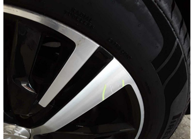
Beschädigung #1: Rad/Reifen: Leichtmetallfelge hinten links - verkratzt / verschürft - Wertminderung
