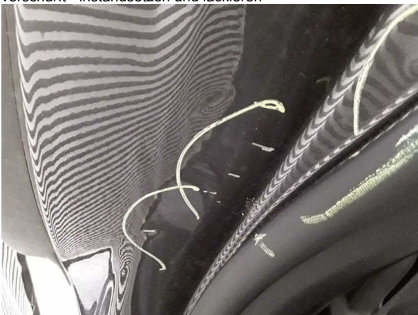
Beschädigung #6: Seitenwand rechts: Einstieg - Delle / Lackschaden - instandsetzen und lackieren
