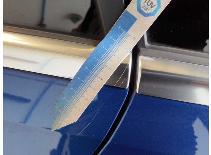
Damage 14: Door - rear left side: Door (Zusätzlich Schachtleiste Kratzer) - Scratch(es) - Paint
