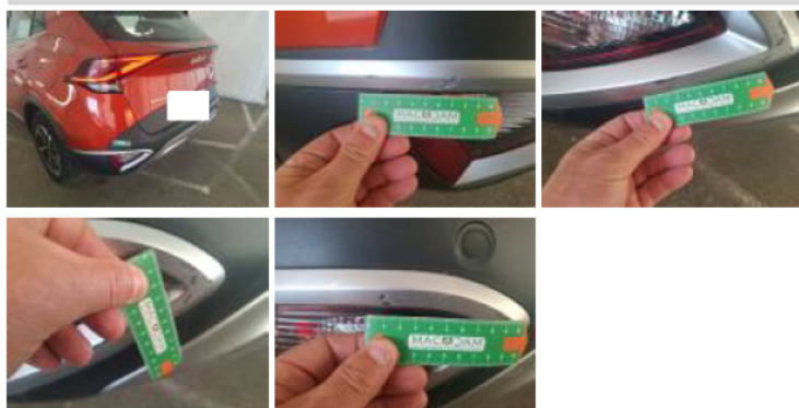
Jupe AR, Déformé / Forcé, LI - Réparer et peindre (complet)
