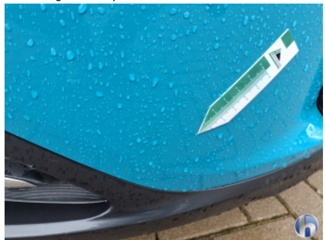
5. Stoßfänger Vorne Steinschlag - Ohne Reparatur
