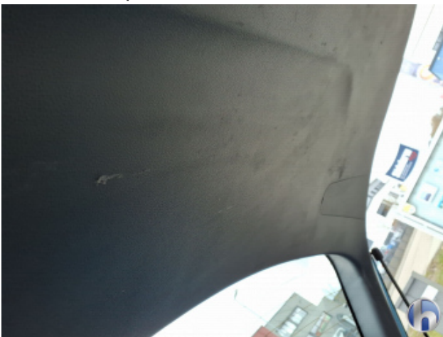
14. Heckklappenverkleidung Kratzer - Erneuern
