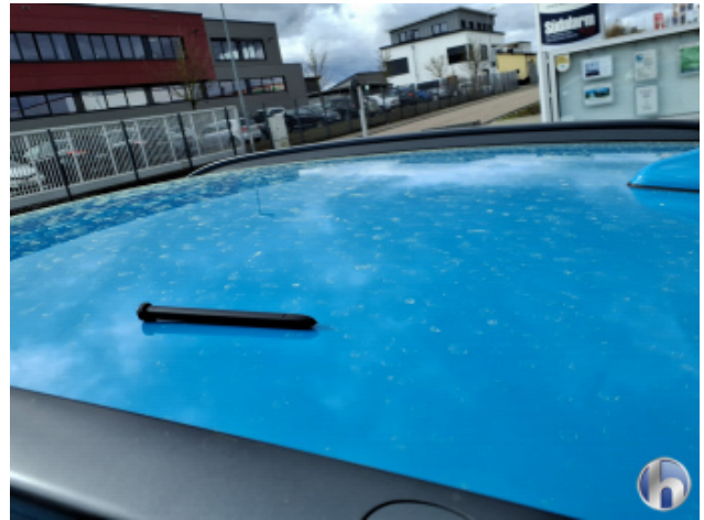
2. Dach Verdellt - Instandsetzen und Lackieren
