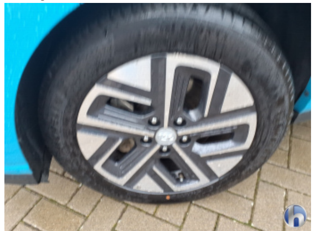
1. Felge Vorne - Links Kratzer - Smart Repair
