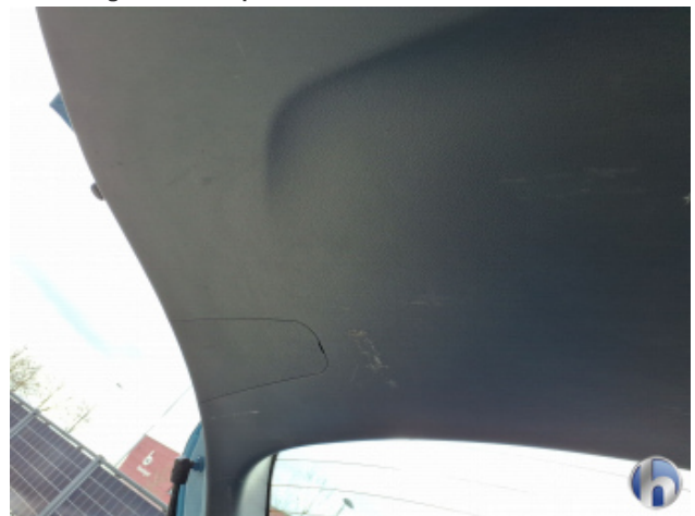
14. Heckklappenverkleidung Kratzer - Erneuern
