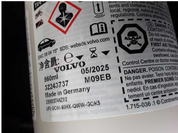
Beschädigung #1: Ausrüstung: Tirefit Füllmittel - abgelaufen - erneuern
