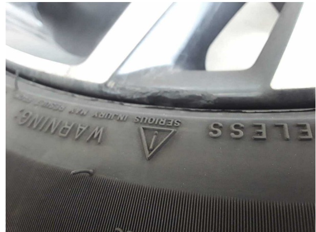
Beschädigung #2: 2.Radsatz: 1 Leichtmetallfelge - verformt - Wertminderung
