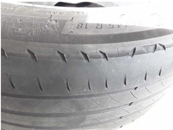
Damage #3: 2nd wheel set: 1 tyre (Aussenkante abgefahren) - Worn - Replace
