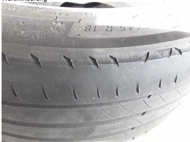
Beschädigung #3: 2.Radsatz: 1 Reifen (Aussenkante abgefahren) - verschlissen - erneuern
