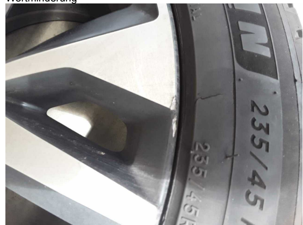
Beschädigung #2: 2.Radsatz: 1 Leichtmetallfelge - verformt - Wertminderung
