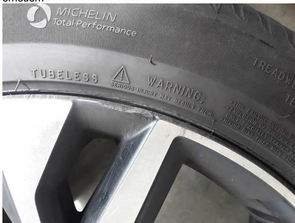
Beschädigung #2: 2.Radsatz: 1 Leichtmetallfelge - verformt - Wertminderung
