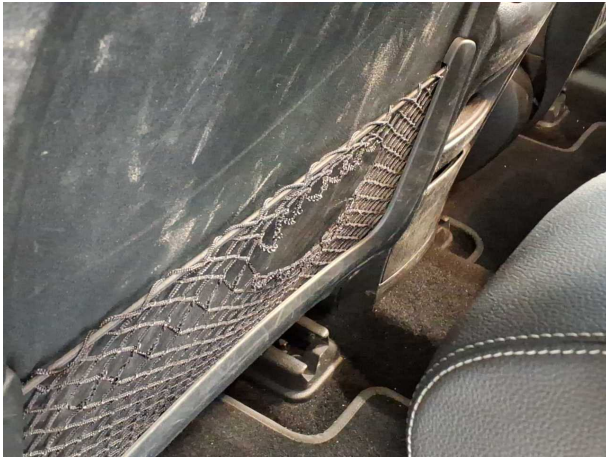
Beschädigung #3: Interieur: Trennnetz - beschädigt - erneuern
