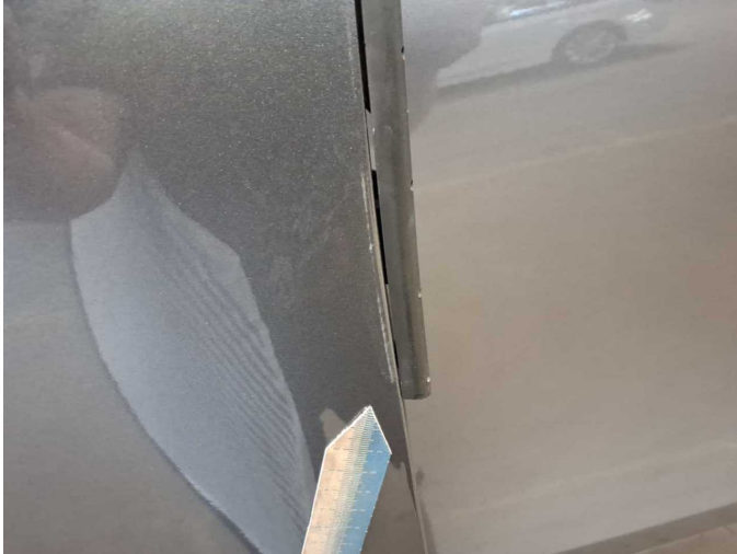
Damage 2: Door - front left side: Door (Kantenschutz schleift) - Malposition - Set / adjust
