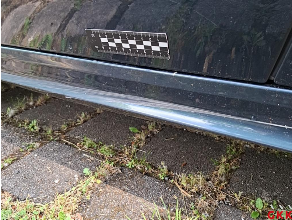
Bild 25. Schweller rechts, Abdeckung -lackiert-, beschädigt, ersetzen
