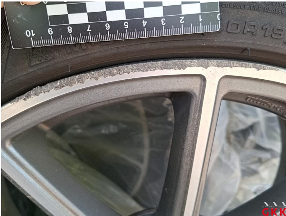
Bild 18. LM-Rad, 1 x beiliegend, Materialabtrag, ersetzen
