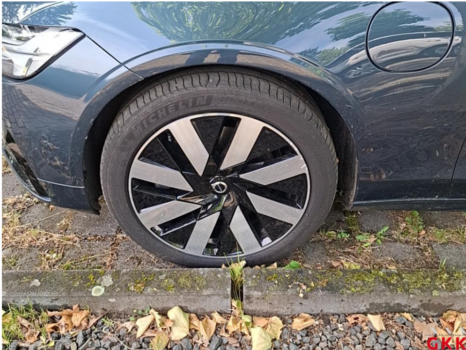
Bild 29. LM-Rad, vorne links, Materialabtrag, ersetzen
