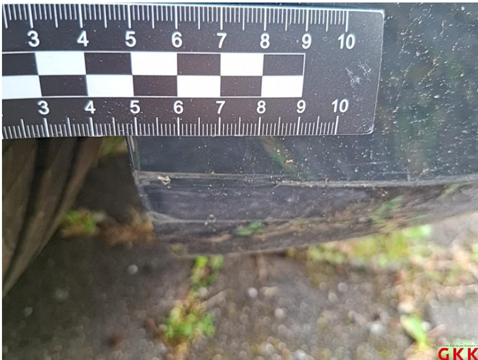
Bild 28. Stoßfänger vorne, Spoiler -lackiert-, verkratzt, lackieren
