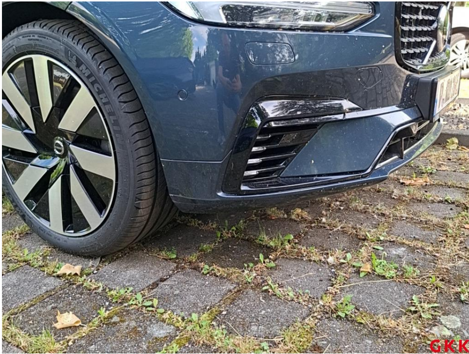
Bild 27. Stoßfänger vorne, Spoiler -lackiert-, verkratzt, lackieren
