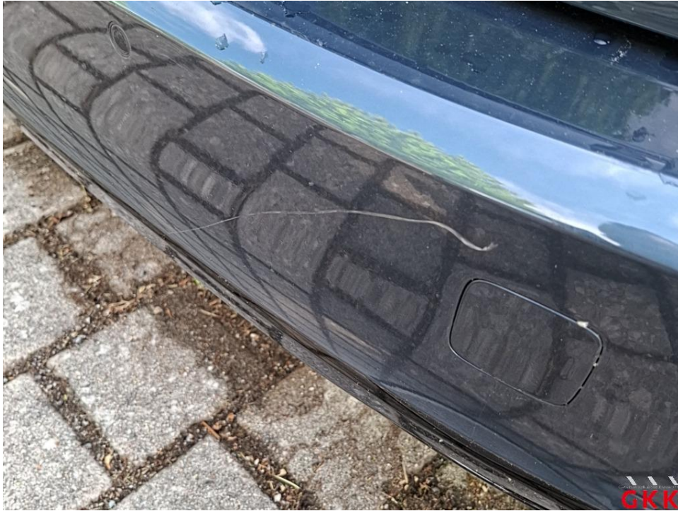
Bild 33. Stoßfänger hinten, Verkleidung -lackiert-, beschädigt, ersetzen
