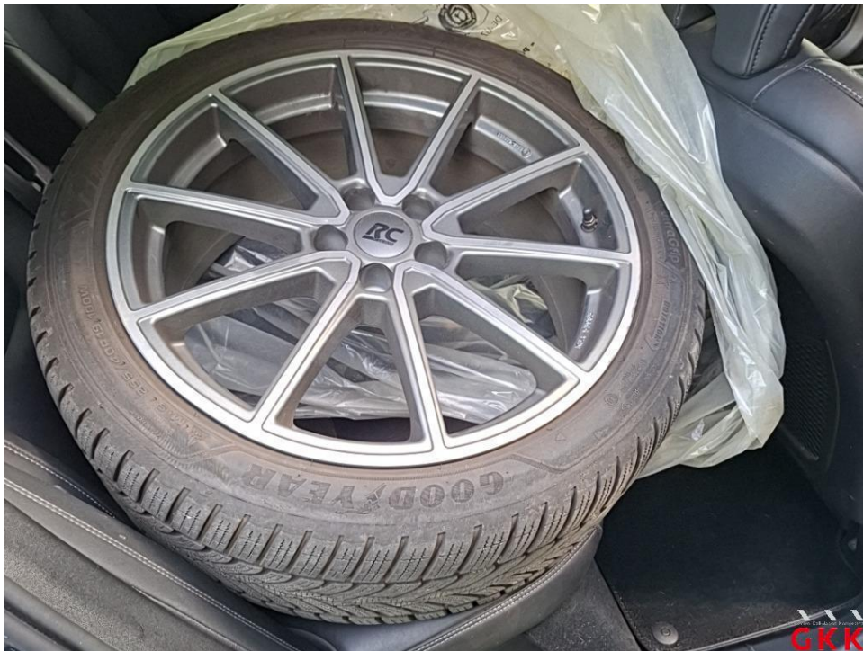
Bild 20. LM-Rad, 1 x beiliegend, Materialabtrag, ersetzen
