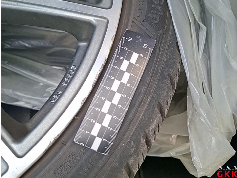
Bild 21. LM-Rad, 1 x beiliegend, Materialabtrag, ersetzen
