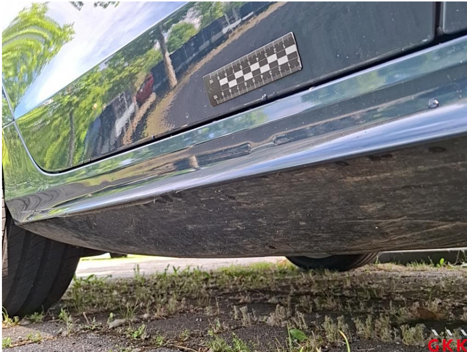
Bild 26. Schweller rechts, Abdeckung -lackiert-, beschädigt, ersetzen
