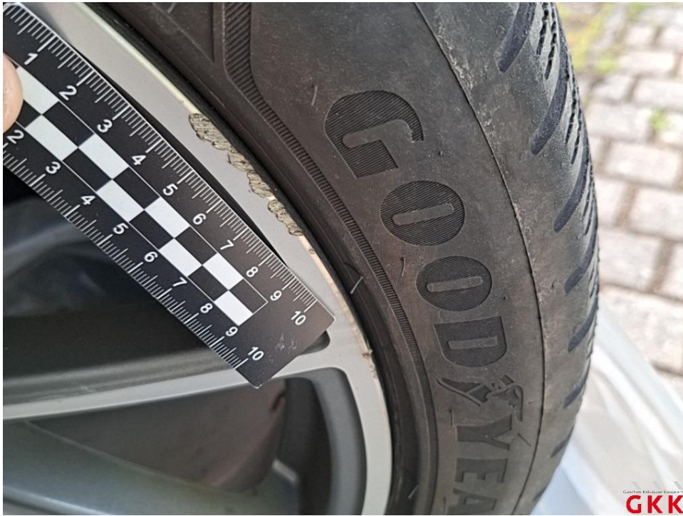
Bild 13. LM-Rad, 1 x beiliegend, Materialabtrag, ersetzen
