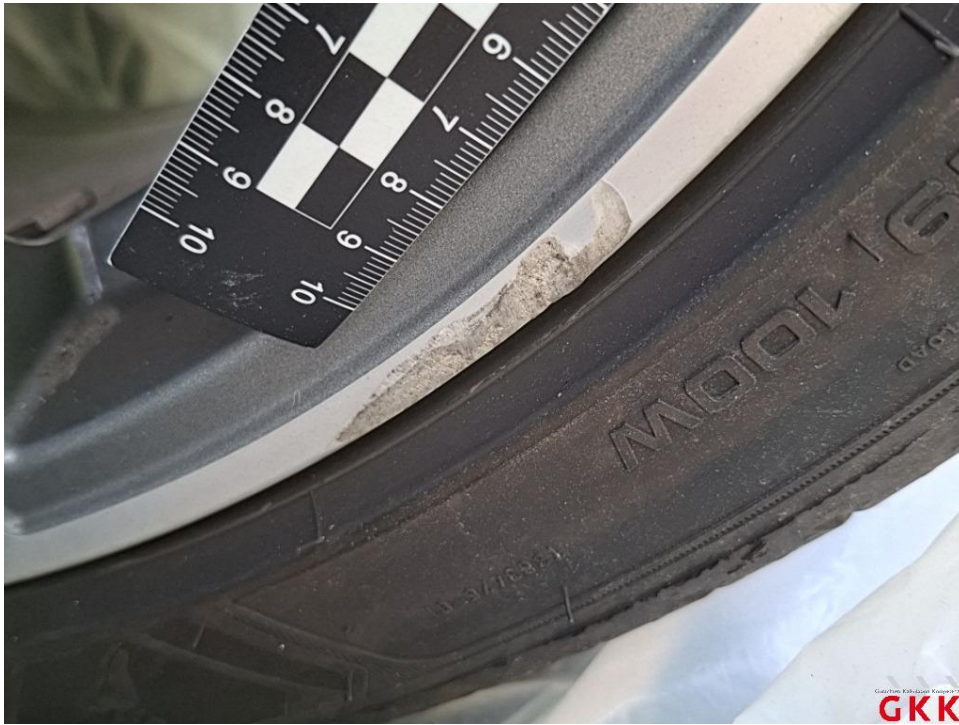
Bild 15. LM-Rad, 1 x beiliegend, Materialabtrag, ersetzen
