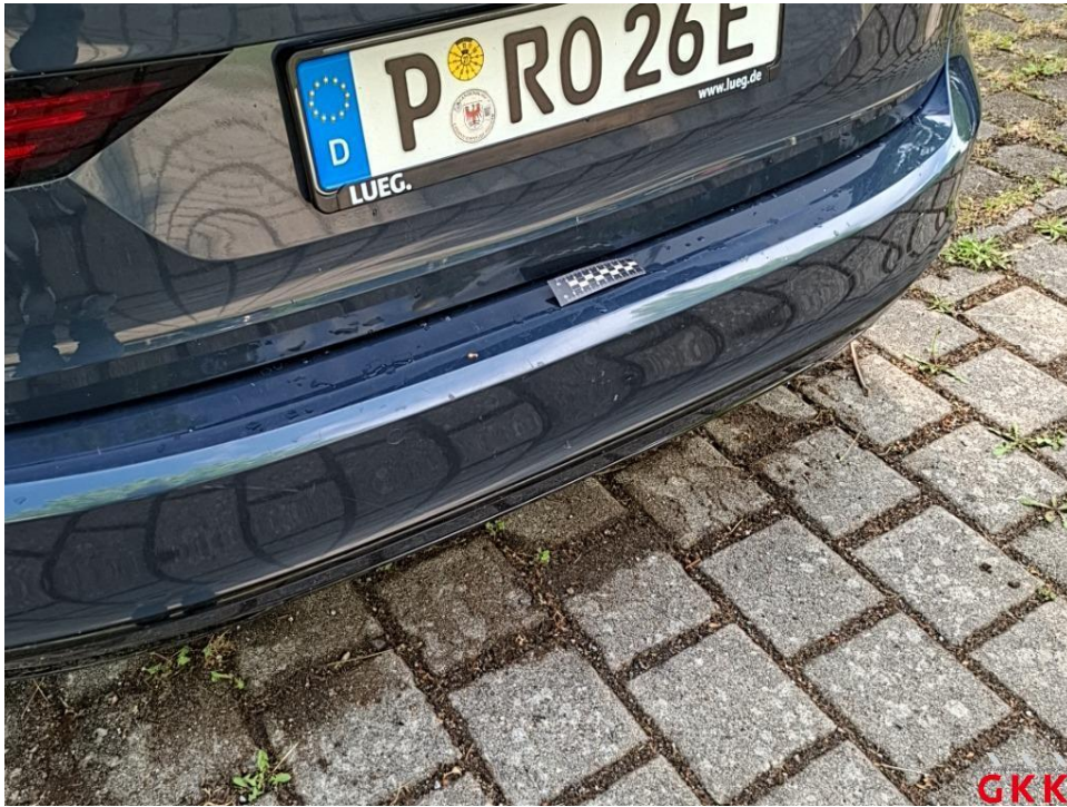
Bild 31. Stoßfänger hinten, Verkleidung -lackiert-, beschädigt, ersetzen
