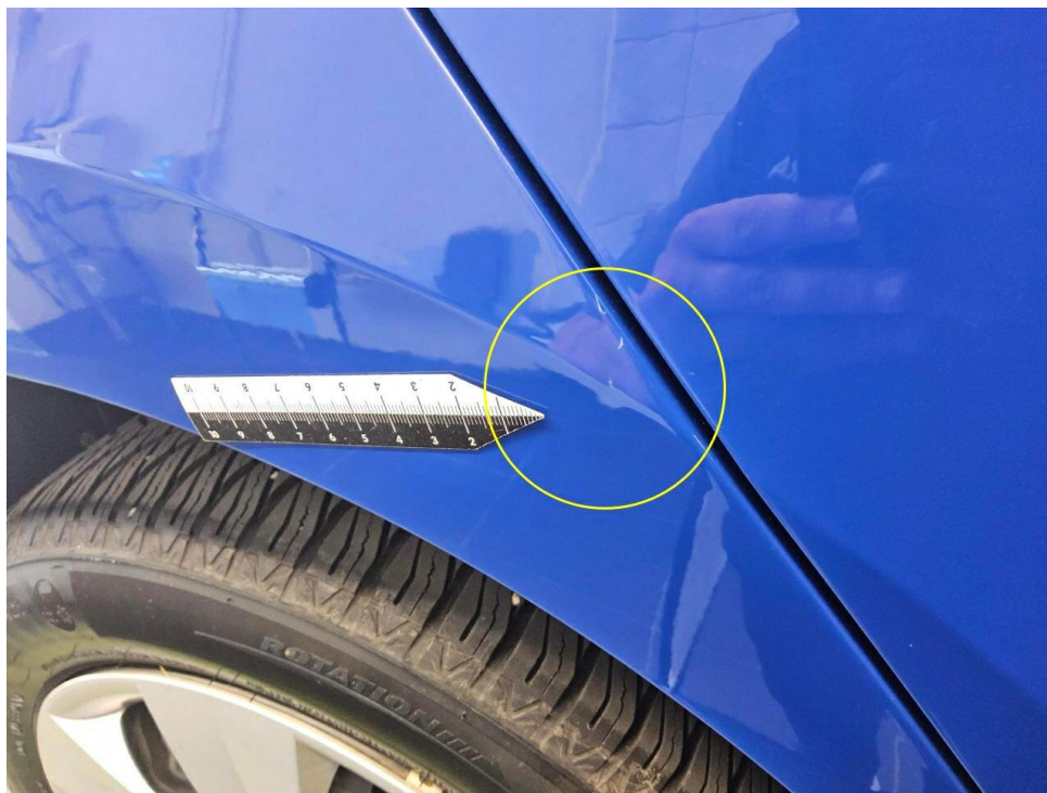
Bild 16 : Seitenteil hinten rechts, eingedellt, instandsetzen und lackieren mit Lackaufbau
