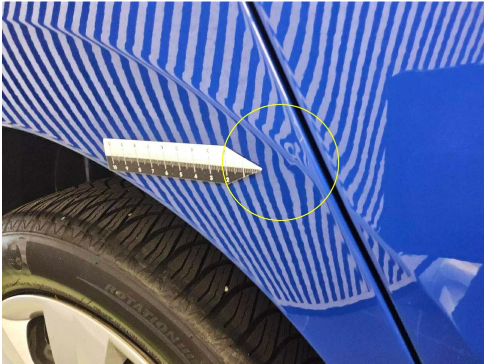
Bild 17 : Seitenteil hinten rechts, eingedellt, instandsetzen und lackieren mit Lackaufbau
