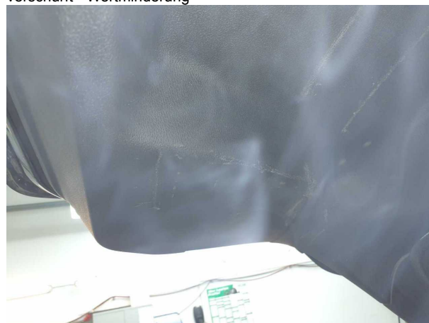
Beschädigung #9: Verkleidungen/Abdeckungen: Heckdeckel, Innenverkleidung - Kratzer - erneuern
