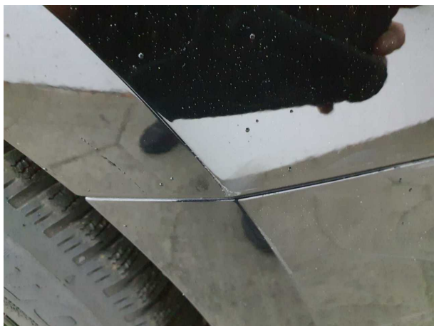
Beschädigung #13: Kotflügel rechts: Kotflügel rechts - Kratzer - lackieren
