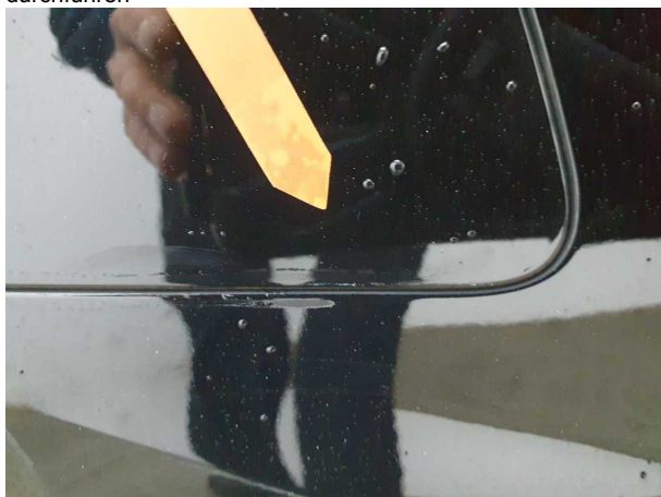
Beschädigung #13: Kotflügel rechts: Kotflügel rechts - Kratzer - lackieren
