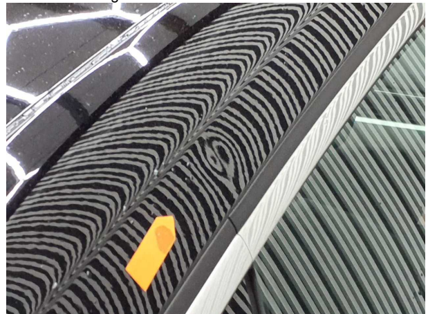
Beschädigung #10: Fahrzeugdach: Dachholm rechts - Delle(n) - sanft instandsetzen
