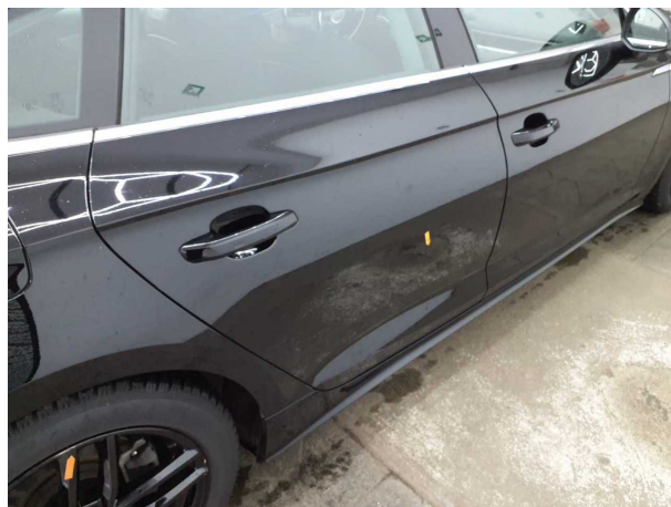
Beschädigung #14: Tür hinten rechts: Tür - Delle / Lackschaden - instandsetzen und lackieren
