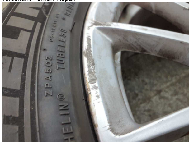
Beschädigung #8: 2.Radsatz: 1 Leichtmetallfelge - verkratzt / verschürft - Wertminderung
