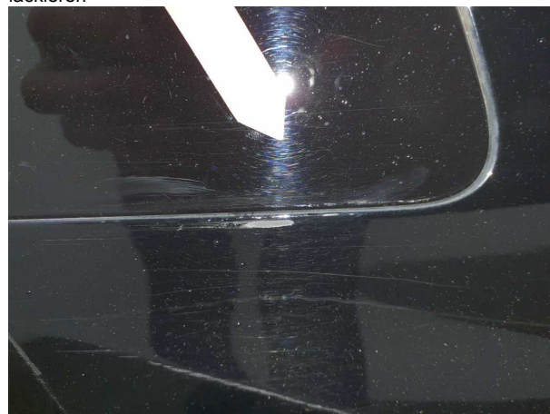
Beschädigung #13: Kotflügel rechts: Kotflügel rechts - Kratzer - lackieren
