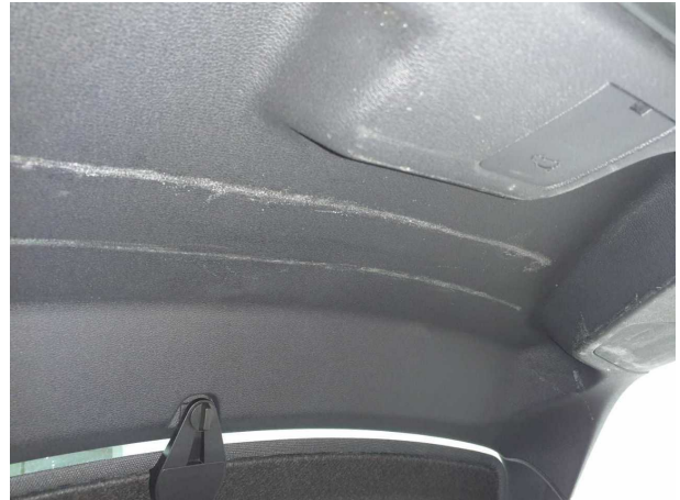
Beschädigung #9: Verkleidungen/Abdeckungen: Heckdeckel, Innenverkleidung - Kratzer - erneuern
