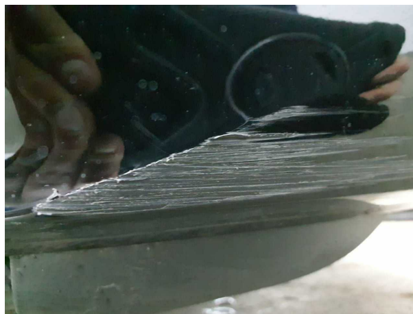
Beschädigung #17: Stossfänger vorn: Stossfänger vorn - verkratzt / verschürft - erneuern
