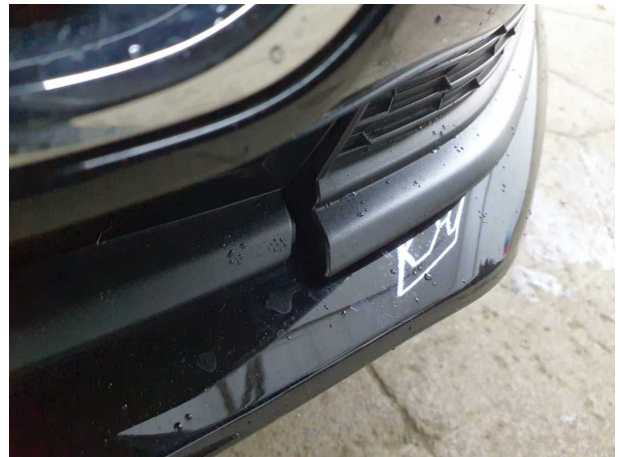
Beschädigung #3: Stossfänger vorn: Stossfänger vorn (Blende) - Fehlstellung - de-/montieren
