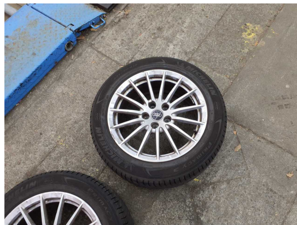
Beschädigung #8: 2.Radsatz: 1 Leichtmetallfelge - verkratzt / verschürft - Wertminderung
