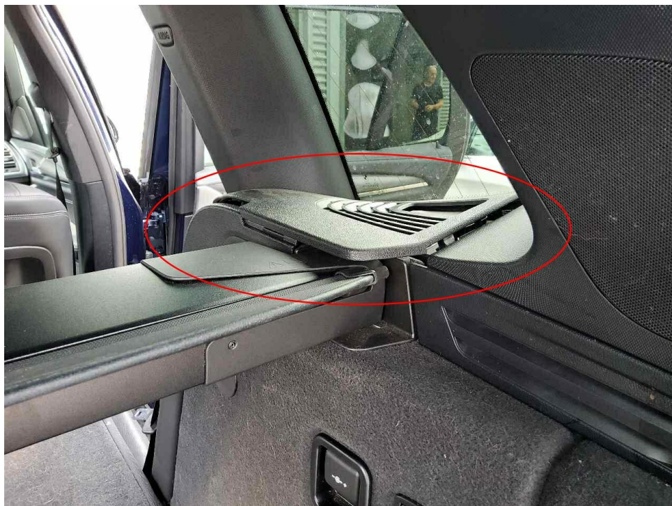
Bild 22 : Verkleidungen Laderaum lose
