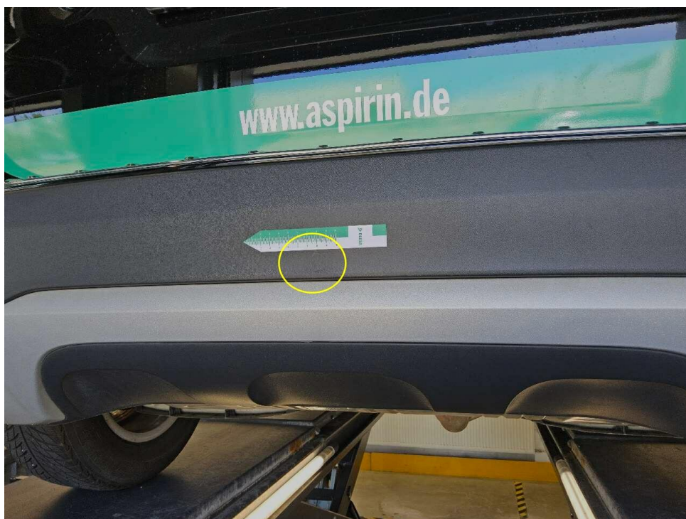
Bild 18 : Stoßfänger hinten mittig deformiert
