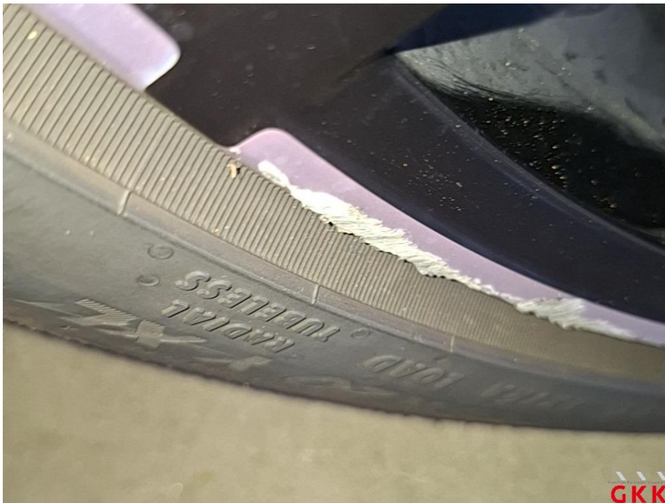
Bild 18 LM-Rad, vorne rechts, Materialabtrag, ersetzen
