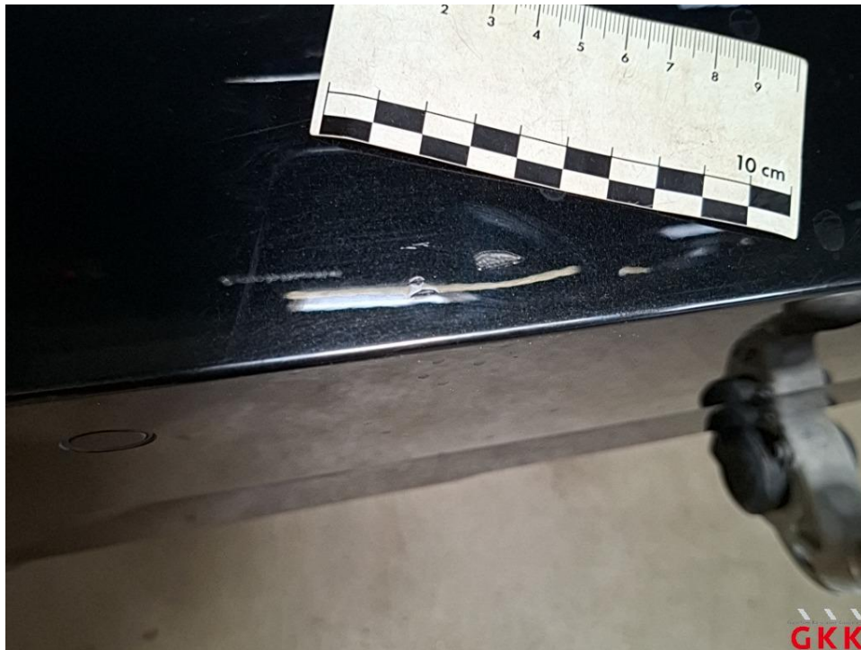
Bild 23 Stoßfänger hinten, Verkleidung -lackiert-, verkratzt, lackieren
