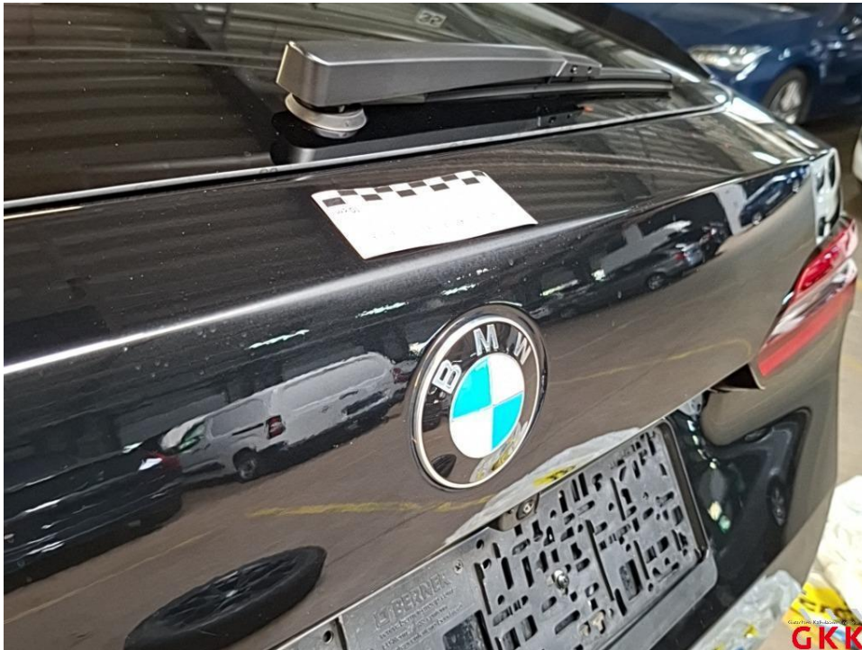
Bild 19 Heckklappe, unterhalb, verkratzt, lackieren
