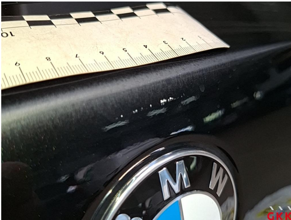
Bild 20 Heckklappe, unterhalb, verkratzt, lackieren
