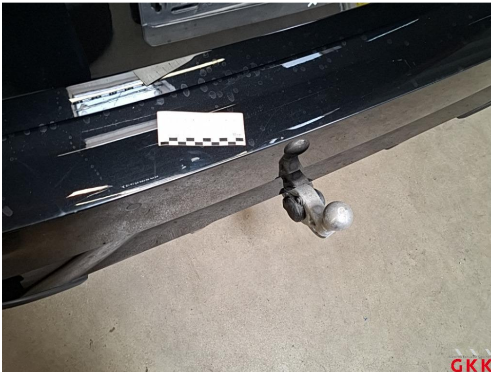
Bild 22 Stoßfänger hinten, Verkleidung -lackiert-, verkratzt, lackieren
