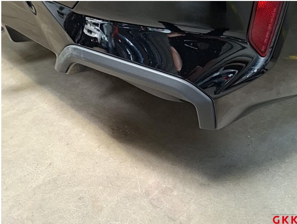
Bild 27 Stoßfänger hinten, Blende -unlackiert-, beschädigt, ersetzen
