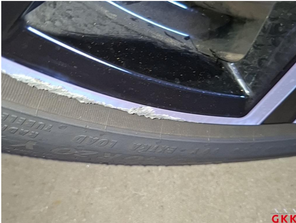
Bild 17 LM-Rad, vorne rechts, Materialabtrag, ersetzen
