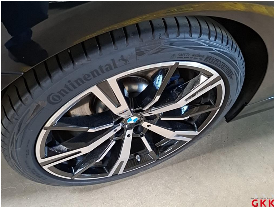
Bild 25 LM-Rad, hinten rechts, Materialabtrag, ersetzen
