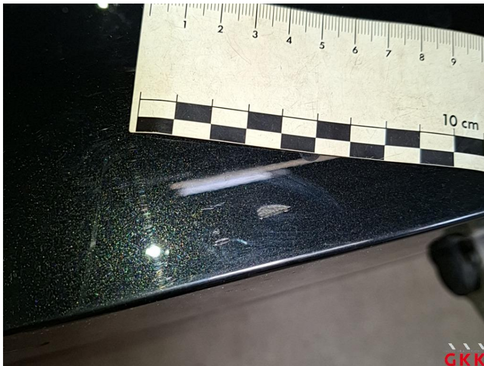
Bild 24 Stoßfänger hinten, Verkleidung -lackiert-, verkratzt, lackieren
