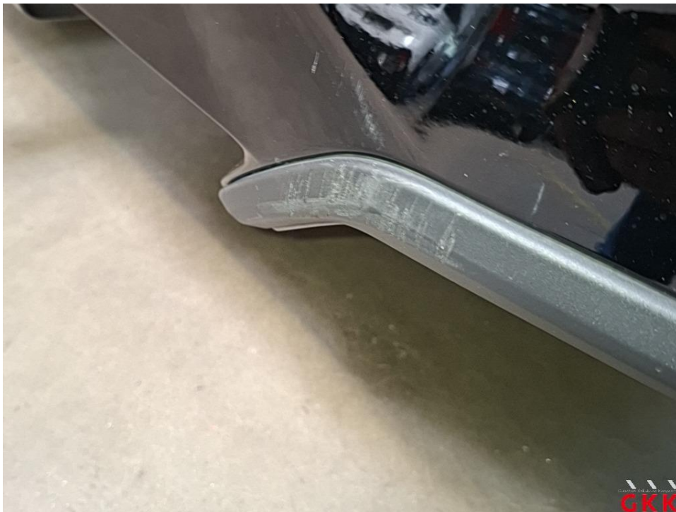
Bild 28 Stoßfänger hinten, Blende -unlackiert-, beschädigt, ersetzen
