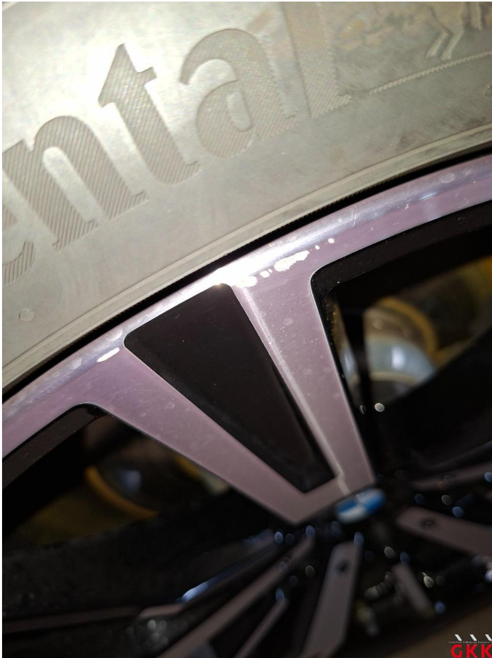
Bild 26 LM-Rad, hinten rechts, Materialabtrag, ersetzen
