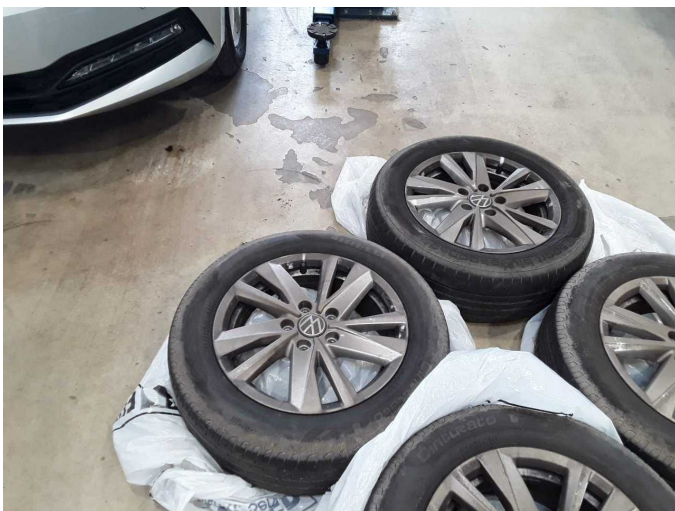
Damage 4: 2nd wheel set: 2 tyres (Innen abgefahren) - Worn - Replace
