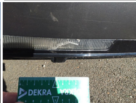
Bloc feu (de pare-choc) / Arrière / Cassé
