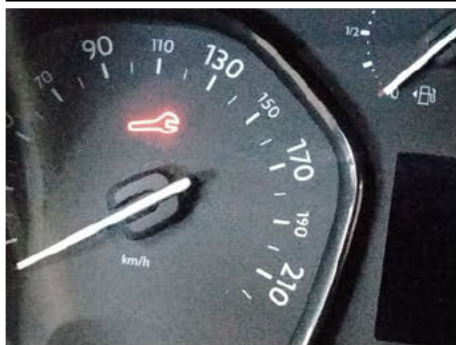
Warnleuchte Inspektion / Fehlt
