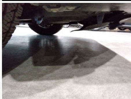
Unterfahrschutz / Vorne / Gebrochen
