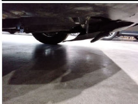
Unterfahrschutz / Vorne / Gebrochen
