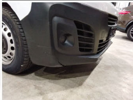
Unterfahrschutz / Vorne / Gebrochen
