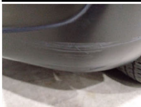
Stoßfänger unterhalb / Vorne / Gebrochen
