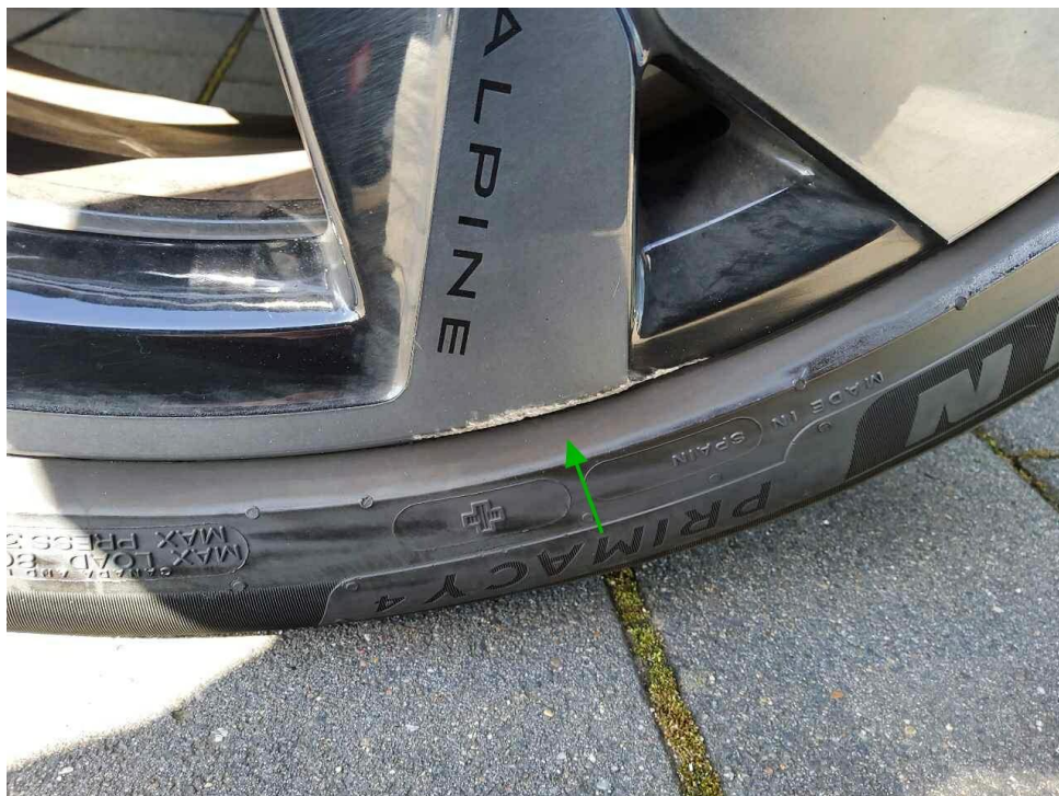
Bild 22 : Felge vorne rechts, zerkratzt
