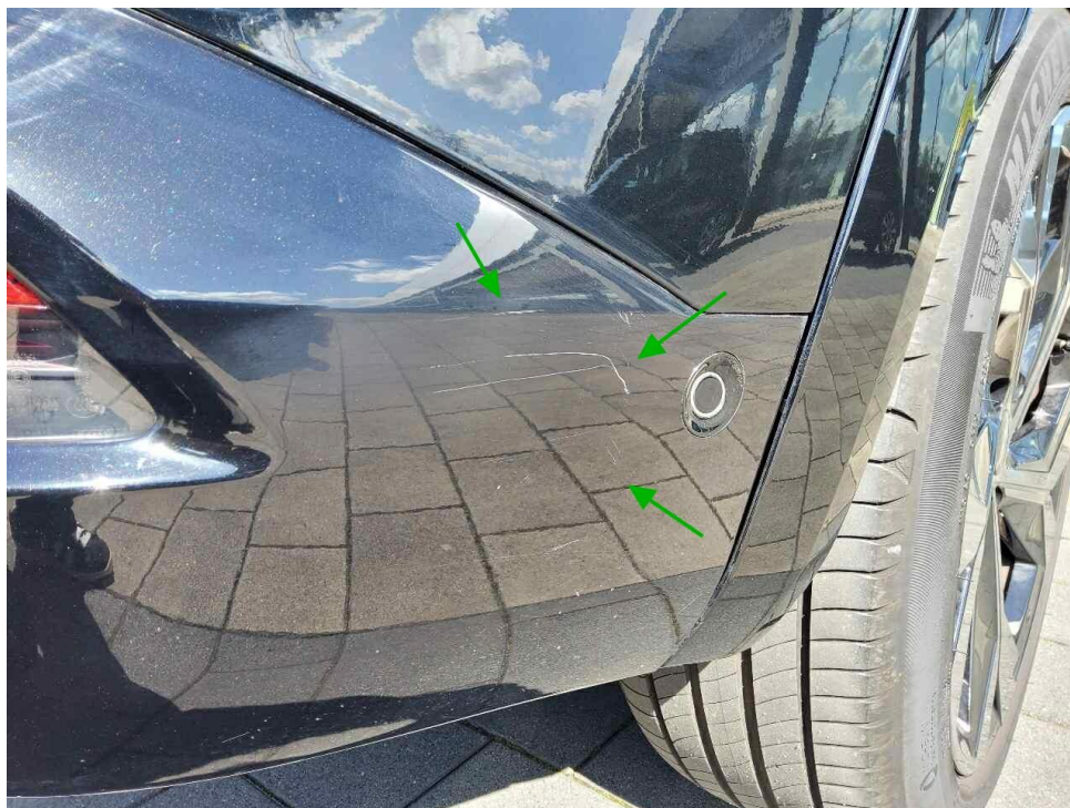
Bild 13 : Stoßfänger hinten, zerkratzt
