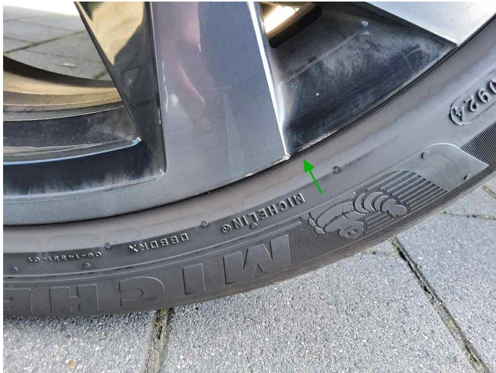
Bild 17 : Felge vorne links, zerkratzt, Wertminderung
