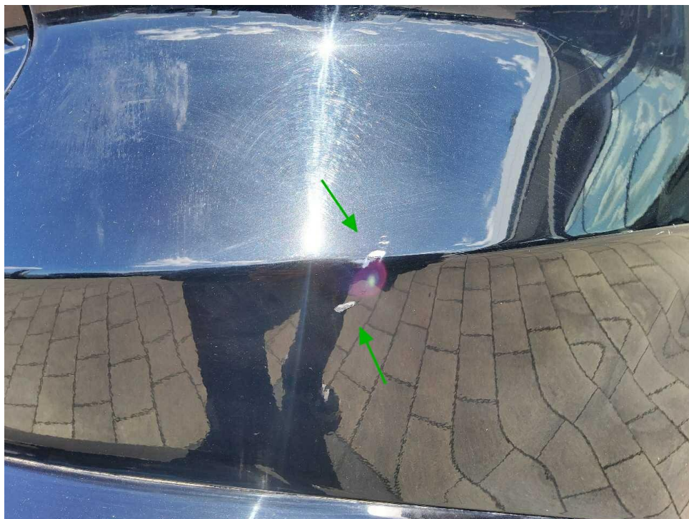
Bild 14 : Stoßfänger hinten, zerkratzt
