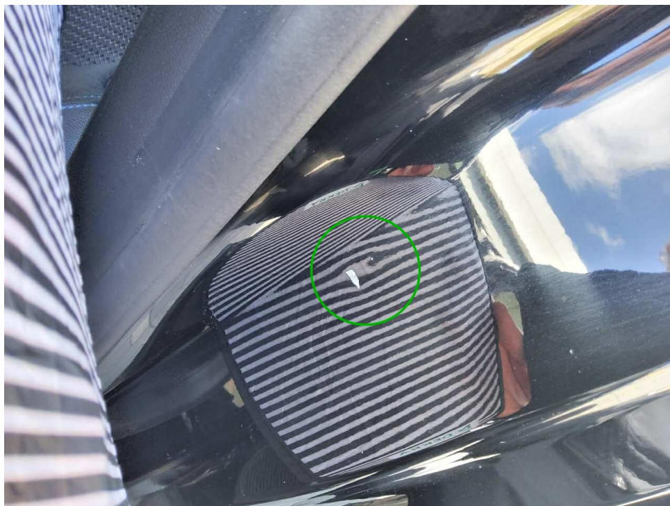
Bild 9 : Türeinstieg hinten links, Delle und Kratzer
