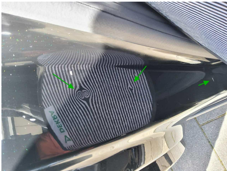
Bild 11 : Türeinstieg hinten rechts, zerkratzt und eingedellt
