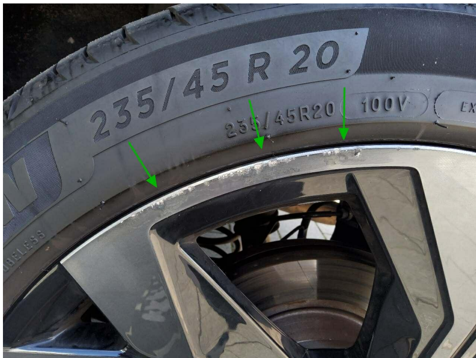
Bild 18 : Felge hinten links, zerkratzt
