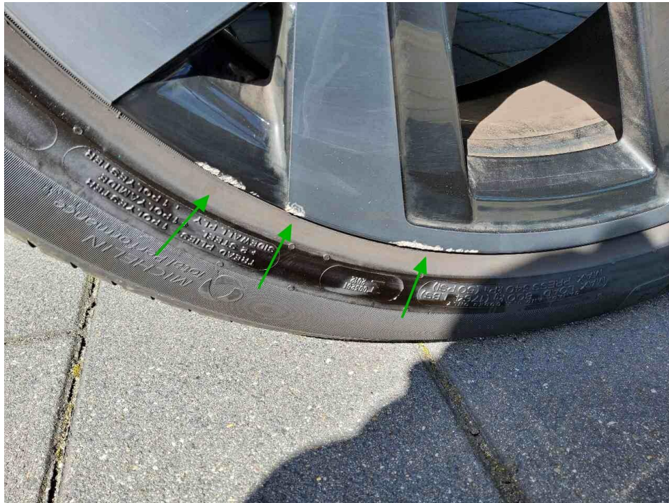
Bild 21 : Felge vorne rechts, zerkratzt
