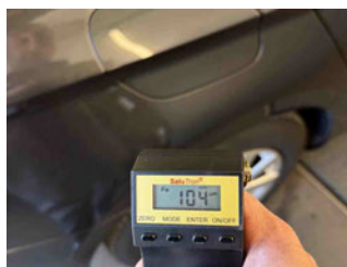
Lackstärke Seitenwand hinten rechts
