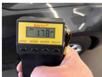
Lackstärke Kotflügel vorne rechts
