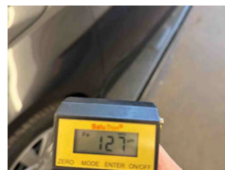
Lackstärke Kotflügel vorne links
