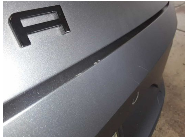
Beschädigung #13: Stossfänger hinten: Stossfänger hinten - Kratzer - lackieren
