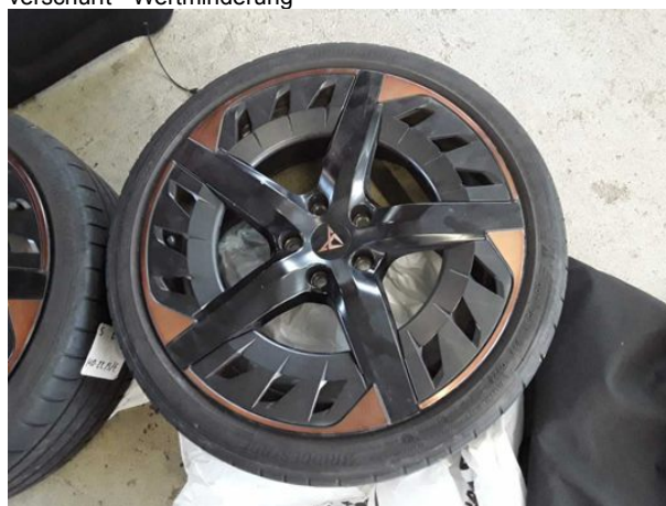
Beschädigung #9: 2.Radsatz: 3 Leichtmetallfelgen - verkratzt... verschürft - Wertminderung
