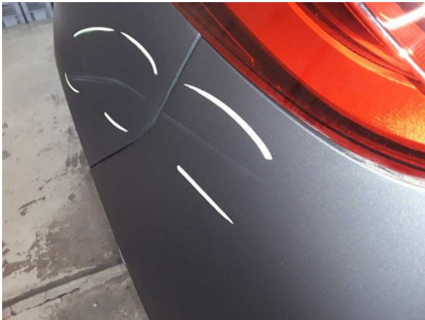
Beschädigung #13: Stossfänger hinten: Stossfänger hinten - Kratzer - lackieren
