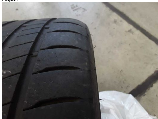
Beschädigung #8: 2.Radsatz: 2 Reifen - verschlissen - erneuern
