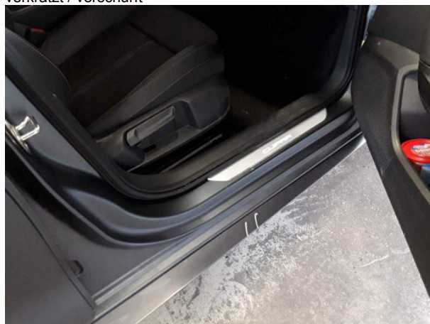
Beschädigung #6: Schweller rechts: Einstieg - Kratzer - Smart Repair
