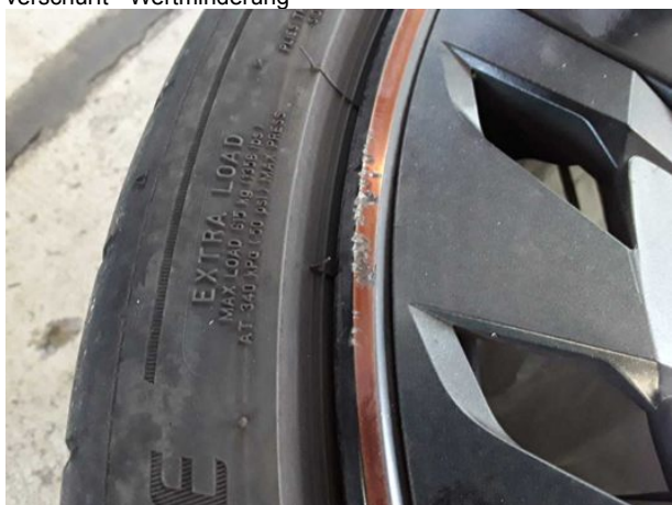
Beschädigung #9: 2.Radsatz: 3 Leichtmetallfelgen - verkratzt / verschürft - Wertminderung
