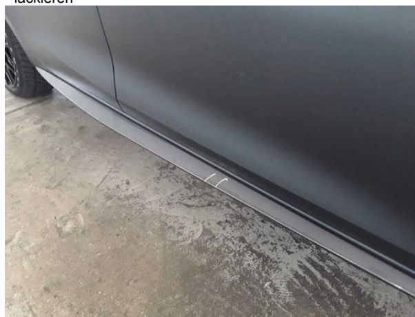
Beschädigung #12: Schweller rechts: Schweller - Kratzer - lackieren
