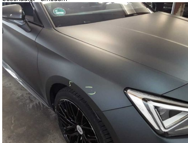
Beschädigung #11: Kotflügel rechts: Kotflügel rechts - Kratzer - lackieren
