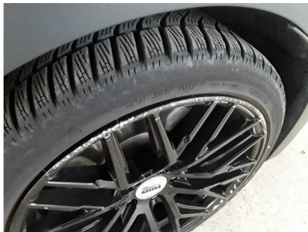
Beschädigung #1: Rad/Reifen: Leichtmetallfelge vorn rechts - verkratzt / verschürft
