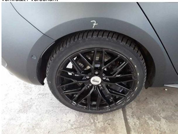
Beschädigung #2: Rad/Reifen: Leichtmetallfelge hinten rechts - verkratzt / verschürft
