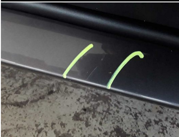
Beschädigung #12: Schweller rechts: Schweller - Kratzer - lackieren
