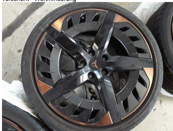
Beschädigung #9: 2.Radsatz: 3 Leichtmetallfelgen - verkratzt... verschürft - Wertminderung
