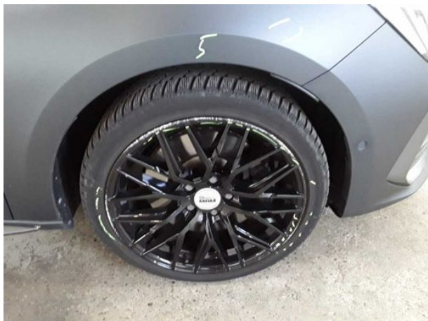
Beschädigung #1: Rad/Reifen: Leichtmetallfelge vorn rechts - verkratzt / verschürft
