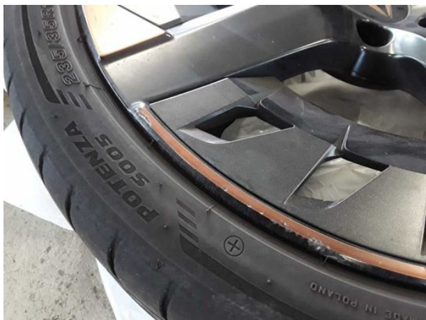
Beschädigung #9: 2.Radsatz: 3 Leichtmetallfelgen - verkratzt / verschürft - Wertminderung
