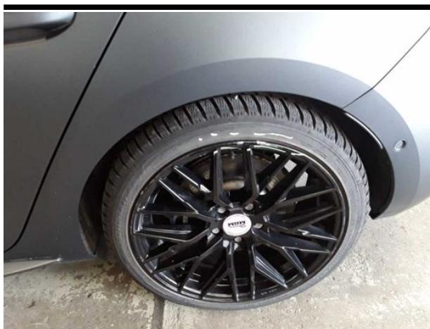
Beschädigung #4: Rad/Reifen: Leichtmetallfelge hinten links - verkratzt / verschürft
