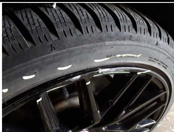
Beschädigung #4: Rad/Reifen: Leichtmetallfelge hinten links - verkratzt / verschürft
