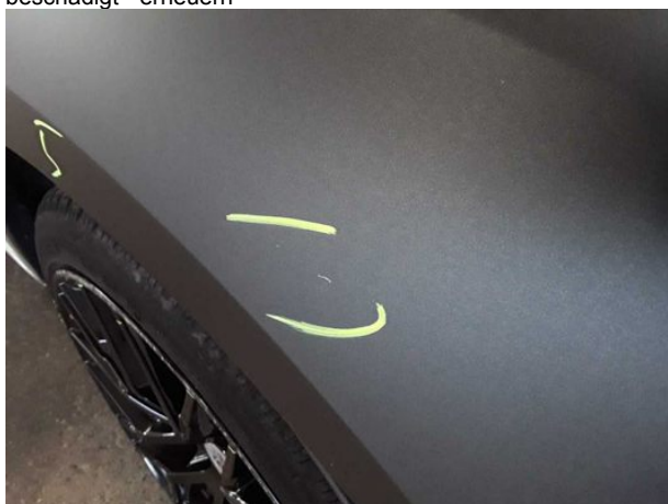
Beschädigung #11: Kotflügel rechts: Kotflügel rechts - Kratzer - lackieren
