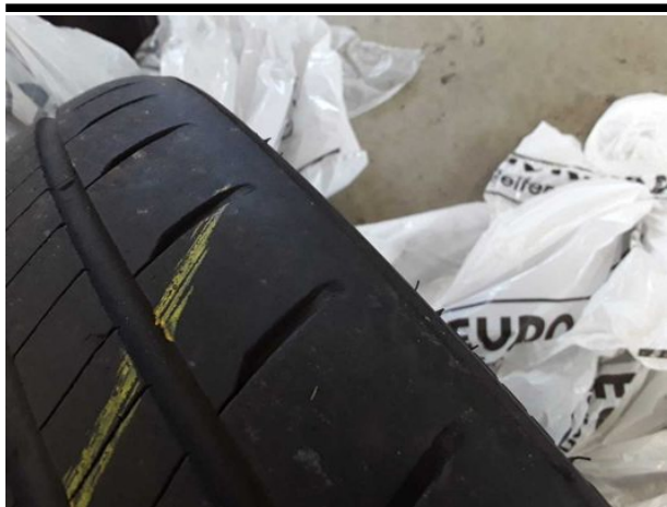
Beschädigung #8: 2.Radsatz: 2 Reifen - verschlissen - erneuern
