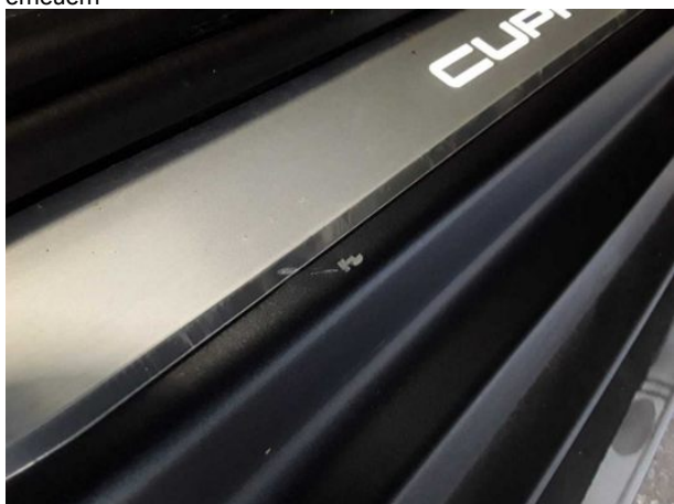
Beschädigung #6: Schweller rechts: Einstieg - Kratzer - Smart Repair
