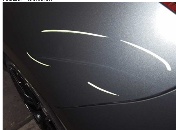
Beschädigung #14: Seitenwand links: Seitenwand - Kratzer - lackieren
