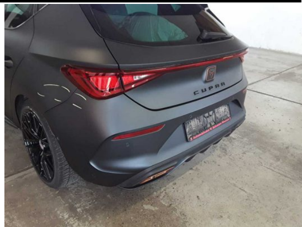
Beschädigung #13: Stossfänger hinten: Stossfänger hinten - Kratzer - lackieren
