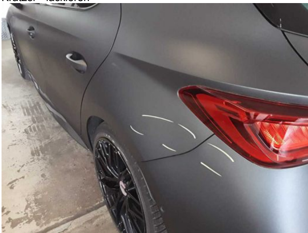
Beschädigung #14: Seitenwand links: Seitenwand - Kratzer - lackieren
