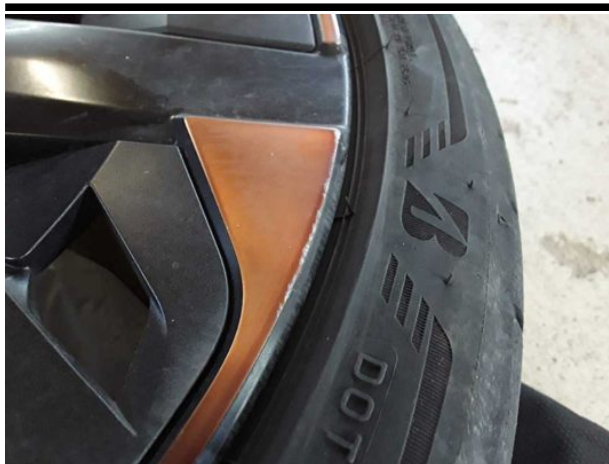
Beschädigung #9: 2.Radsatz: 3 Leichtmetallfelgen - verkratzt / verschürft - Wertminderung
