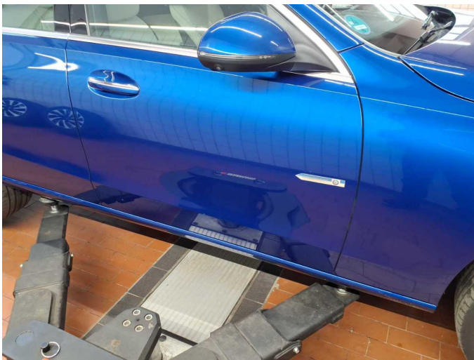
Damage 3: Door - front right side: Door - Scratch(es) - Paint
