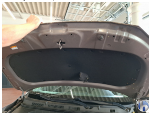
5. Motordämmmaterial Beschädigt - Erneuern
