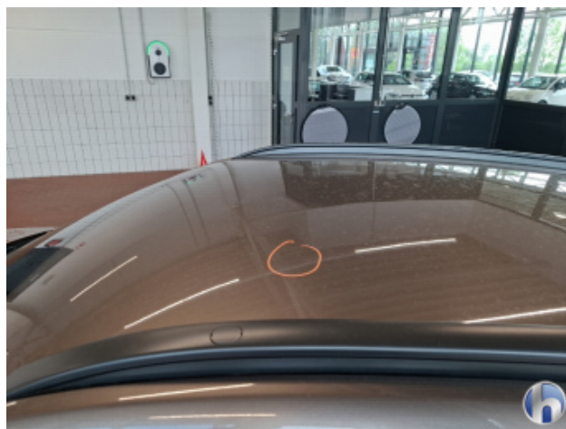
2. Dach Delle Bis 20 Mm Mit Lackschaden - Sanft Instandsetzen
