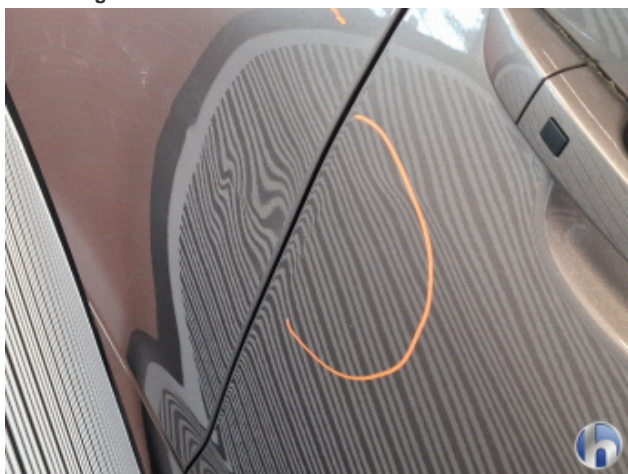
4. Tür Vorne - Rechts Beschädigt - Smart Repair
