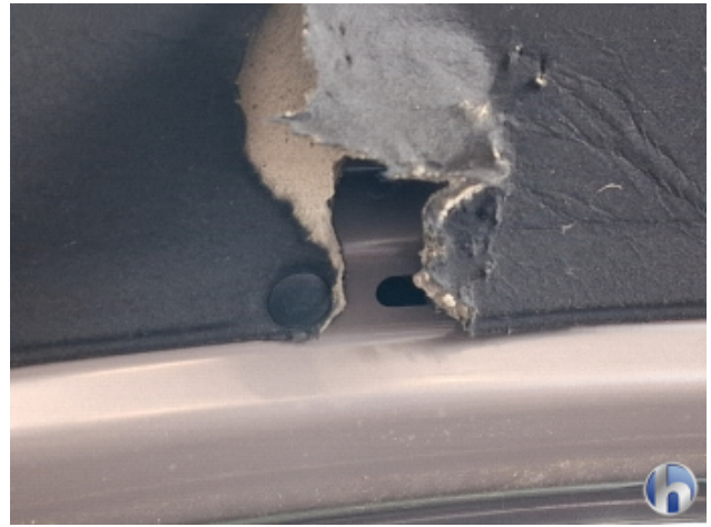
5. Motordämmmaterial Beschädigt - Erneuern
