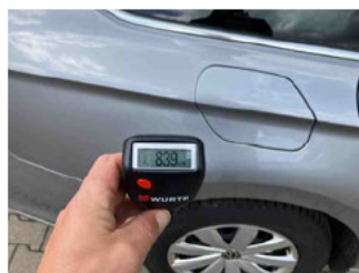
Lackstärke Seitenwand hinten rechts
