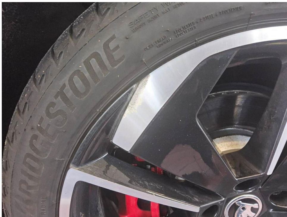
Bild 17 : Felge hinten links Bordsteinschaden
