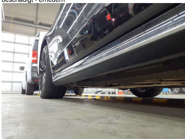
Beschädigung #8: Schweller links: Verkleidung - verkratzt / verschürft - lackieren
