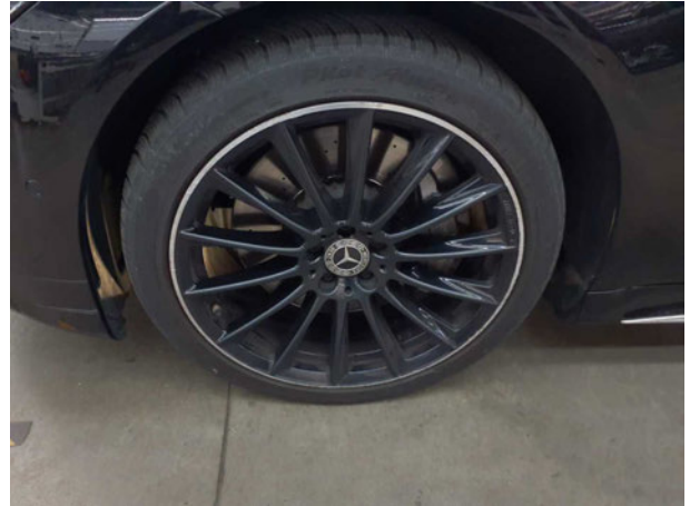
Beschädigung #17: Rad/Reifen: Leichtmetallfelge vorn links - beschädigt - erneuern
