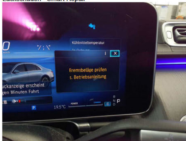
Beschädigung #4: Bremsanlage: Bremsanlage - Diagnose durchführen
