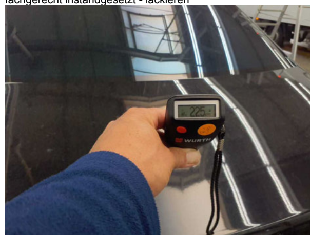
Beschädigung #13: Heckklappe/-tür: Heckklappe - nicht fachgerecht instandgesetzt - lackieren
