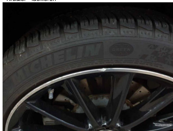
Beschädigung #15: Rad/Reifen: Leichtmetallfelge hinten links - beschädigt - erneuern
