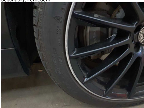
Beschädigung #15: Rad/Reifen: Leichtmetallfelge hinten links - beschädigt - erneuern
