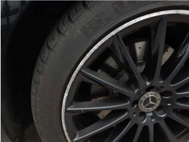
Beschädigung #16: Rad/Reifen: Leichtmetallfelge hinten rechts - beschädigt - erneuern
