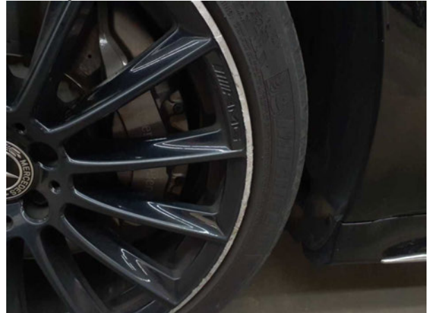
Beschädigung #17: Rad/Reifen: Leichtmetallfelge vorn links - beschädigt - erneuern
