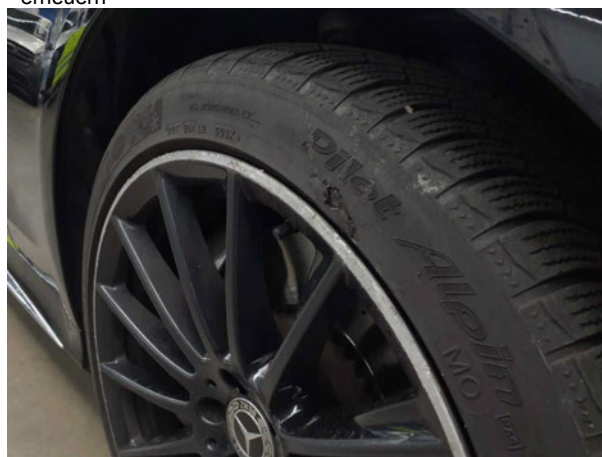
Beschädigung #12: Rad/Reifen: Reifen vorn rechts - beschädigt - erneuern
