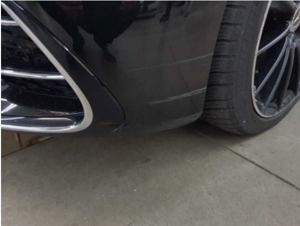
Beschädigung #19: Stossfänger vorn: Stossfänger mit Parktronic (inkl. Blenden erneuern) - verkratzt / verschürft - lackieren
