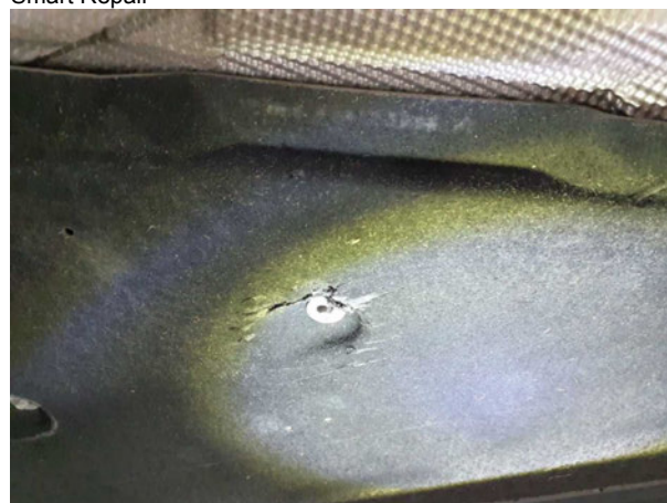
Beschädigung #7: Karosserie: Unterbodenverkleidung (links) - beschädigt - erneuern
