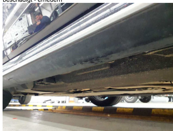
Beschädigung #8: Schweller links: Verkleidung - verkratzt / verschürft - lackieren
