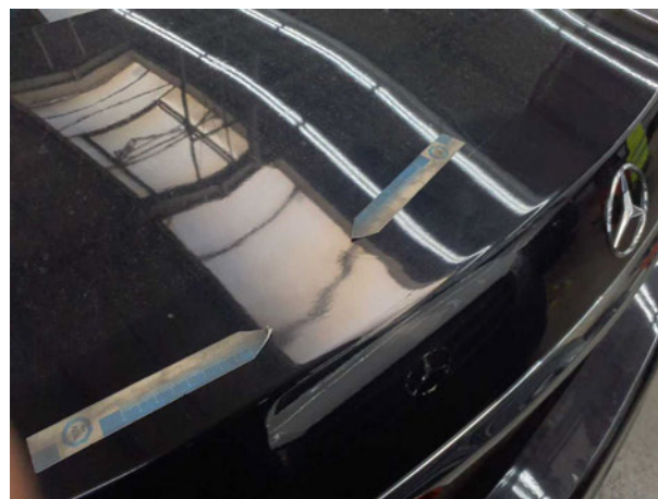
Beschädigung #13: Heckklappe/-tür: Heckklappe - nicht fachgerecht instandgesetzt - lackieren
