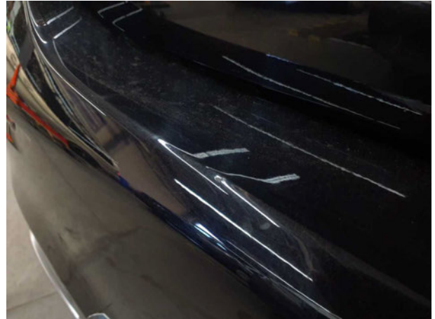
Beschädigung #14: Stossfänger hinten: Stossfänger mit Parktro... - Kratzer - lackieren
