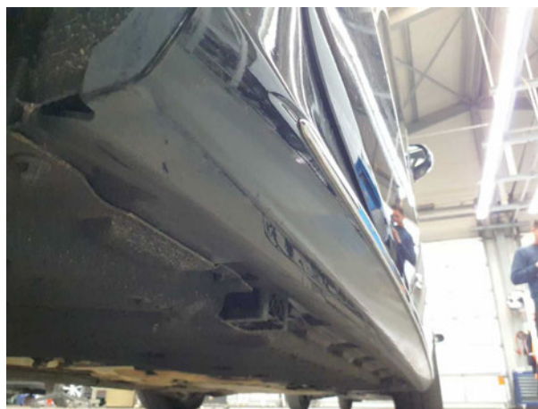
Beschädigung #9: Schweller rechts: Verkleidung - verkratzt / verschürft - lackieren
