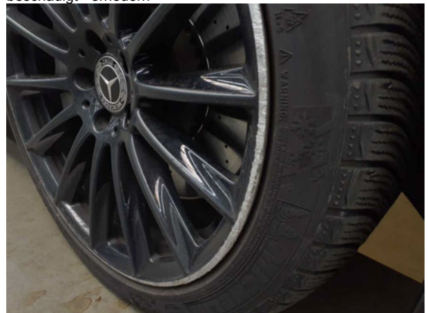
Beschädigung #18: Rad/Reifen: Leichtmetallfelge vorn rechts - beschädigt - erneuern
