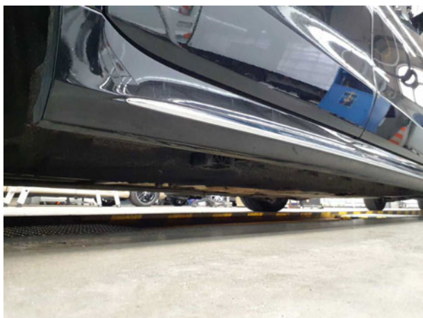
Beschädigung #9: Schweller rechts: Verkleidung - verkratzt / verschürft - lackieren
