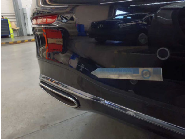
Beschädigung #14: Stossfänger hinten: Stossfänger mit Parktronic - Kratzer - lackieren
