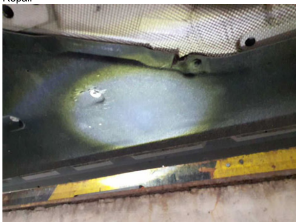
Beschädigung #7: Karosserie: Unterbodenverkleidung (links) - beschädigt - erneuern
