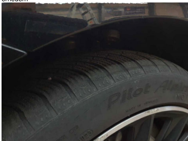
Beschädigung #11: Rad/Reifen: Reifen vorn links - verschlissen - erneuern
