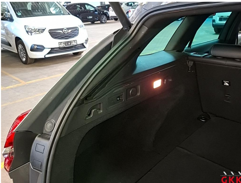
Bild 41 D- Säule links, Innenverkleidung, verkratzt, ersetzen
