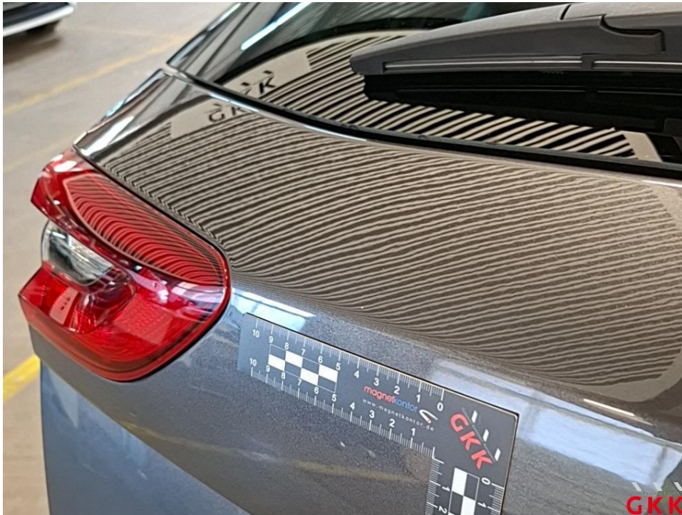
Bild 40 Heckklappe, Reparaturmangel, lackieren
