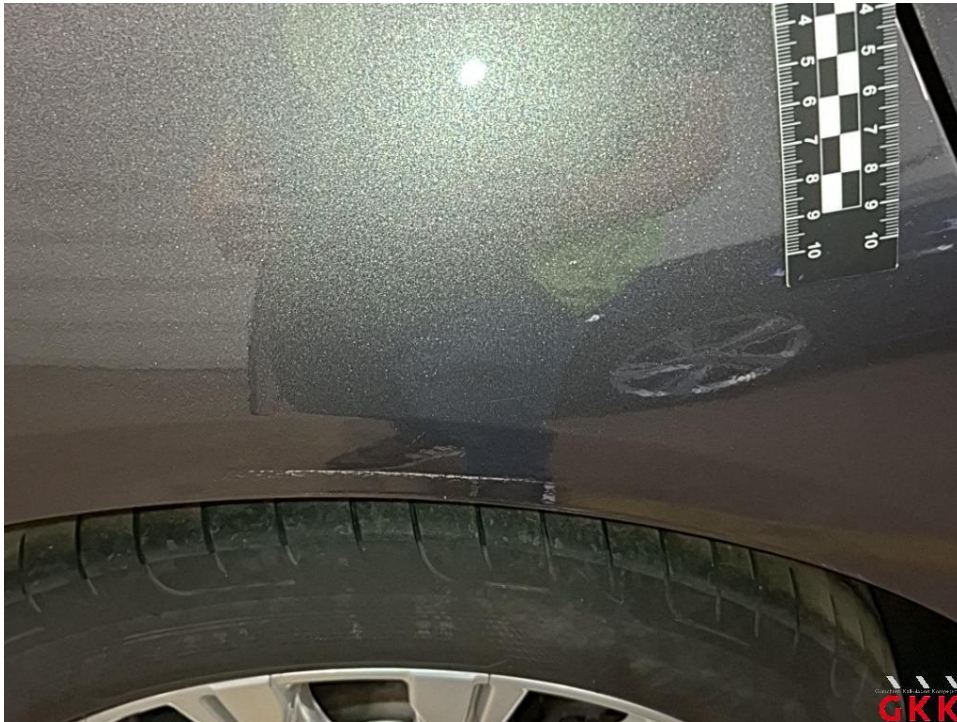
Bild 34 Seitenwand rechts, eingedellt und verkratzt (I), Smartrepair
