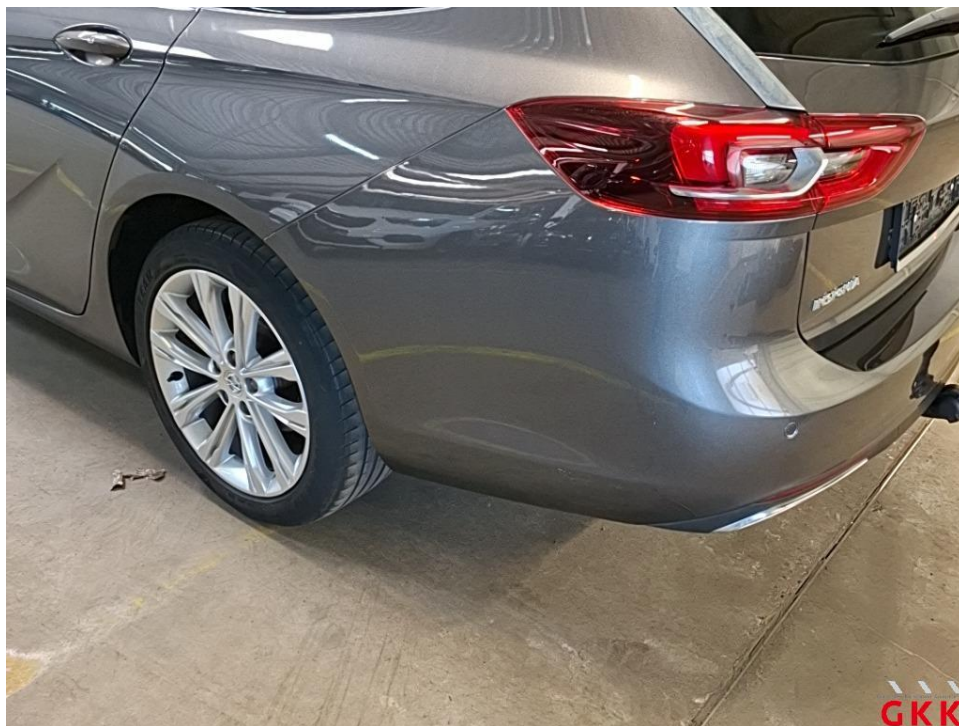
Bild 37 Stoßfänger hinten, Verkleidung -lackiert-, Reparaturmangel, lackieren
