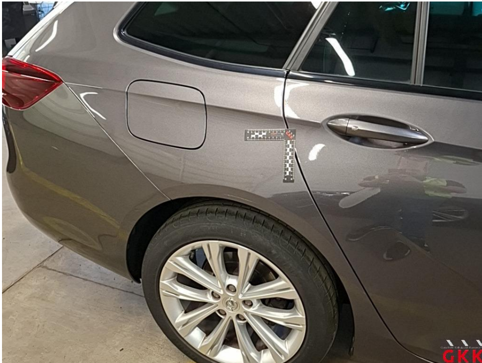
Bild 32 Seitenwand rechts, eingedellt und verkratzt (I), Smartrepair
