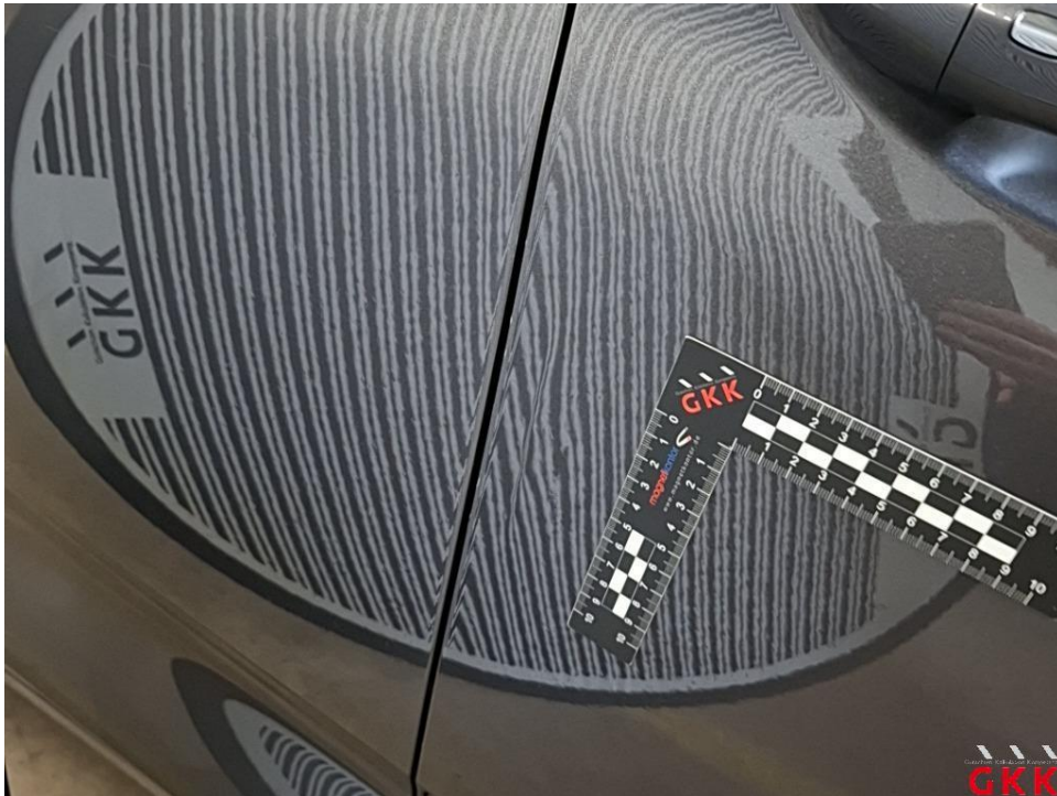
Bild 29 Tür vorne rechts, Reparaturmangel, instand setzen - lackieren
