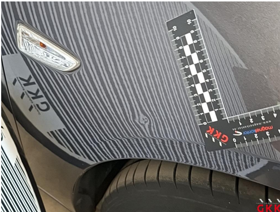
Bild 26 Kotflügel vorne rechts, beschädigt, instand setzen - lackieren
