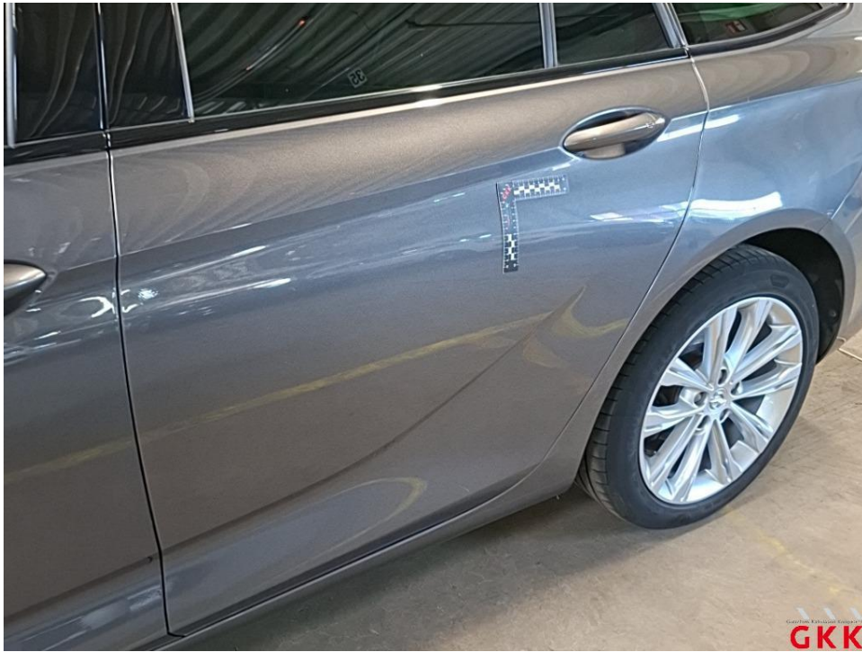
Bild 15 Tür hinten links, Reparaturmangel, lackieren
