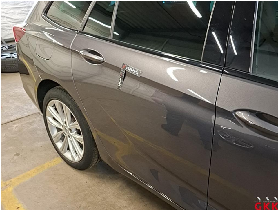
Bild 30 Tür hinten rechts, Reparaturmangel, lackieren
