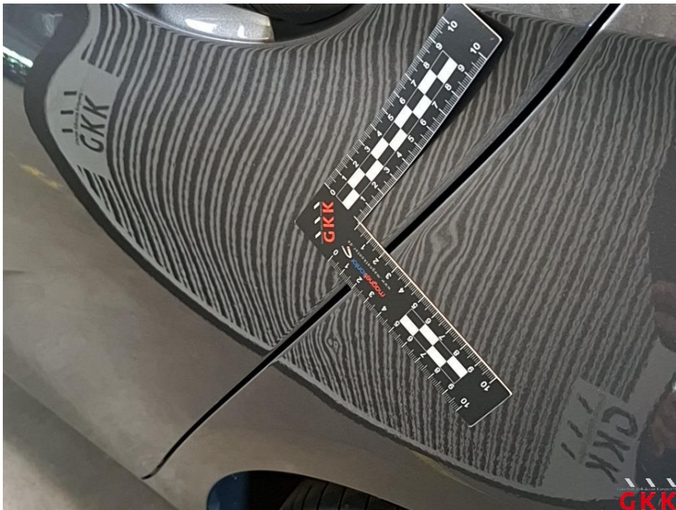
Bild 45 Seitenwand links, beschädigt, kalt drücken
