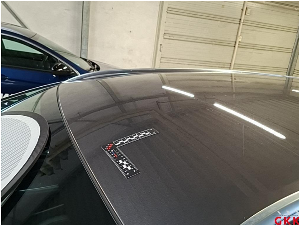
Bild 17 Dach, Reparaturmangel, instand setzen - lackieren
