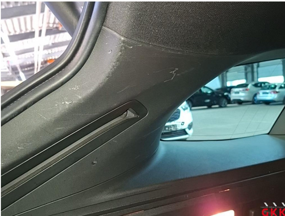
Bild 43 D- Säule links, Innenverkleidung, verkratzt, ersetzen
