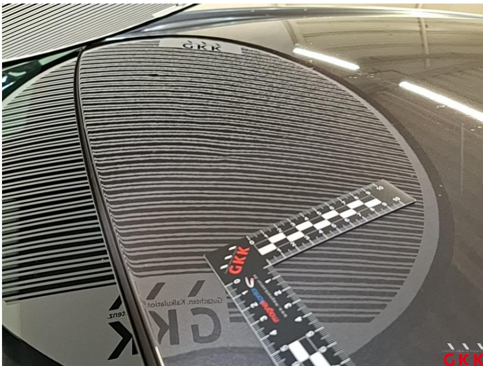
Bild 18 Dach, Reparaturmangel, instand setzen - lackieren
