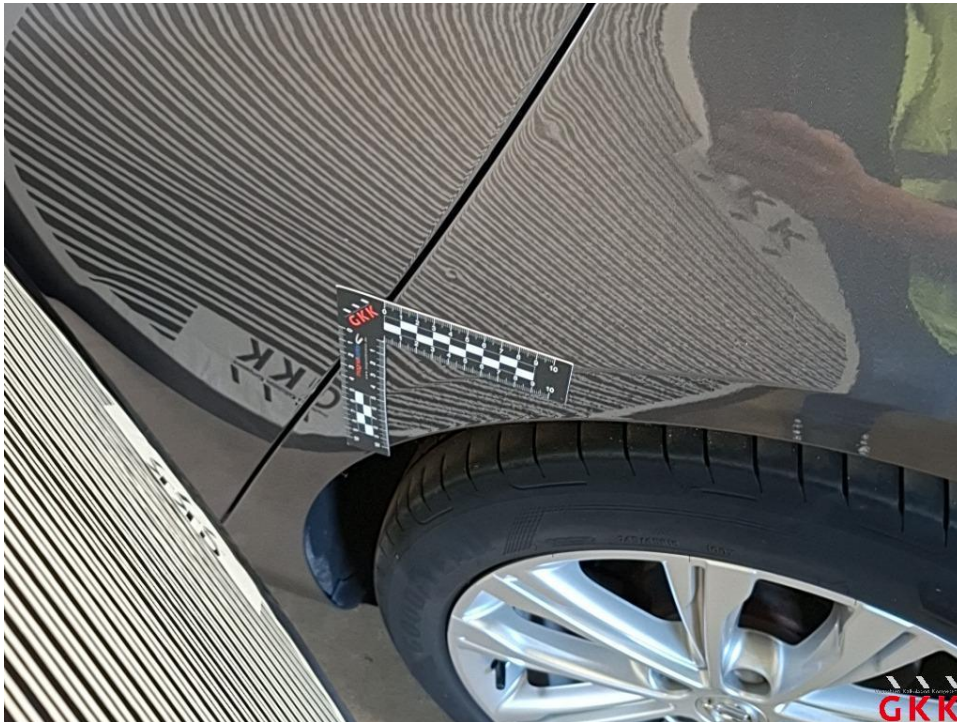
Bild 46 Seitenwand links, beschädigt, kalt drücken
