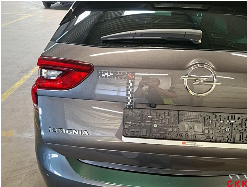
Bild 39 Heckklappe, Reparaturmangel, lackieren
