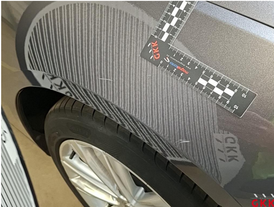
Bild 27 Kotflügel vorne rechts, beschädigt, instand setzen - lackieren
