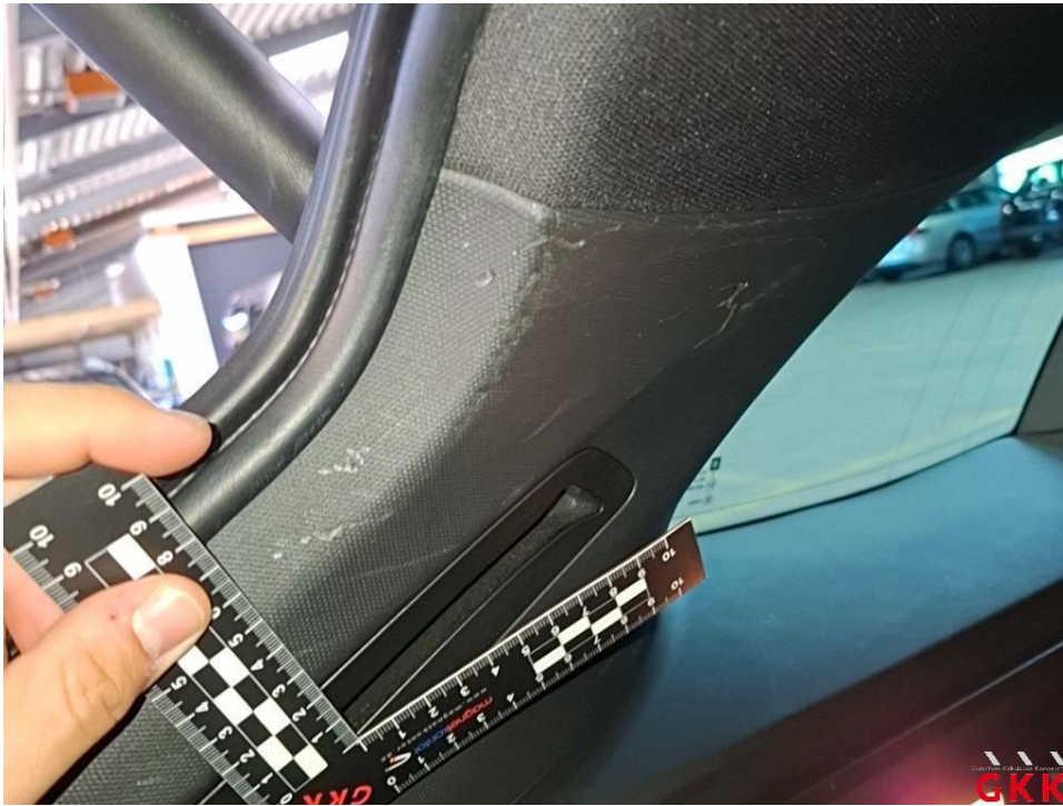
Bild 42 D- Säule links, Innenverkleidung, verkratzt, ersetzen
