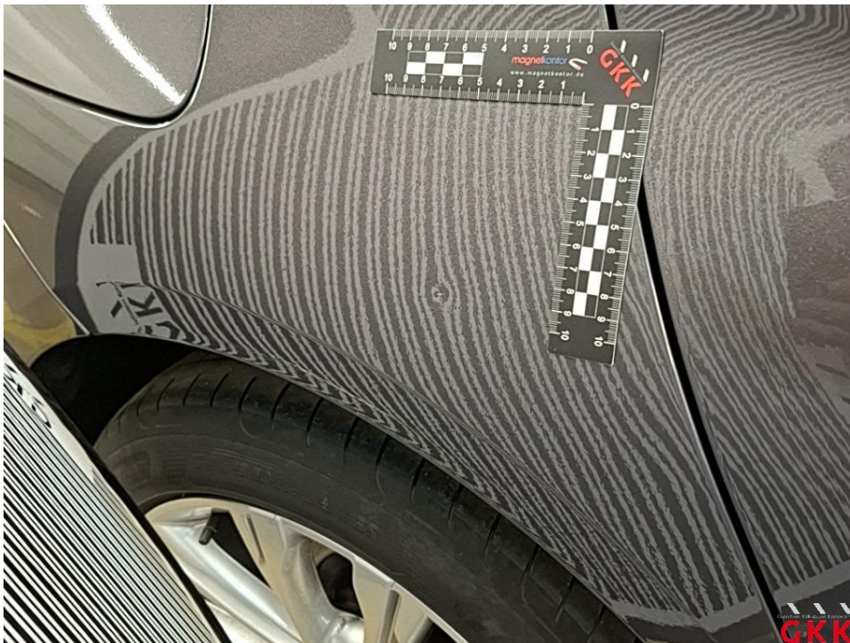
Bild 33 Seitenwand rechts, eingedellt und verkratzt (I), Smartrepair
