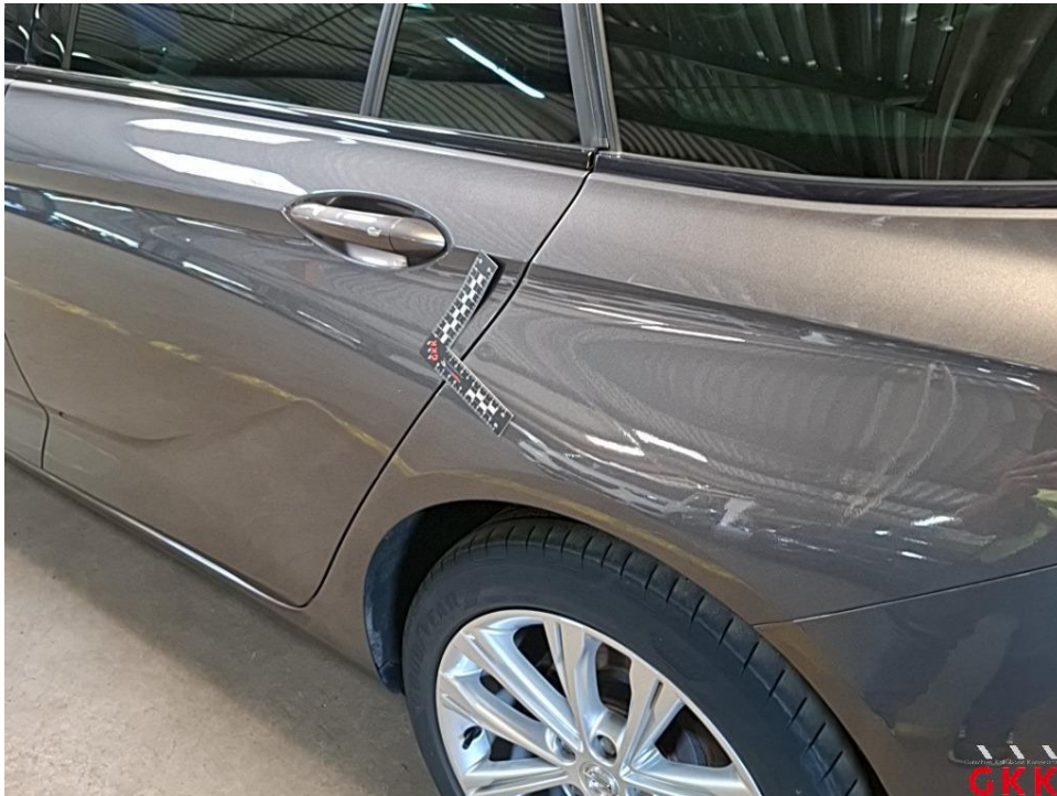
Bild 44 Seitenwand links, beschädigt, kalt drücken
