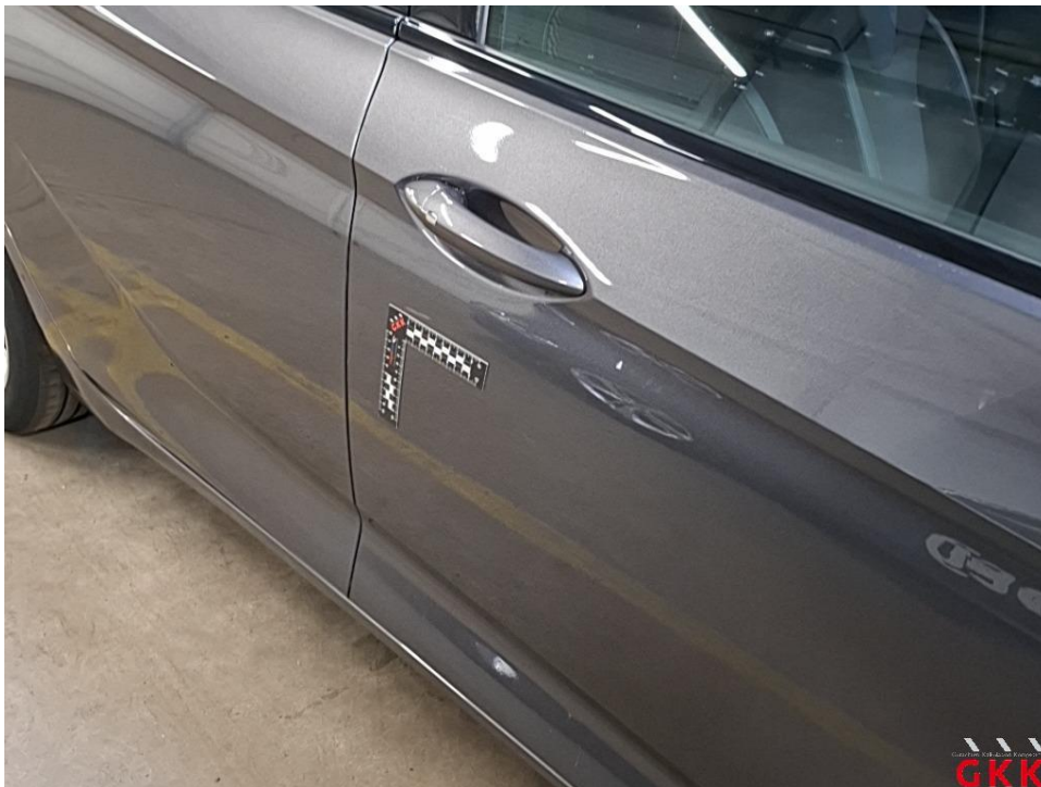
Bild 28 Tür vorne rechts, Reparaturmangel, instand setzen - lackieren
