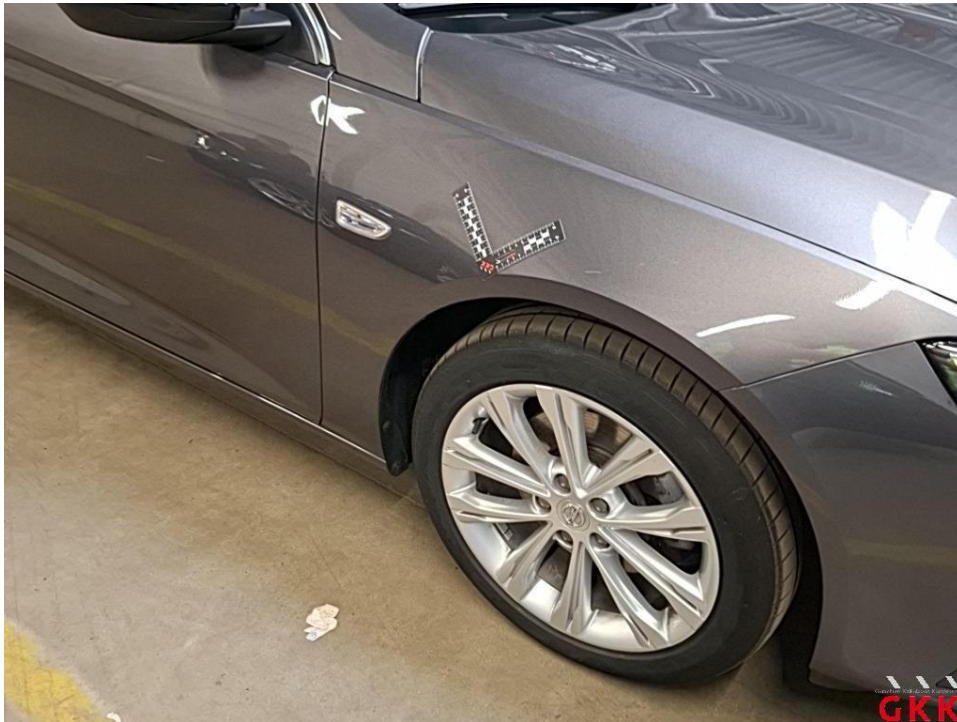
Bild 25 Kotflügel vorne rechts, beschädigt, instand setzen - lackieren
