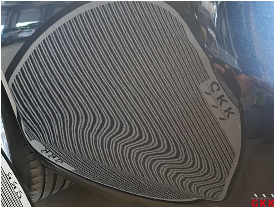
Bild 38 Stoßfänger hinten, Verkleidung -lackiert-, Reparaturmangel, lackieren
