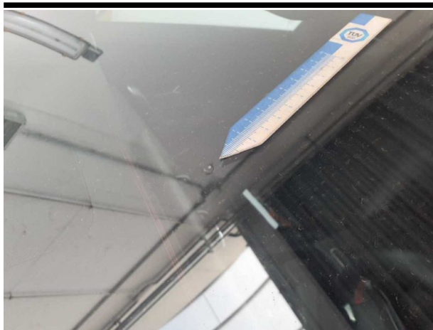
Beschädigung #7: Verglasung: Frontscheibe - Steinschlag - erneuern
