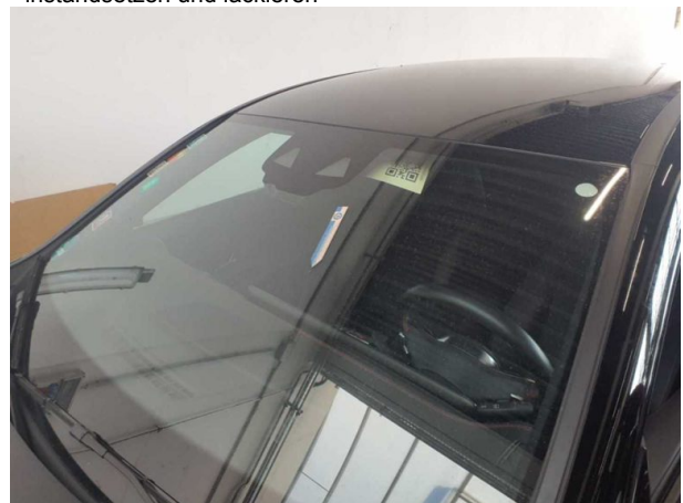
Beschädigung #7: Verglasung: Frontscheibe - Steinschlag - erneuern
