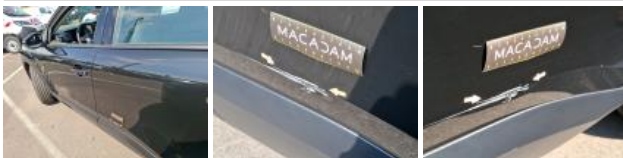
Door FL, Scratch(es), Paint
