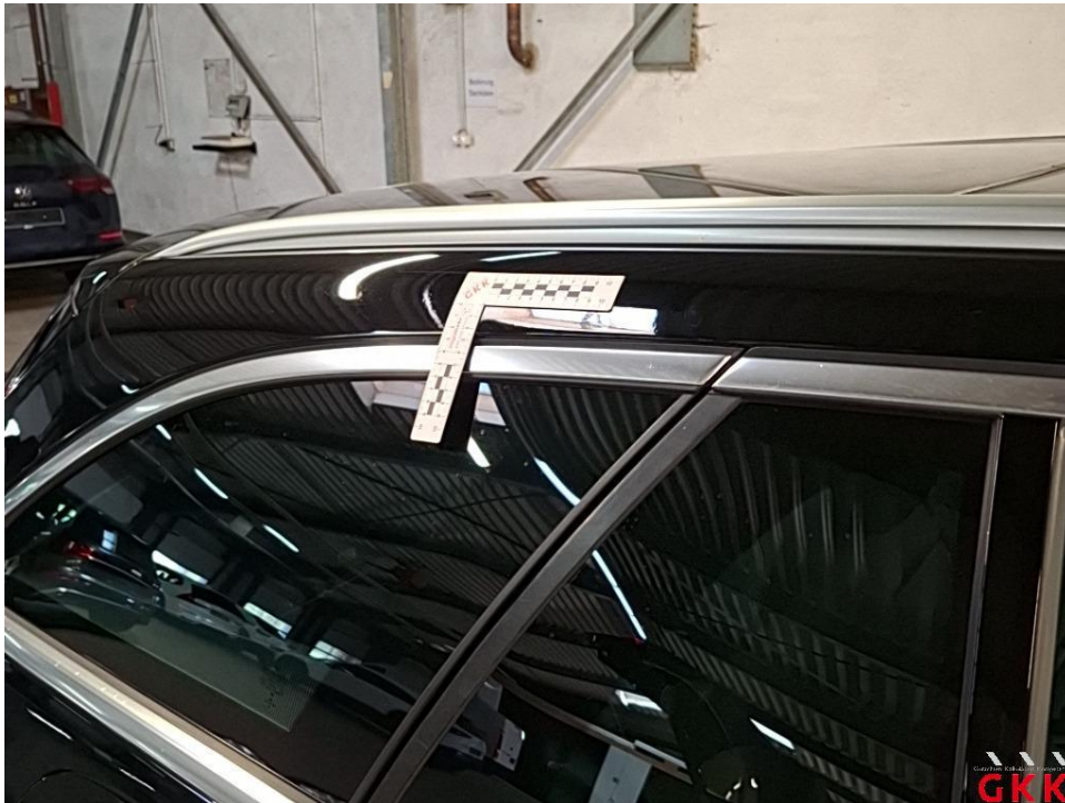
Bild 21 Dach, Holm rechts, beschädigt, Smartrepair
