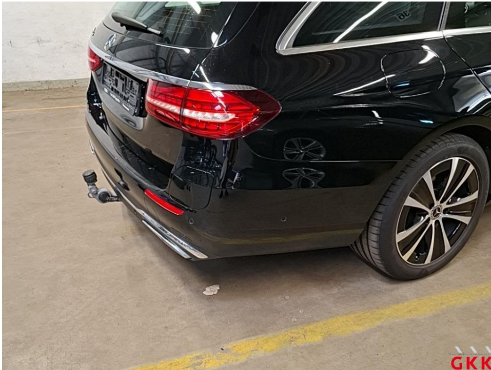
Bild 25 Stoßfänger hinten, Verkleidung -lackiert-, beschädigt, instand setzen - lackieren
