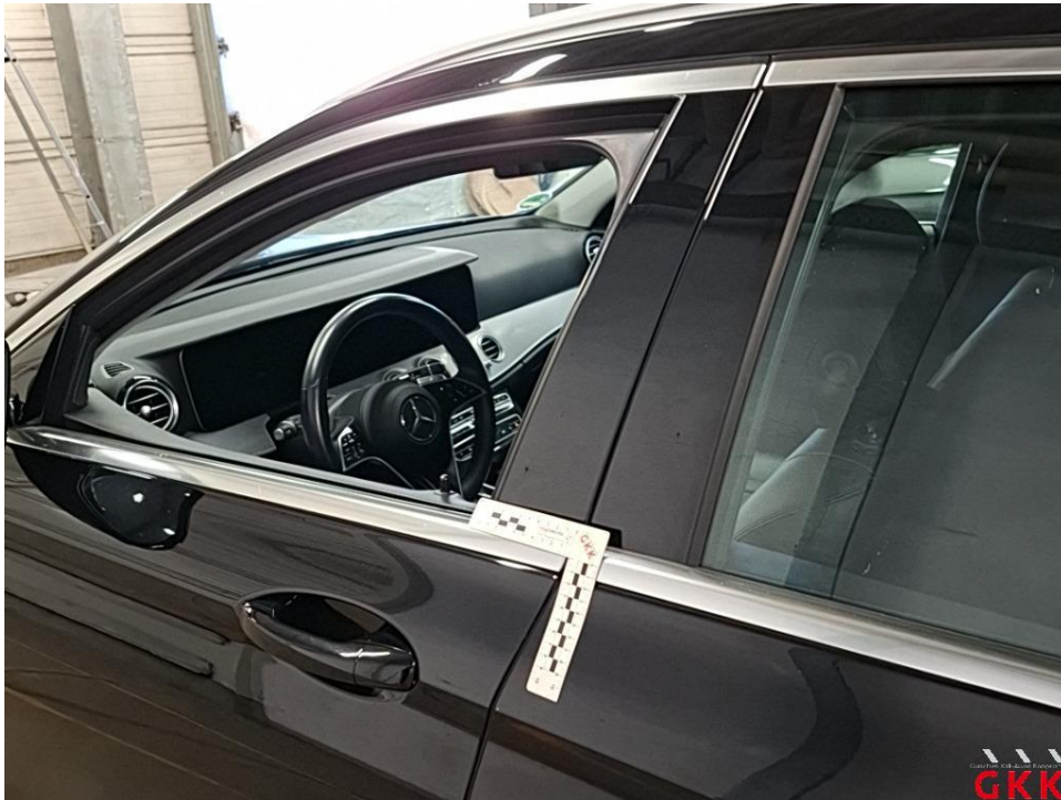
Bild 34 Tür vorne links, Blende -Fensterrahmen-, beschädigt, ersetzen
