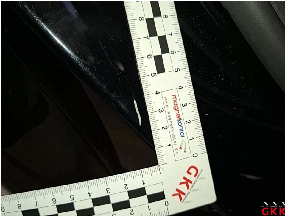
Bild 24 Tür hinten rechts, Einstieg, verkratzt, Smartrepair
