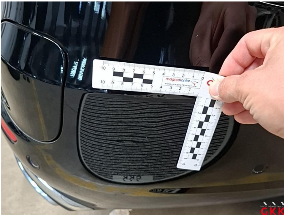
Bild 26 Stoßfänger hinten, Verkleidung -lackiert-, beschädigt, instand setzen - lackieren
