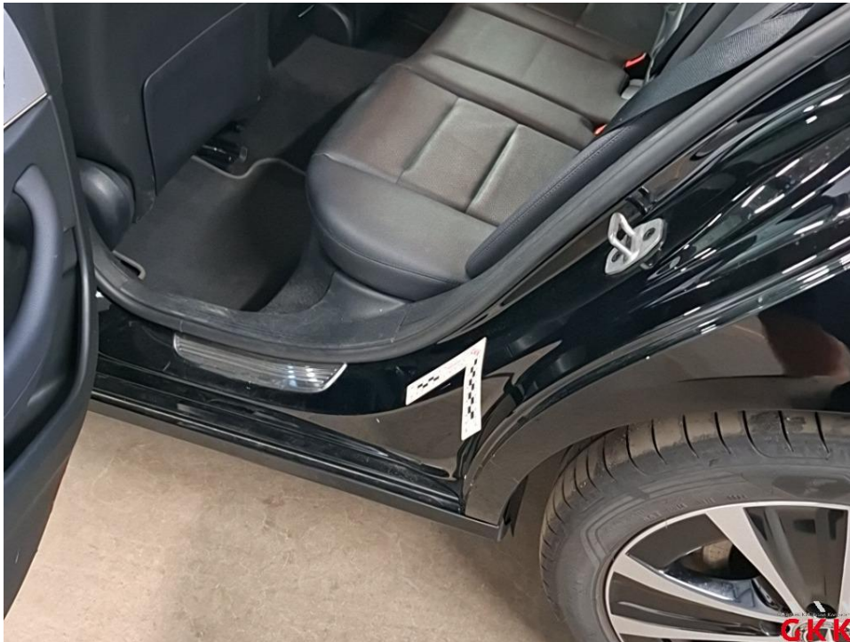
Bild 40 Tür hinten links, Einstieg, verkratzt, Smartrepair
