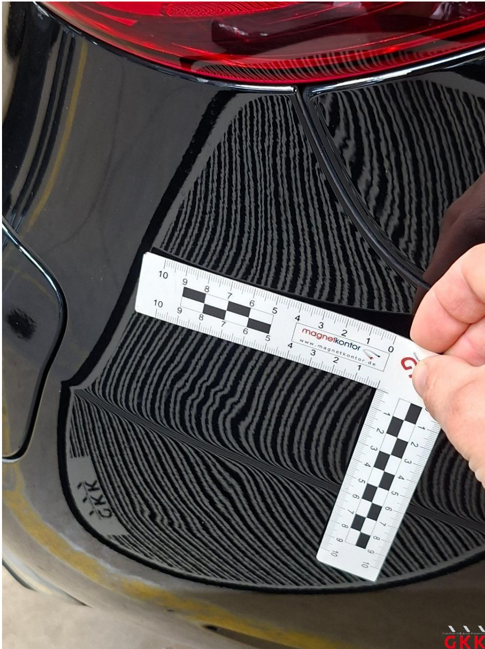
Bild 27 Stoßfänger hinten, Verkleidung -lackiert-, beschädigt, instand setzen - lackieren
