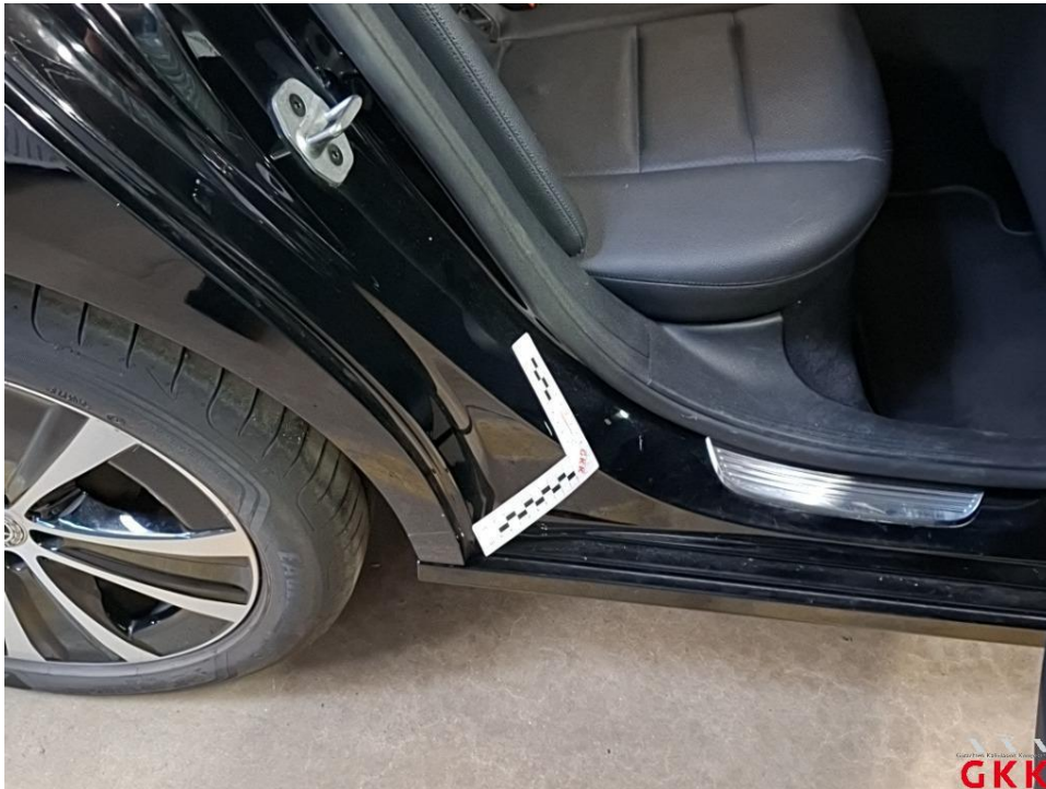
Bild 23 Tür hinten rechts, Einstieg, verkratzt, Smartrepair
