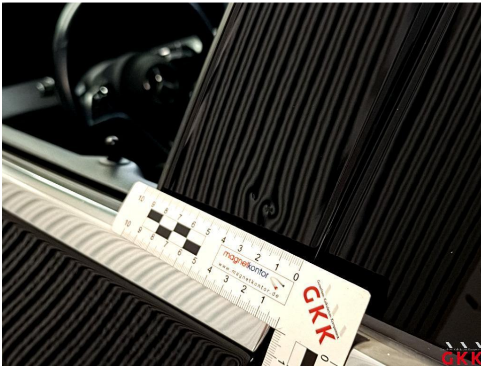
Bild 35 Tür vorne links, Blende -Fensterrahmen-, beschädigt, ersetzen
