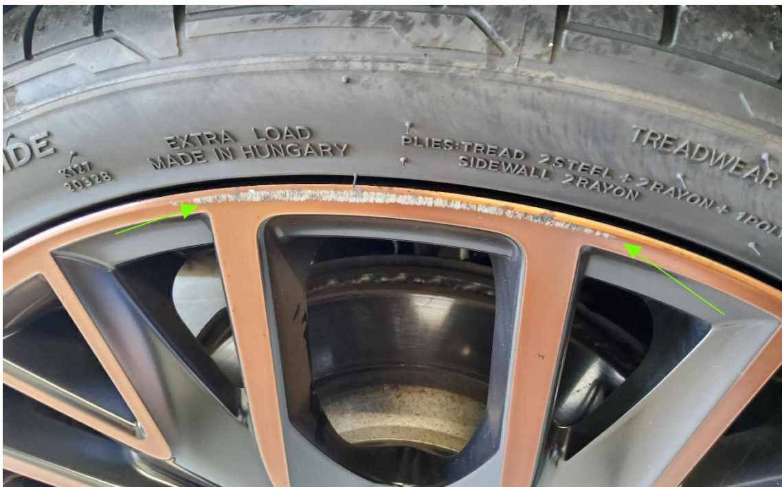
Bild 24 : Leichtmetallfelge hinten rechts zerkratzt
