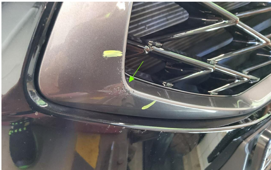
Bild 15 : Kühlergrill Lackierung zerkratzt
