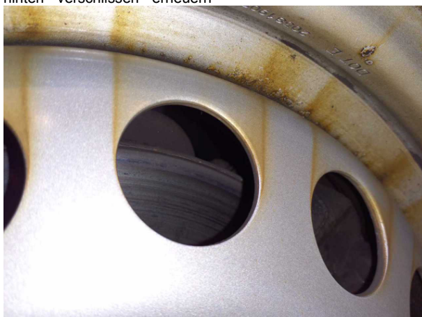
Beschädigung 4: Bremsanlage: Bremsscheiben und Beläge vor... verschlissen - erneuern
