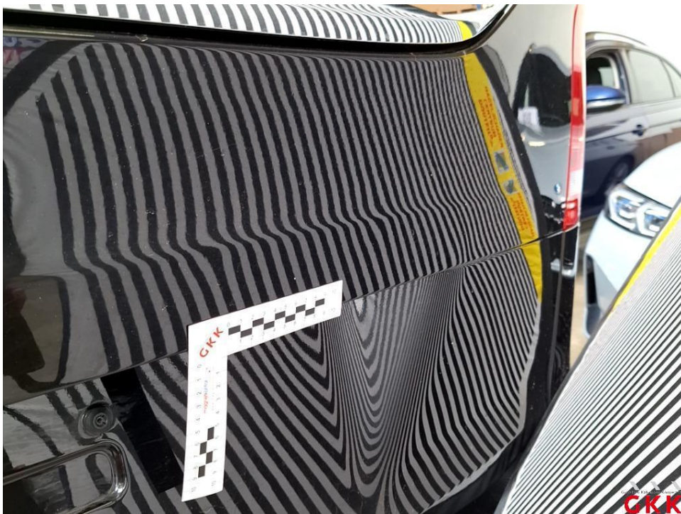
Bild 28 Heckklappe, beschädigt, instand setzen - lackieren
