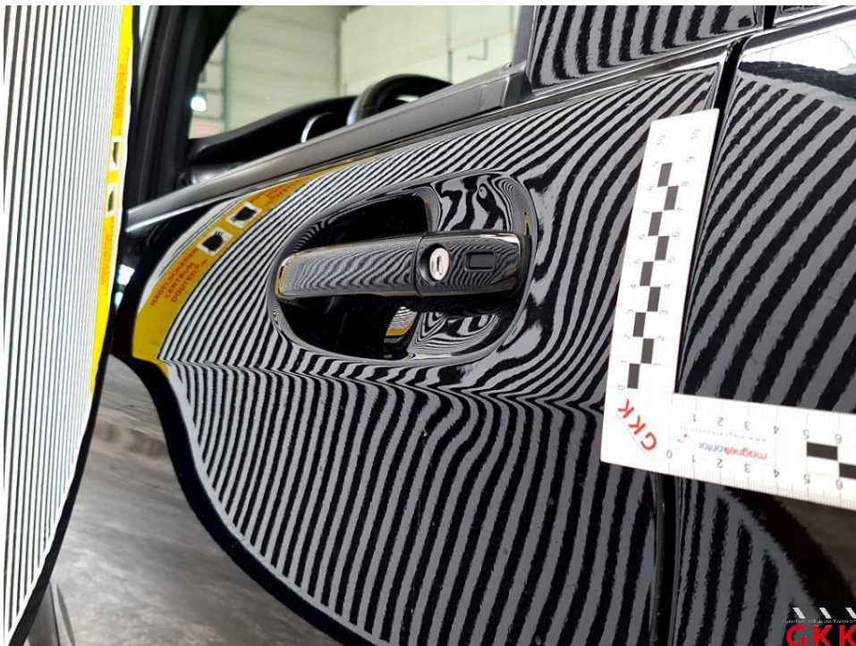
Bild 34 Tür vorne links, beschädigt, instand setzen - lackieren
