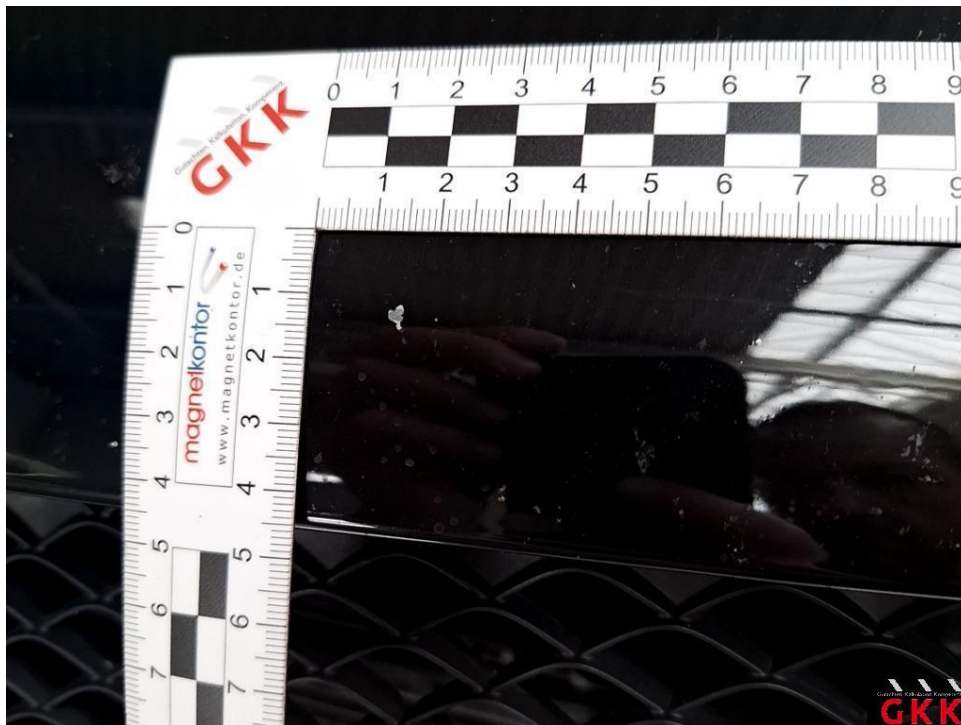
Bild 18 Motorhaube, Steinschlag, Smartrepair
