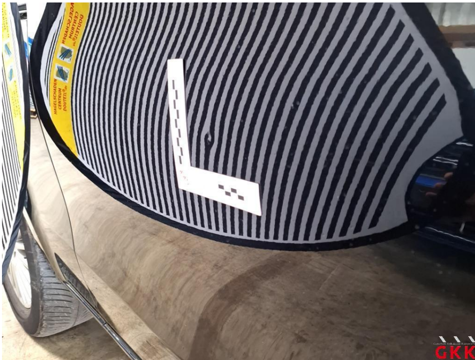
Bild 23 Schiebetür rechts, 4 bis 10 Dellen / Bauteil, kalt drücken
