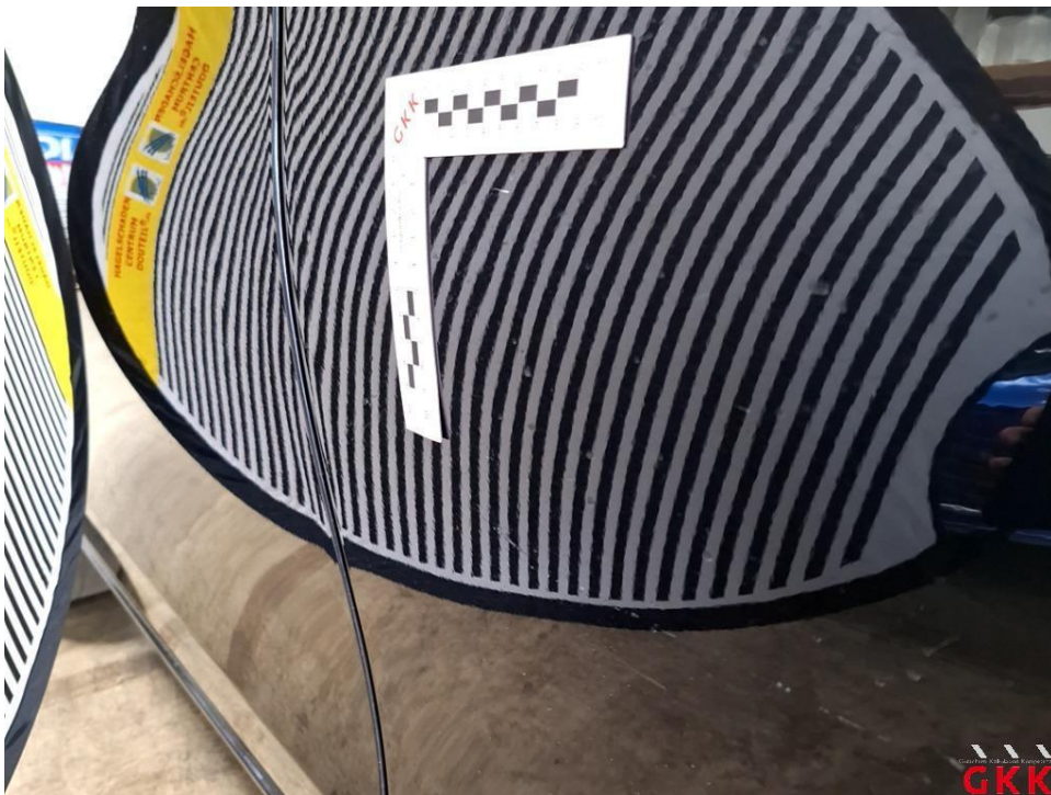
Bild 22 Tür vorne rechts, 4 bis 10 Dellen / Bauteil, kalt drücken
