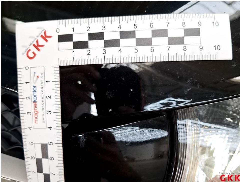
Bild 17 Motorhaube, Steinschlag, Smartrepair
