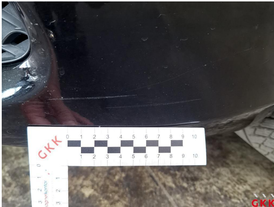
Bild 19 Stoßfänger vorne, Verkleidung -lackiert-, verkratzt, lackieren
