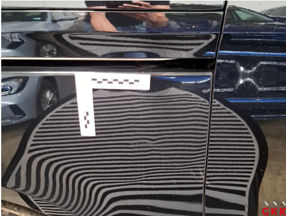
Bild 25 Seitenwand rechts, unterhalb, beschädigt, instand setzen - lackieren
