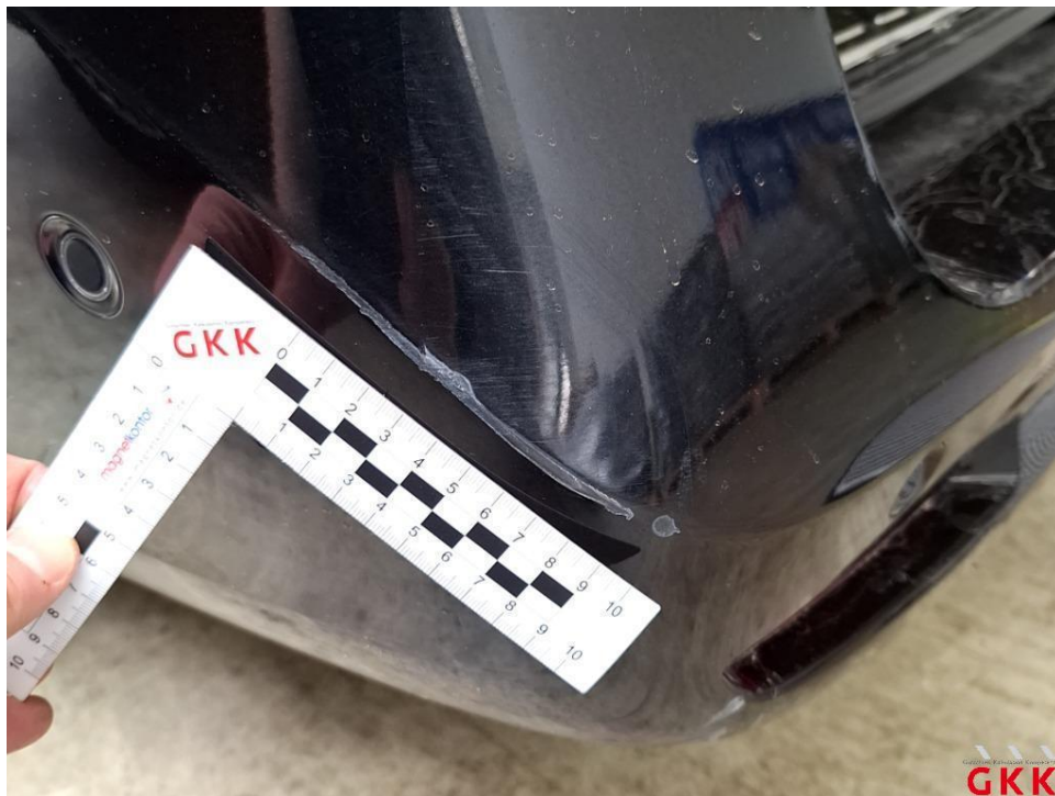
Bild 30 Stoßfänger hinten, Verkleidung -lackiert-, beschädigt, instand setzen - lackieren
