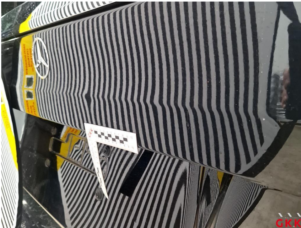
Bild 27 Heckklappe, beschädigt, instand setzen - lackieren
