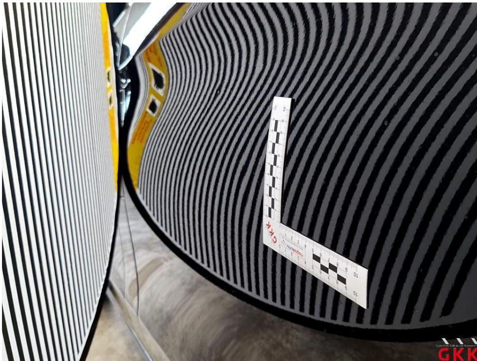
Bild 33 Seitenwand links, beschädigt, instand setzen - lackieren
