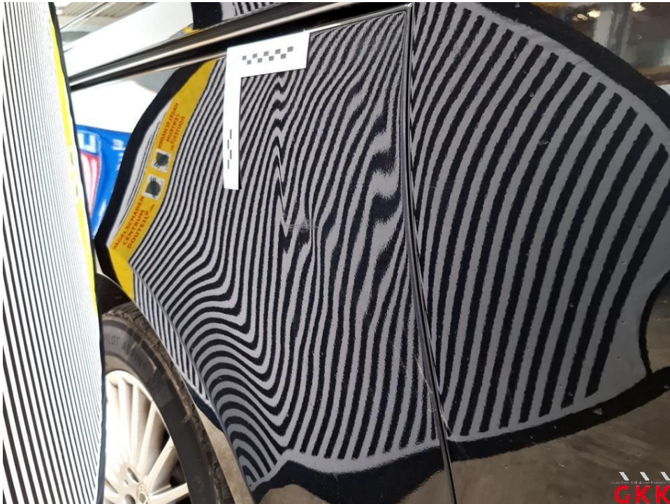
Bild 26 Seitenwand rechts, unterhalb, beschädigt, instand setzen - lackieren
