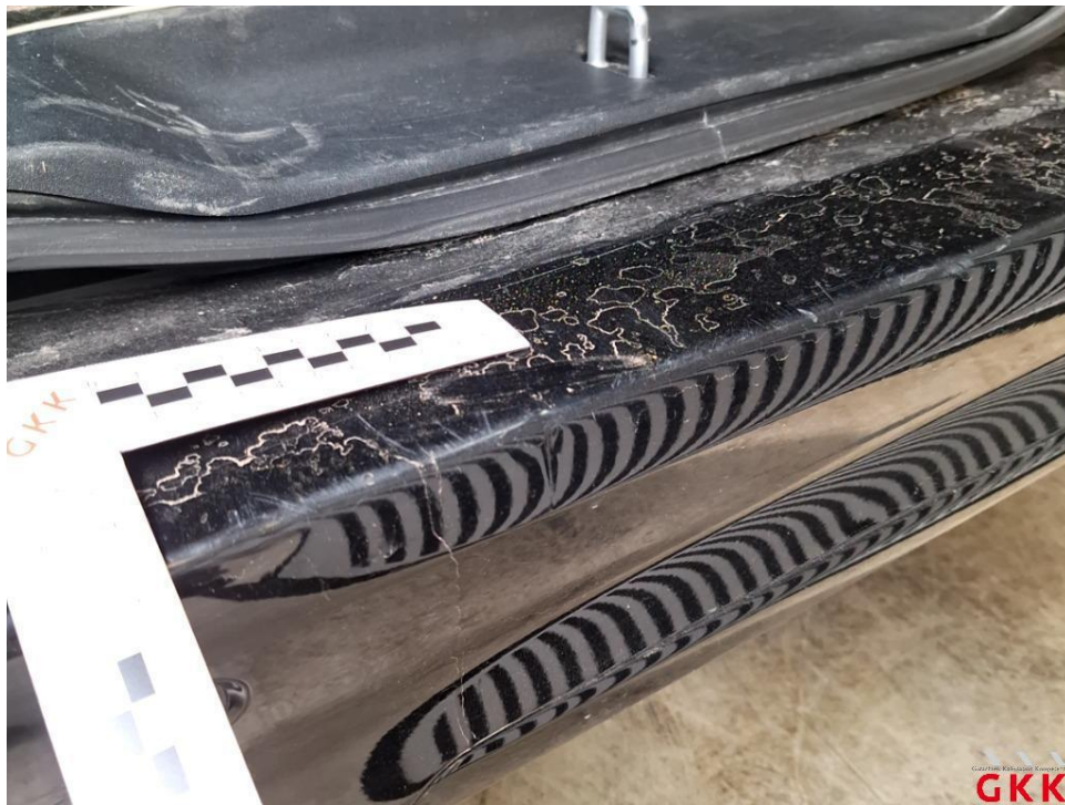
Bild 29 Stoßfänger hinten, Verkleidung -lackiert-, beschädigt, instand setzen - lackieren
