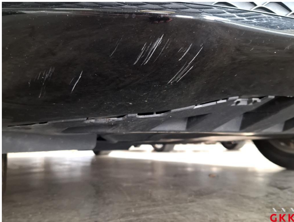
Bild 20 Stoßfänger vorne, Verkleidung -lackiert-, verkratzt, lackieren
