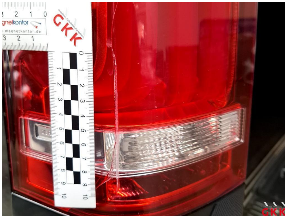
Bild 31 Rückleuchte links, außen, verkratzt, ersetzen
