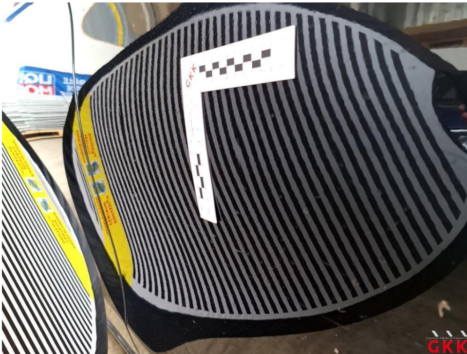
Bild 21 Tür vorne rechts, 4 bis 10 Dellen / Bauteil, kalt drücken
