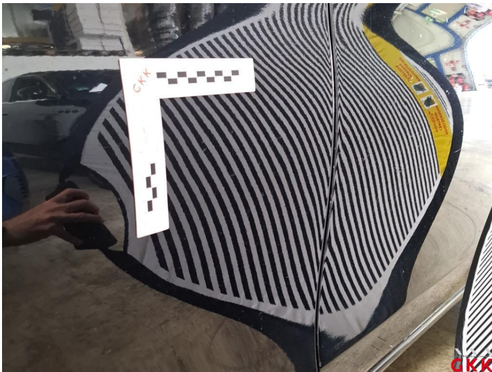
Bild 24 Schiebetür rechts, 4 bis 10 Dellen / Bauteil, kalt drücken
