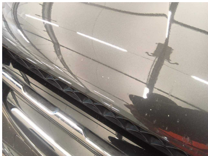
Damage 9: Bonnet: Bonnet (Übermäßige Steinschläge) - Stone chips - Paint
