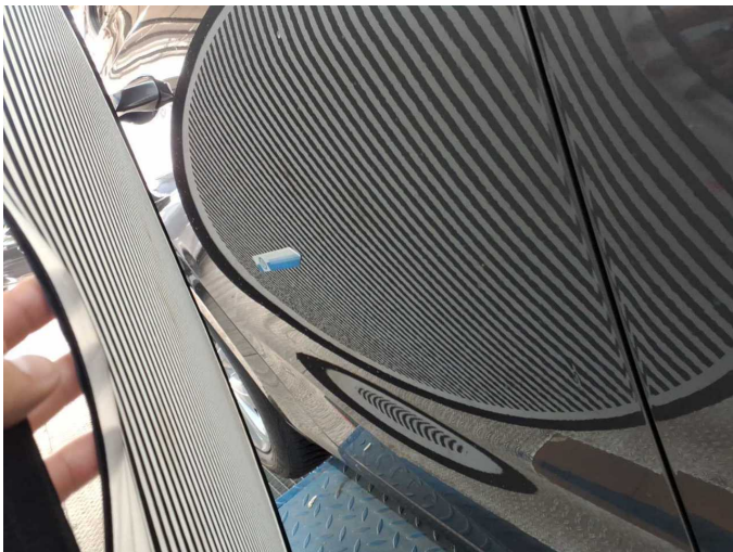
Damage 1: Door - rear right side: Door (Ein leichter knick zusehen) - dent(s) - Smooth repair work
