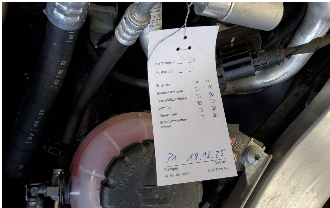
Bild 15 : T- Servicenachweis nicht vorhanden, letzter Service von Ölzettel übernommen
