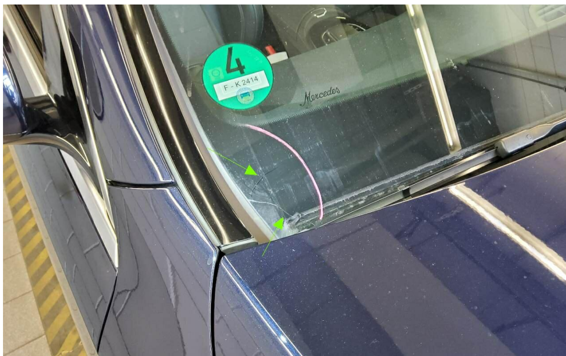
Bild 16 : T- Frontscheibe gerissen
