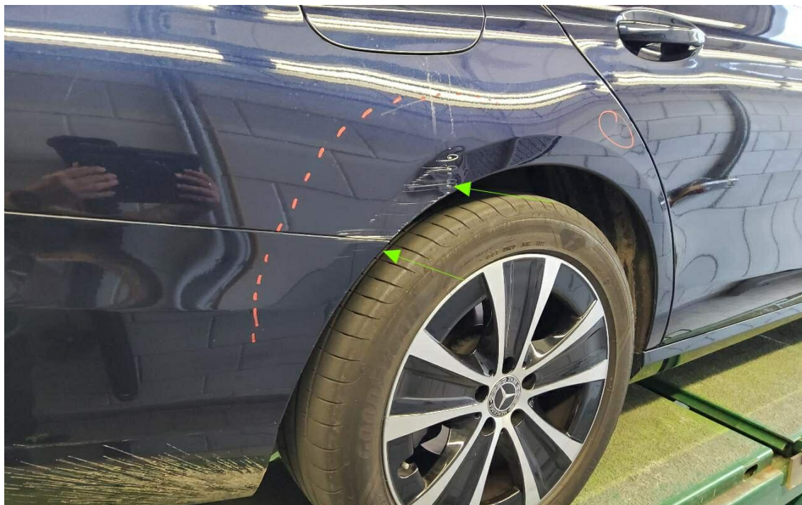
Bild 27 : Streifschaden hinten rechts
