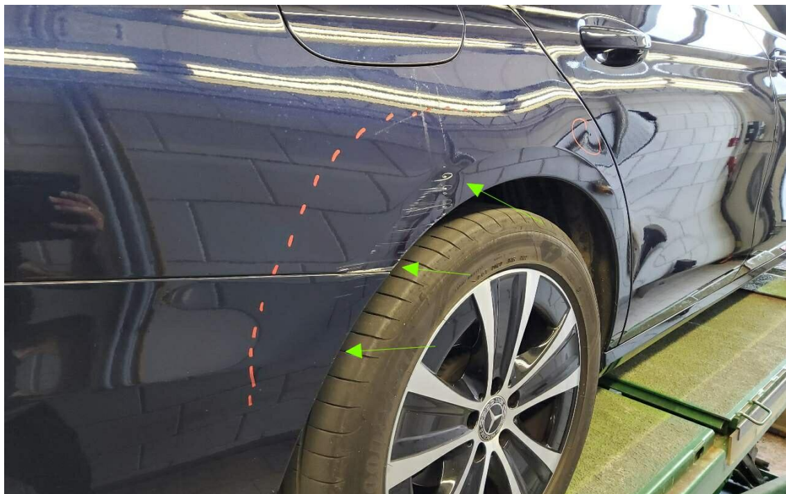
Bild 25 : Streifschaden hinten rechts
