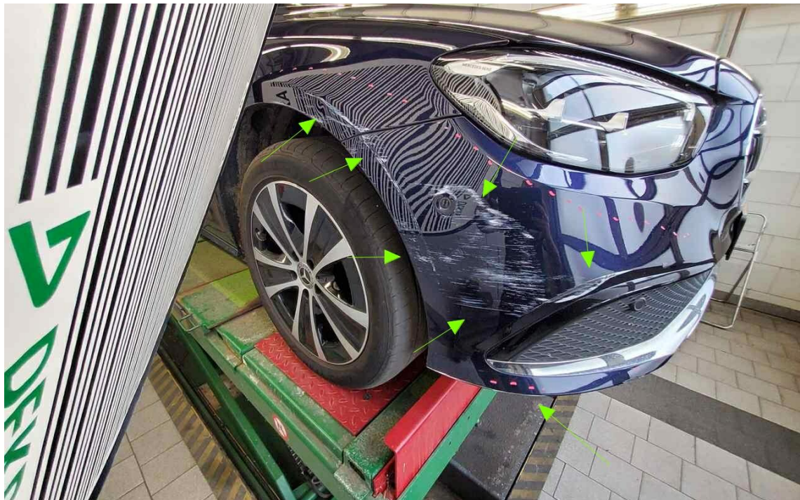
Bild 19 : Streifschaden vorne rechts
