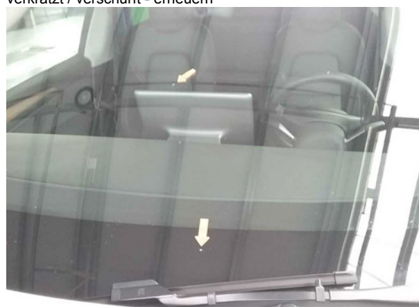
Beschädigung #3: Verglasung: Frontscheibe (mit Rissbildung) - Steinschlag - erneuern
