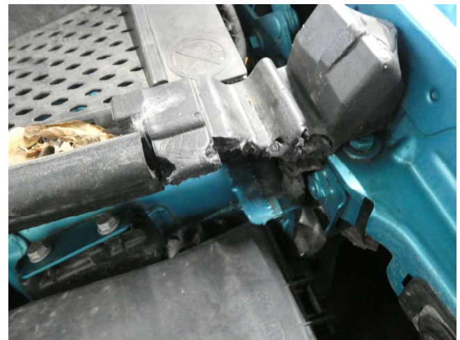
Motorraum - Nagetierschaden - inst. (Kostenausweitung)
