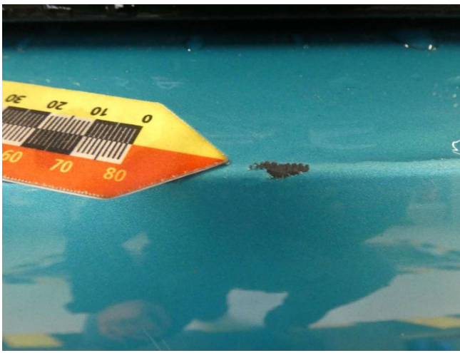
Stoßfänger hinten - zerkratzt - smart Repair
