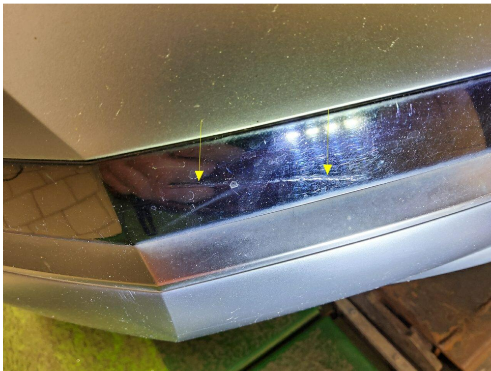
Bild 9 : Zierleiste Stoßfänger hinten verschrammt
