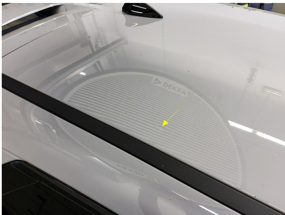
Bild 14 : Hageltypische Eindellungen in der Dachhaut
