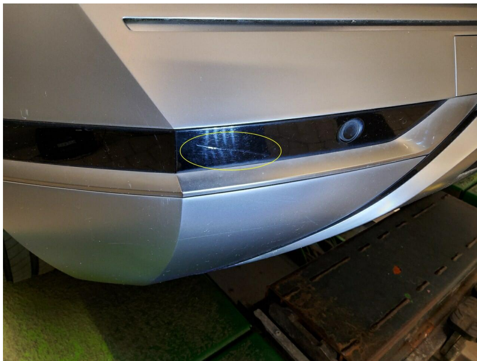
Bild 8 : Zierleiste Stoßfänger hinten verschrammt
