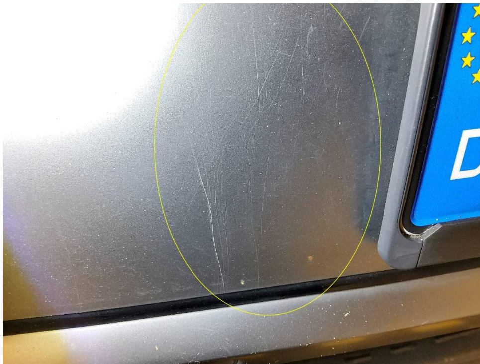
Bild 10 : Mittelblende Stoßfänger hinten zerkratzt
